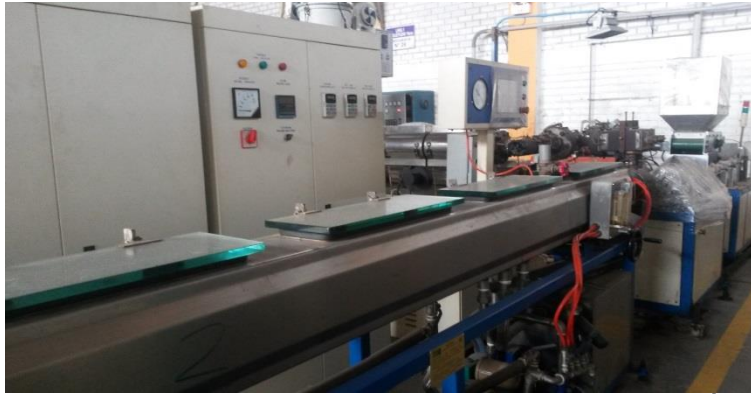
Figura 20. Extrusora de Línea de Riego por Goteo. Fotografía del Área de Producción. Información digerida de la Empresa Cardsilplast S.A.C. Derecho de autor 2017 por CARDSILPLAST S.A.C- http://cardsilplast.com.pe . Reimpreso con permiso.
