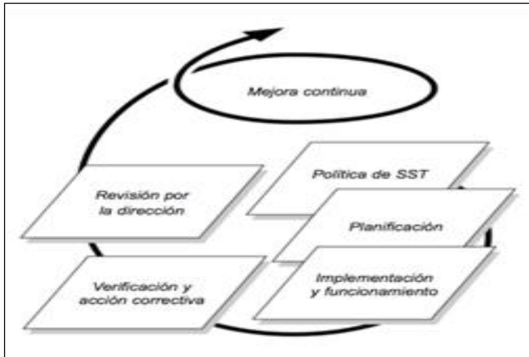
Figura 4. Modelo del Sistema de Gestión de Seguridad y Salud En El Trabajo. Fundamentos e interpretación del sistema de gestión de seguridad y salud ocupacional OHSAS 18001:2007. Derecho de autor 2016 por Corporación LAmericana de Desarrollo.
