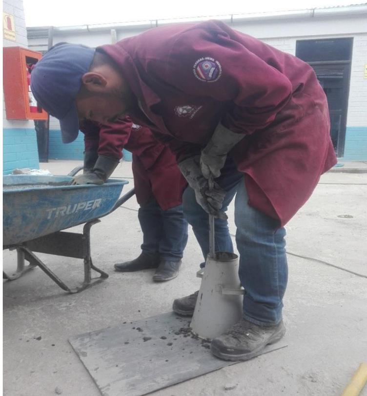
**Fotografía 18.** *Ensayo de asentamiento “slump” en el concreto.*
