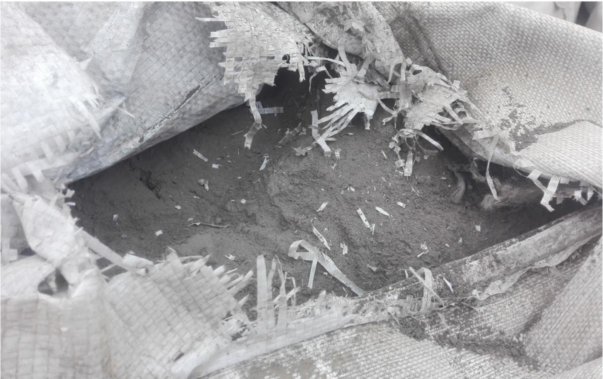
**Fotografía 4.** Ceniza volante "fly ash" recojida de la termoeléctrica de Ilo21.
