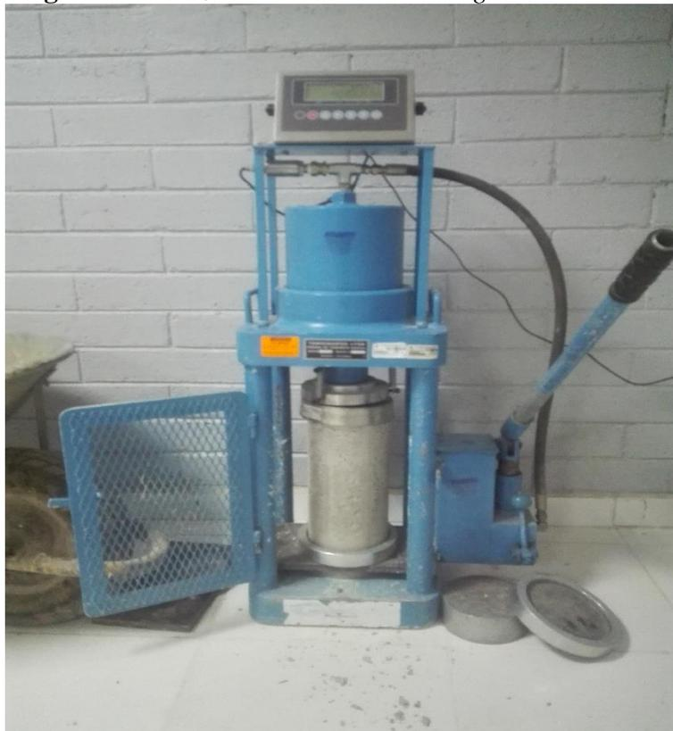
**Fotografía 28.** *Prensa hidráulica de concreto.*
