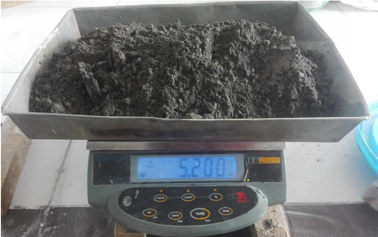
**Fotografía 11.** *Ceniza volante “fly ash” siendo pesada.*
