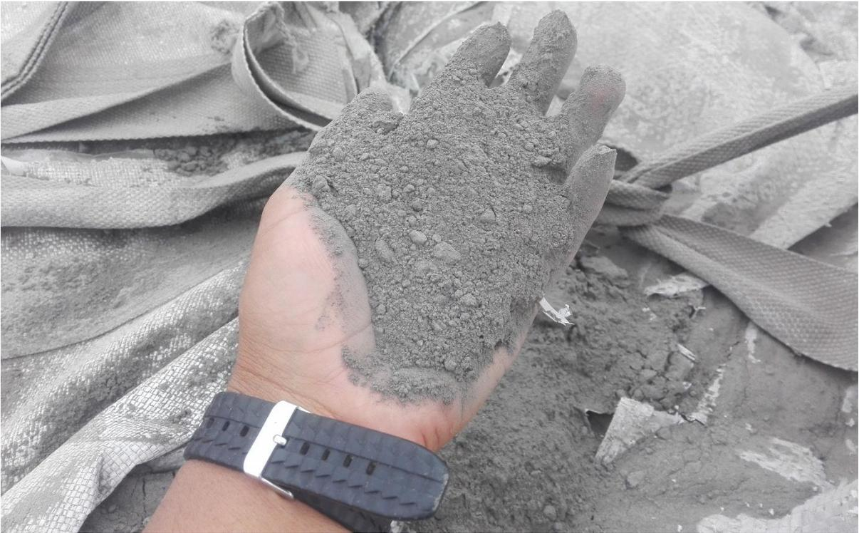
**Fotografía 5.** *Mostrando la ceniza volante “fly ash” de la termoeléctrica de Ilo21.*
