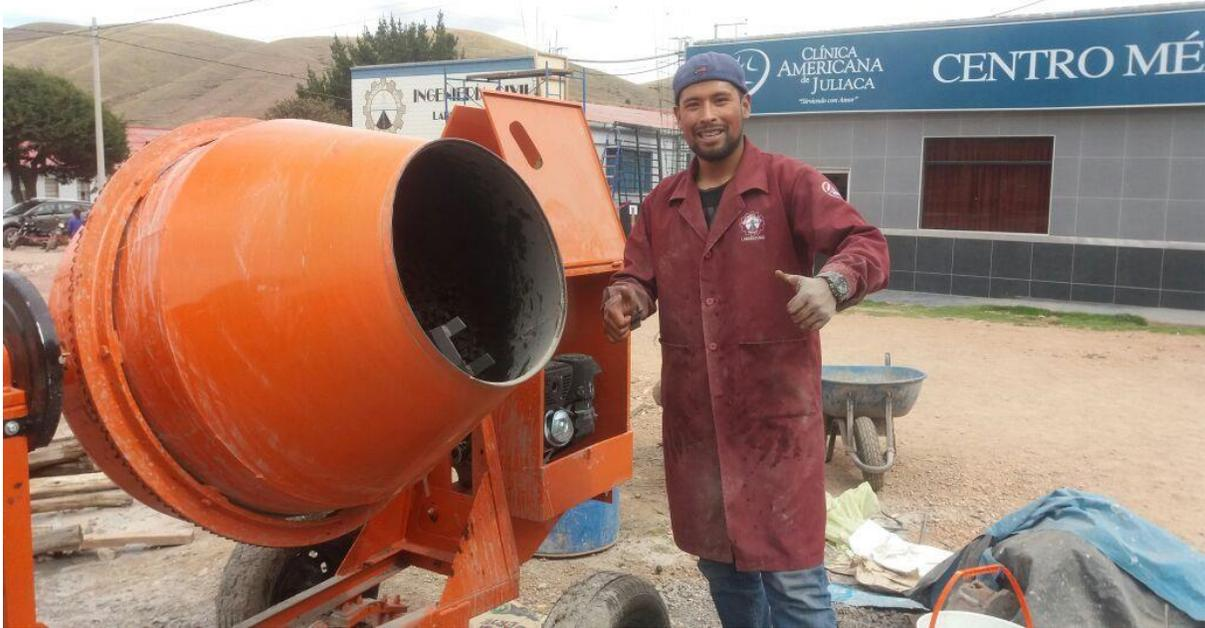
**Fotografía 15.** Mezcladora de concreto tipo trompo utilizada para la realización de muestras.
