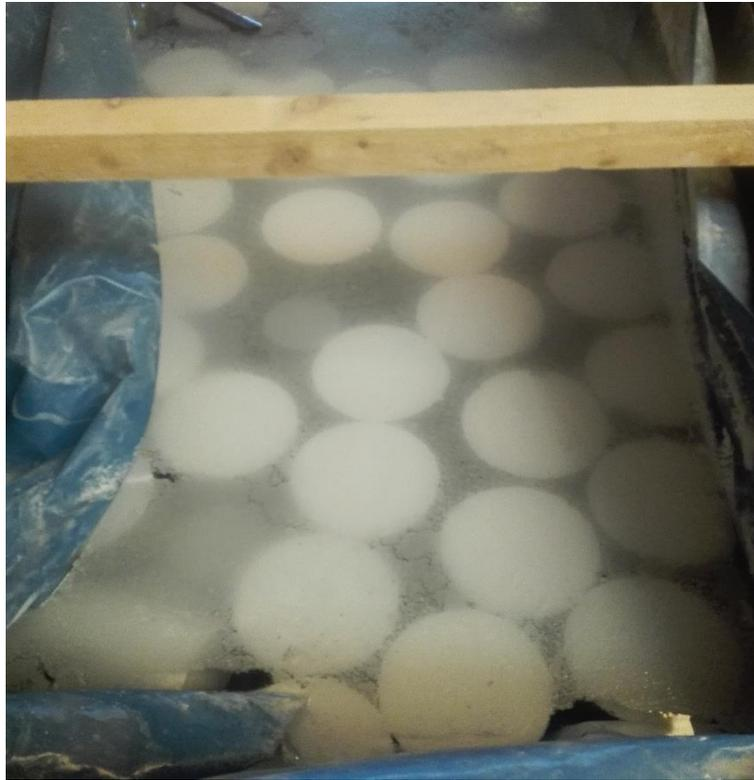
**Fotografía 27.** *Poza de curado de los testigos de concreto.*
