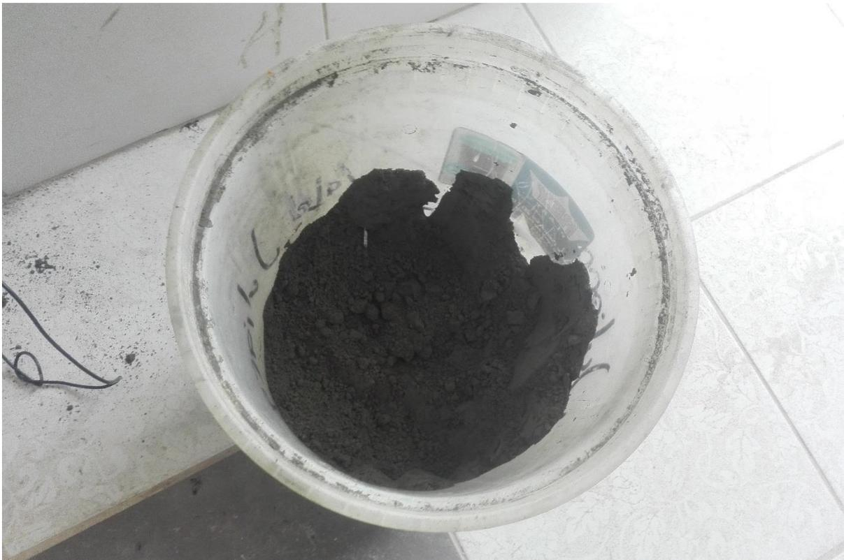
**Fotografía 12.** *Ceniza volante “fly ash” traída desde la central termoeléctrica de Ilo21.*
