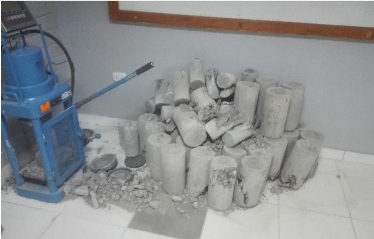
**Fotografía 29.** *Muestras de concreto ensayadas.*
