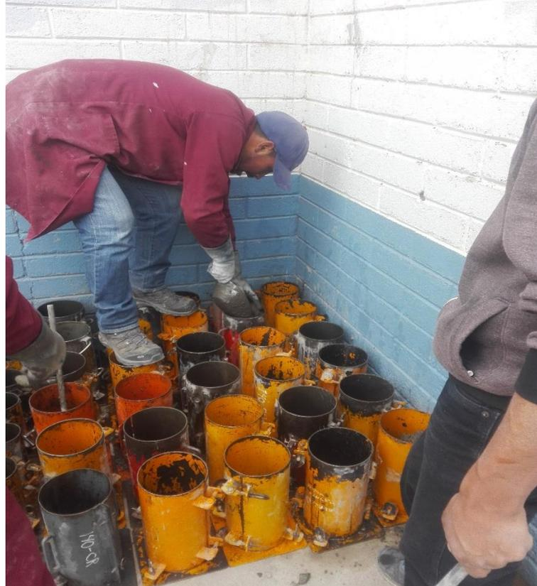
**Fotografía 20.** *Colocación del concreto en los moldes.*
