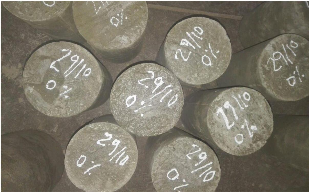
**Fotografía 25.** Testigos de concreto después de ser desmoldados.
