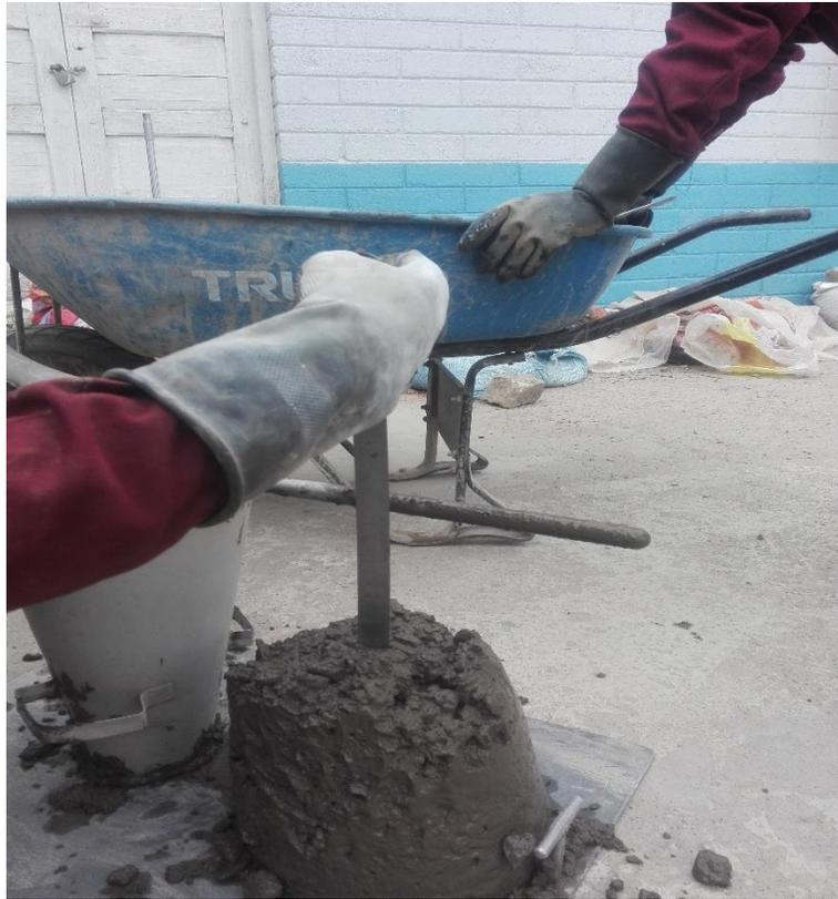
**Fotografía 19.** *Medición del asentamiento “slump” en el concreto.*
