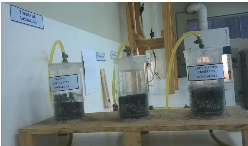
Figura 44. Torres de Lecho fijo para la adsorción del H_2S mediante C.A.C y Lodo Residual
