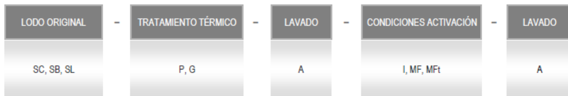
Figura 9. Proceso de la obtención del Carbón Activado a partir de lodos de una PTAR
