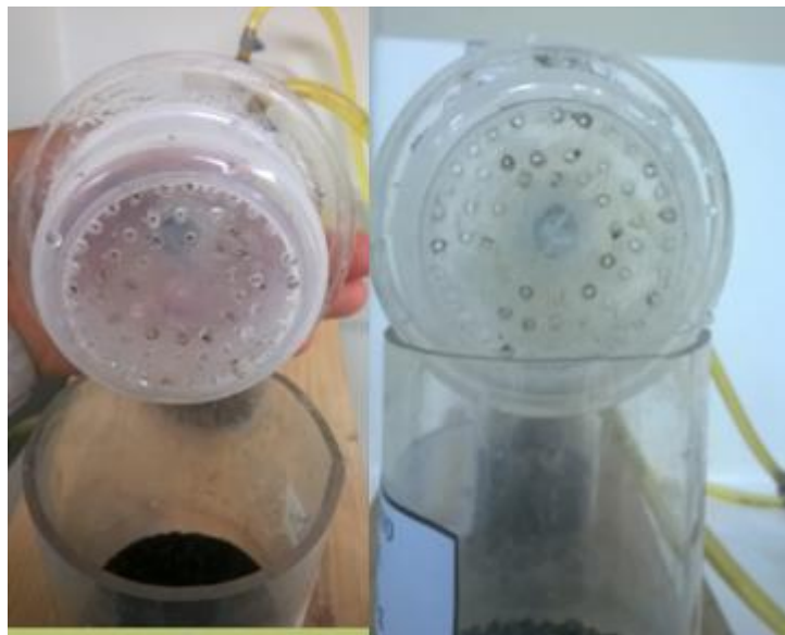
Figura 41. Tapones de las torres de lecho fijo
