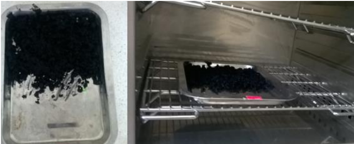
Figura 56. El secado del material precursor lavado con HCl y en la estufa
