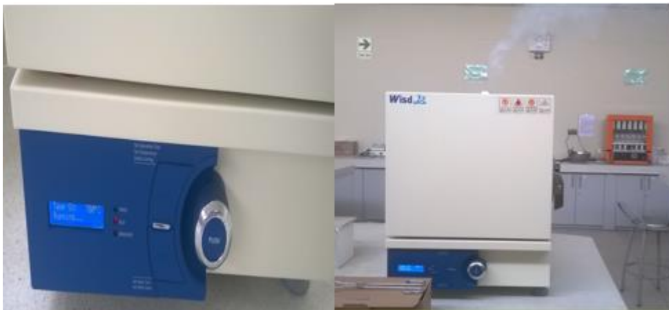
Figura 54. Equipo para la pirolización de los carbones activos en regeneración, mufla.
