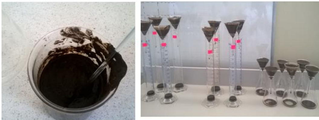
Figura 49. Impregnación y filtración del Agente Activante
