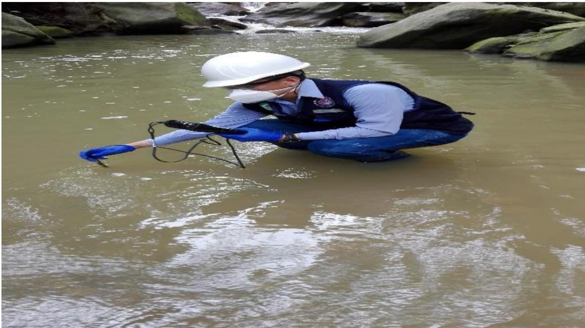
Medición de los parámetros de campo *in situ* con el Multiparámetro debidamente calibrado.
