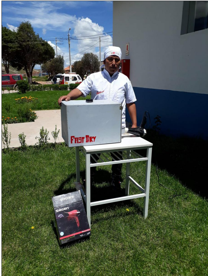
Secadora de bandeja tipo gabinete construido y terminado.
