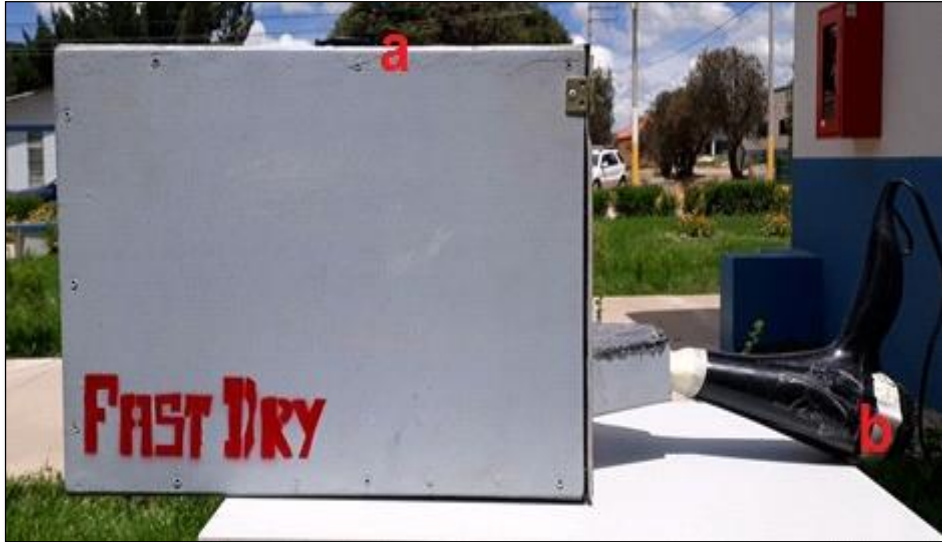
Figura 15. Vista lateral del secador tipo bandeja. Nota: los puntos a y b es donde se colocaron los sensores de temperatura.
