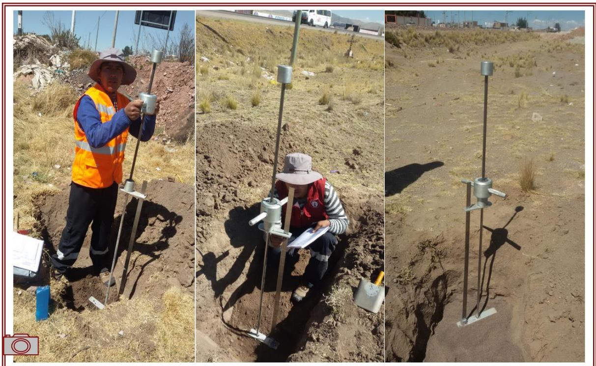
Fotografía 2. Ensayo de Penetración Dinámica de Cono con tres pruebas por calicatas.
