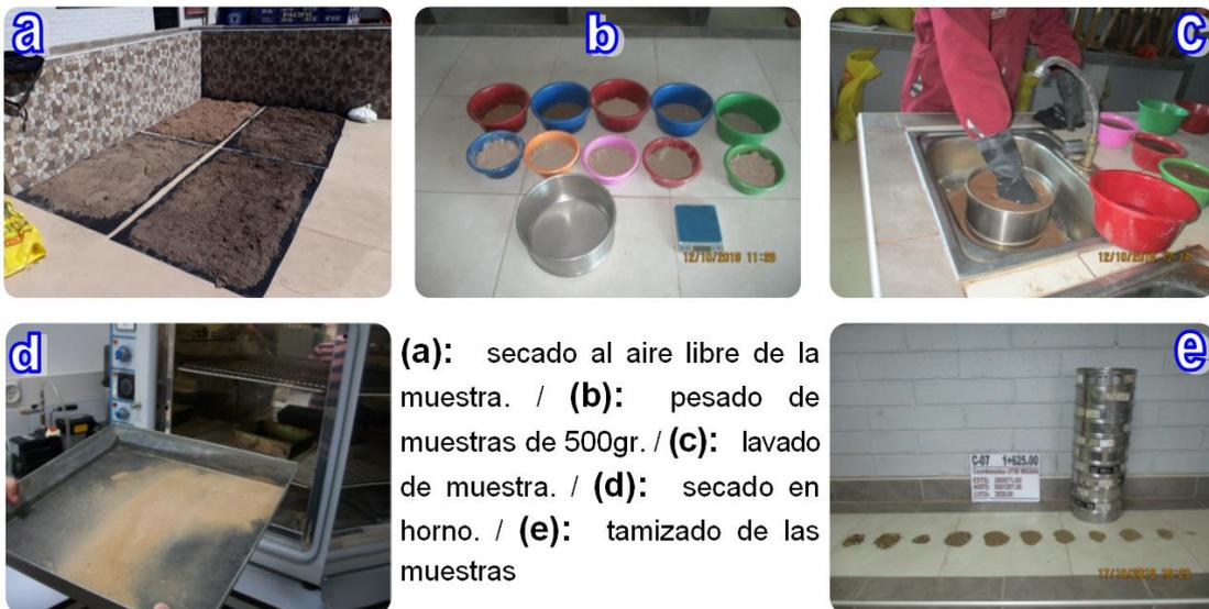
**Figura 48.** Procedimiento para ensayo de granulometría del suelo mediante tamizado
