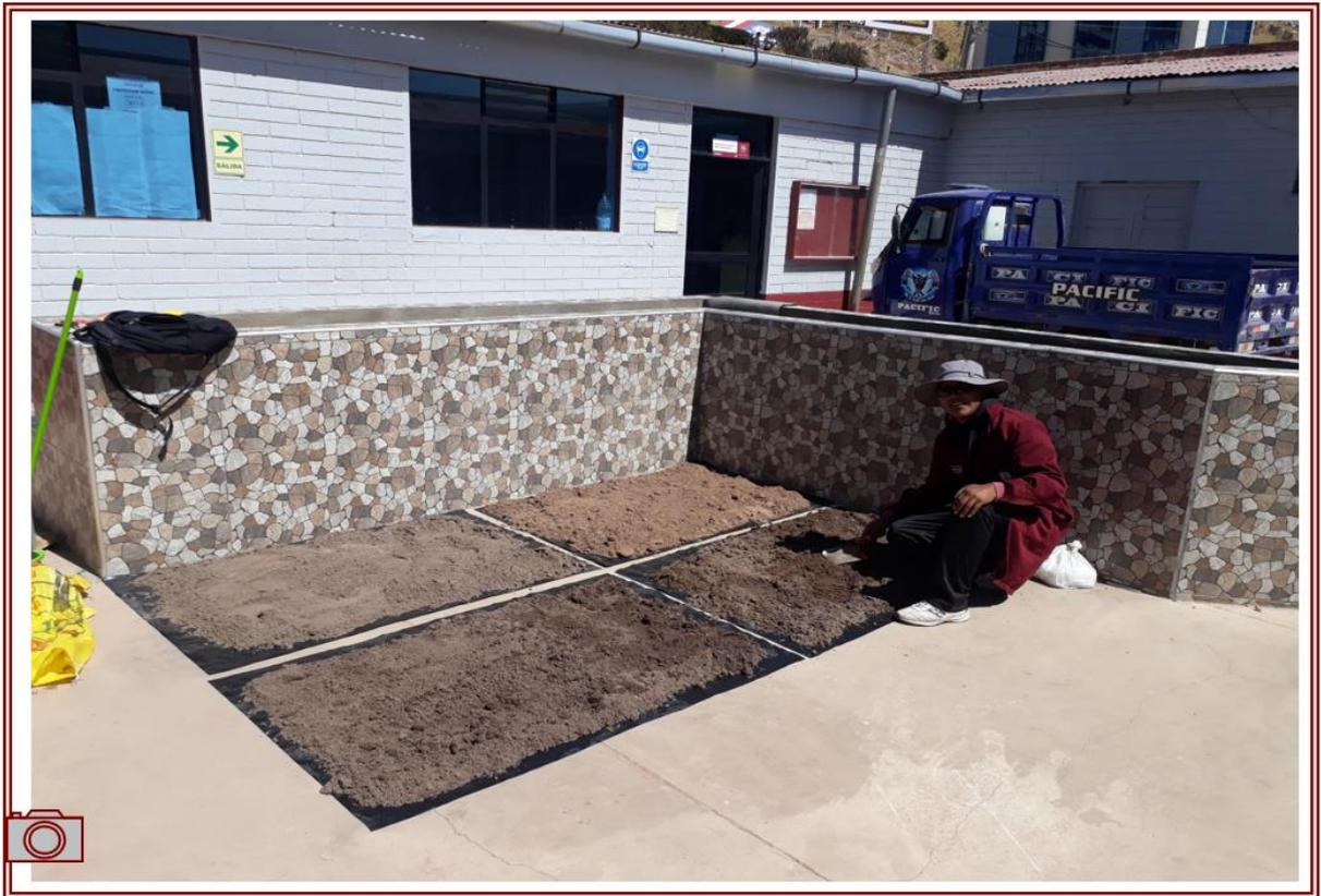
**Fotografía 9.** Secado de muestras al aire libre, para ensayo de CBR remoldeado.
