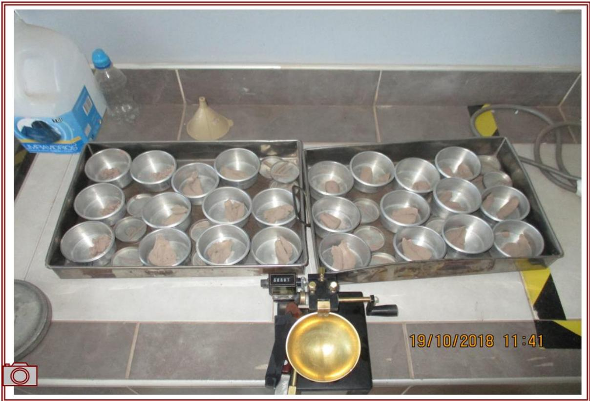
**Fotografía 19.** Ensayo de límites de consistencia "Límite Líquido" y "Límite Plástico".
