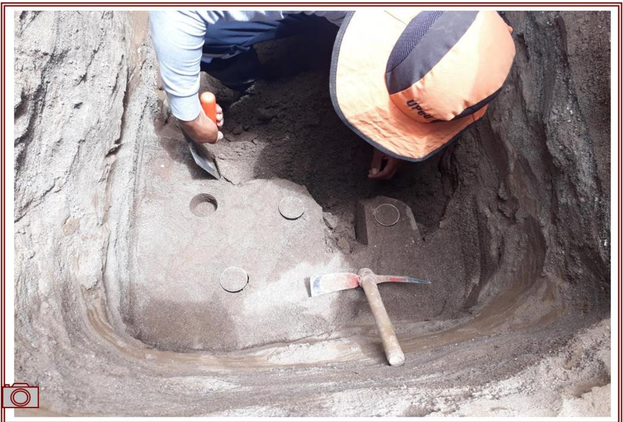
**Fotografía 10.** Ensayo de densidad natural del suelo aplicado en arenas in situ.
