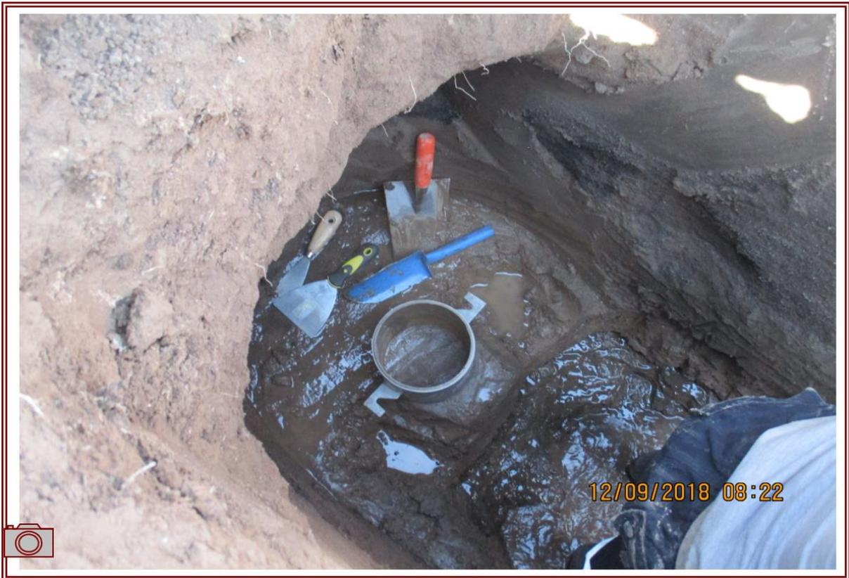
**Fotografía 5.** Extracción de muestras inalteradas en moldes de CBR bajo presencia del N.F.
