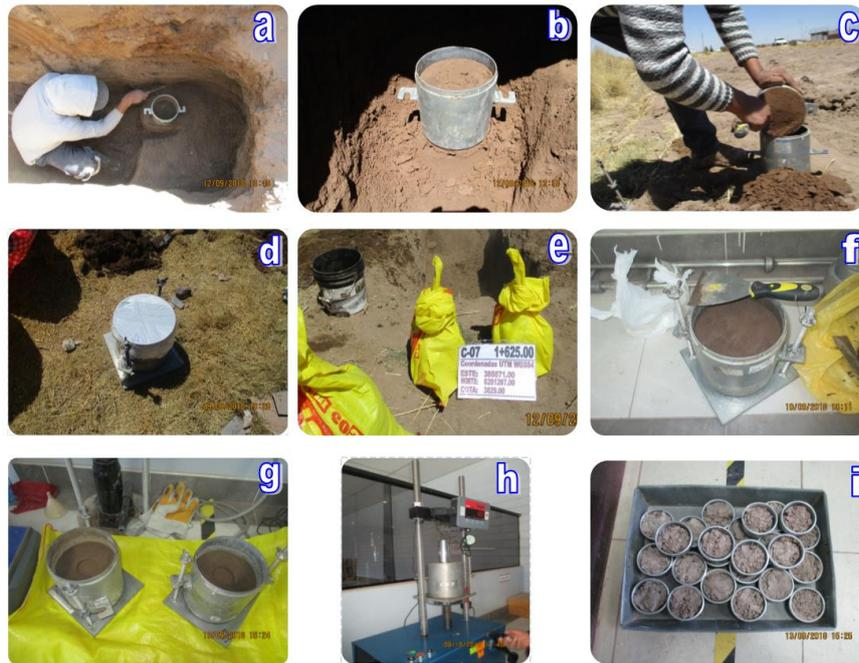
**Figura 51.** Procedimiento para el ensayo de CBR sobre muestra inalterada
