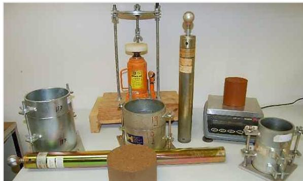
**Figura 17.** Equipamiento para el ensayo de Capacidad de Soporte California
