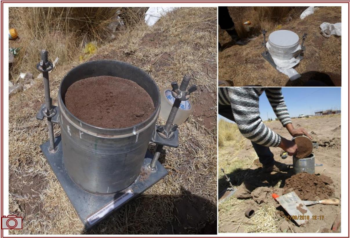
**Fotografía 11.** Enrasado y embalado de las muestras inalteradas para ensayo de CBR.
