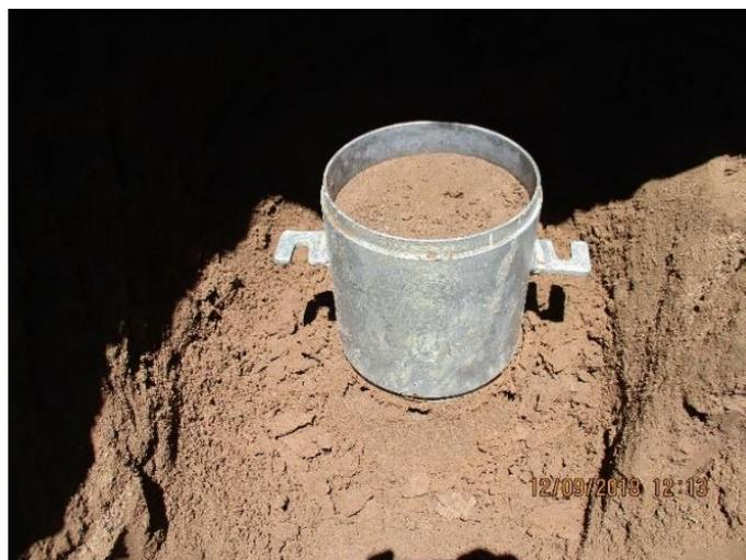
**Figura 16.** Extracción de muestras inalteradas, haciendo uso de moldes CBR
