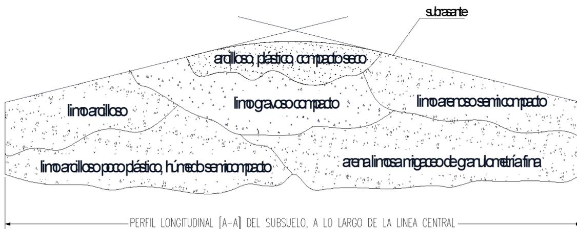
**Figura 9.** Representación del nivel de la subrasante en suelos de fundación.
