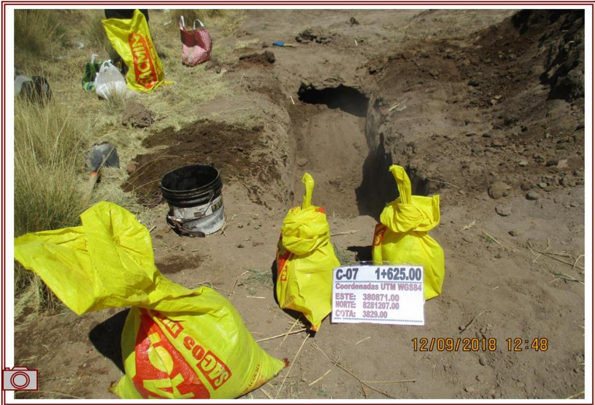
**Fotografía 7.** Traslado de muestra inalterada protegida al laboratorio para su posterior ensayo.
