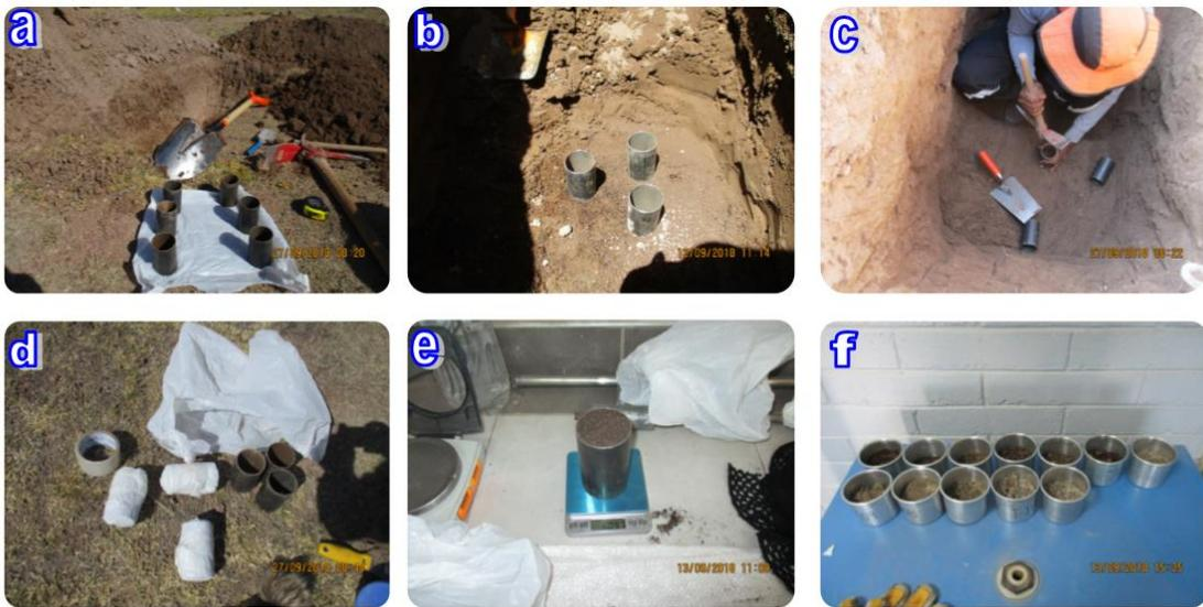
**(a):** Moldes circulares preparados para extraer las muestras. / **(b):** área habilitada para extraer las muestras. / **(c):** hincado de los moldes en el suelo de interés. / **(d):** enraizado y embalado de las muestras extraídas. / **(e):** determinación del peso unitario del suelo y respectivo volumen. / **(f):** determinación del contenido de humedad del suelo.
