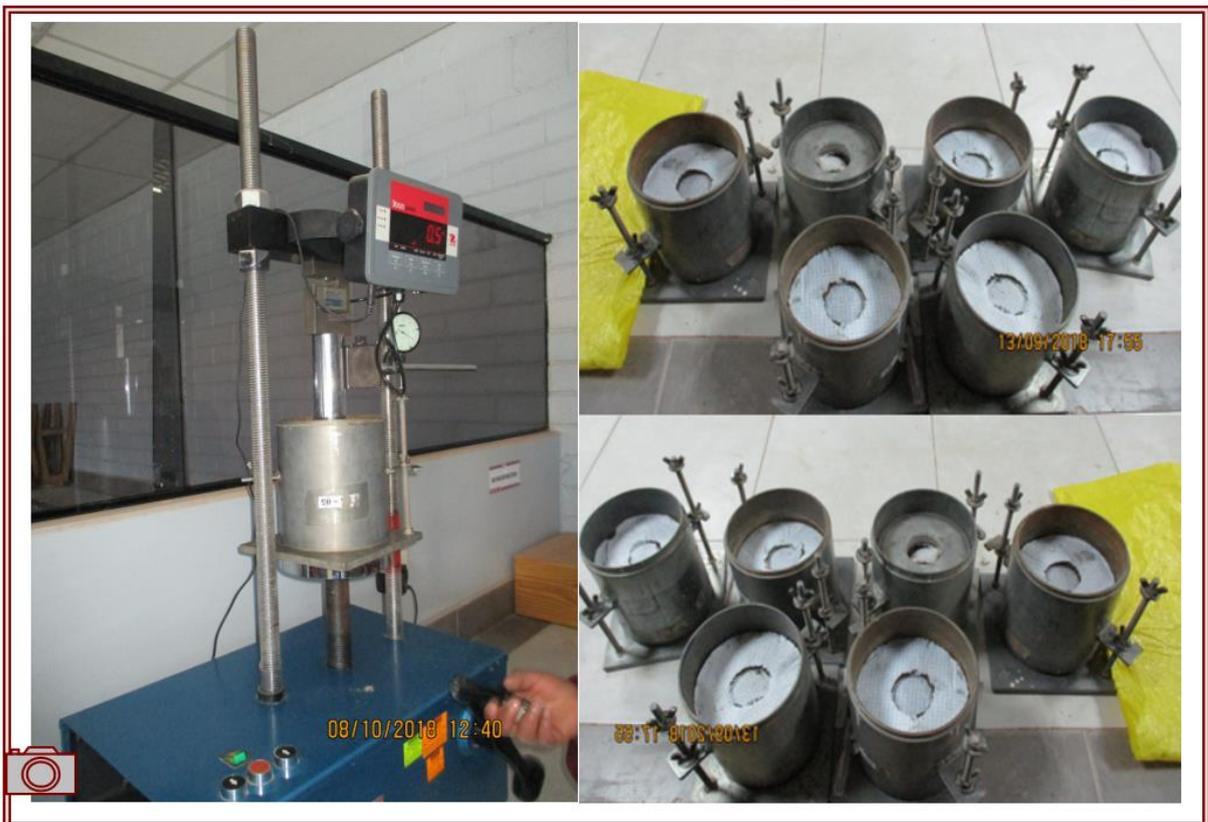
**Fotografía 16.** Ensayo de CBR sobre muestra remoldada en laboratorio en prensa de CBR.
