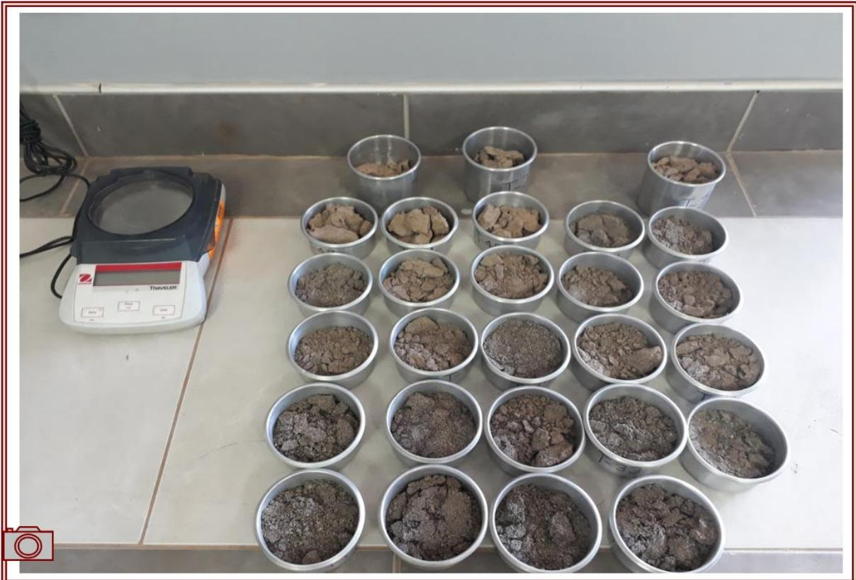
**Fotografía 20.** Determinación del contenido de humedad de los suelos de interés.
