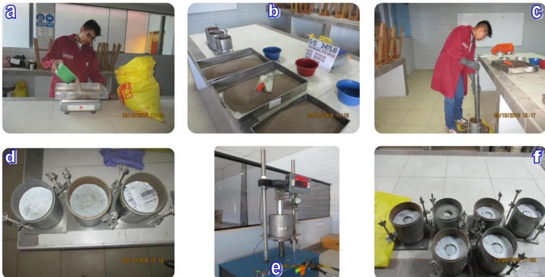
**(a):** Pesado de muestra a preparar de 5kg. / **(b):** determinación y mezclado de cantidad de agua según humedad con la muestra. / **(c):** compactación de la muestra en moldes de Proctor modificado. / **(d):** Muestra lista para su ensayo. / **(e):** ensayo de penetración en la prensa de CBR. / **(f):** determinación del grado de humedad del suelo a las muestras ensayadas.
