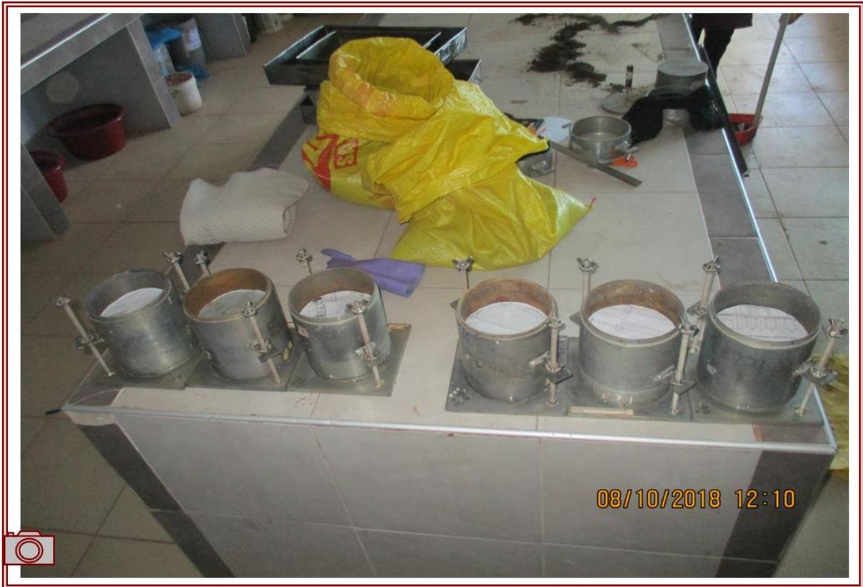
**Fotografía 15.** Muestras remoldeadas para ensayo de CBR en prensa de penetración comprobada su densidad en estado suelto y compacto.
