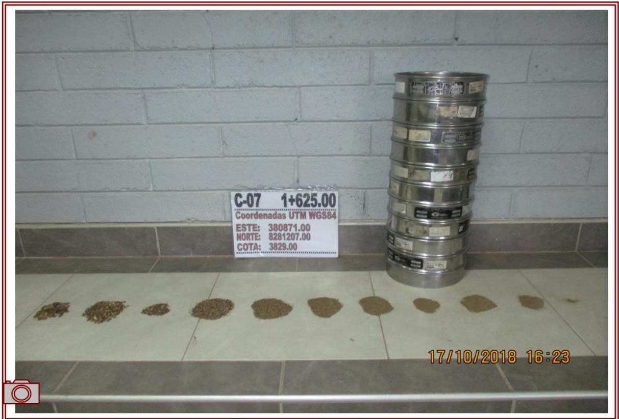
**Fotografía 18.** Ensayo de granulometría para suelos finos y arenosos mediante tamizado.
