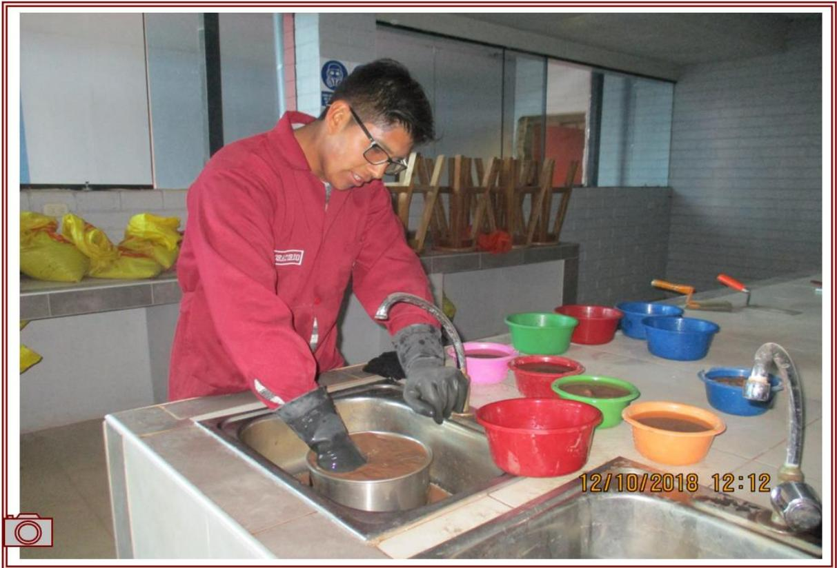
**Fotografía 17.** Lavado de muestras para ensayo de granulometría mediante tamizado.
