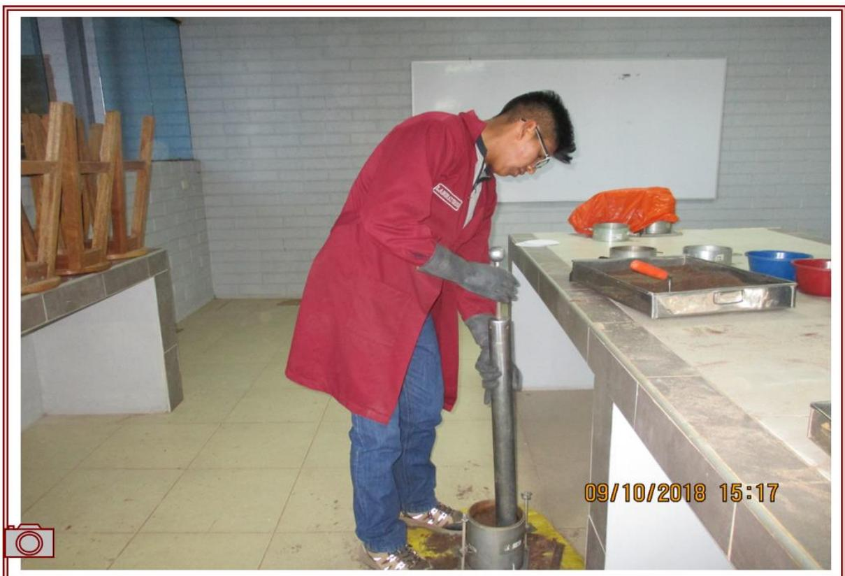
**Fotografía 14.** Compactación del suelo remoldeado a humedad y densidad de campo.
