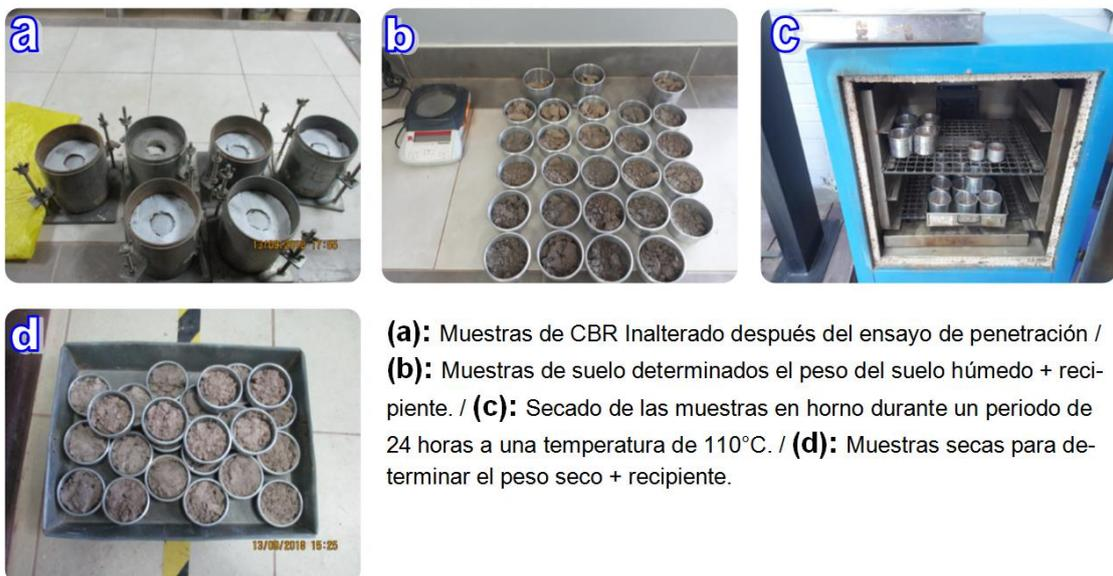
**Figura 46.** Procedimiento para determinar el contenido de humedad del suelo
