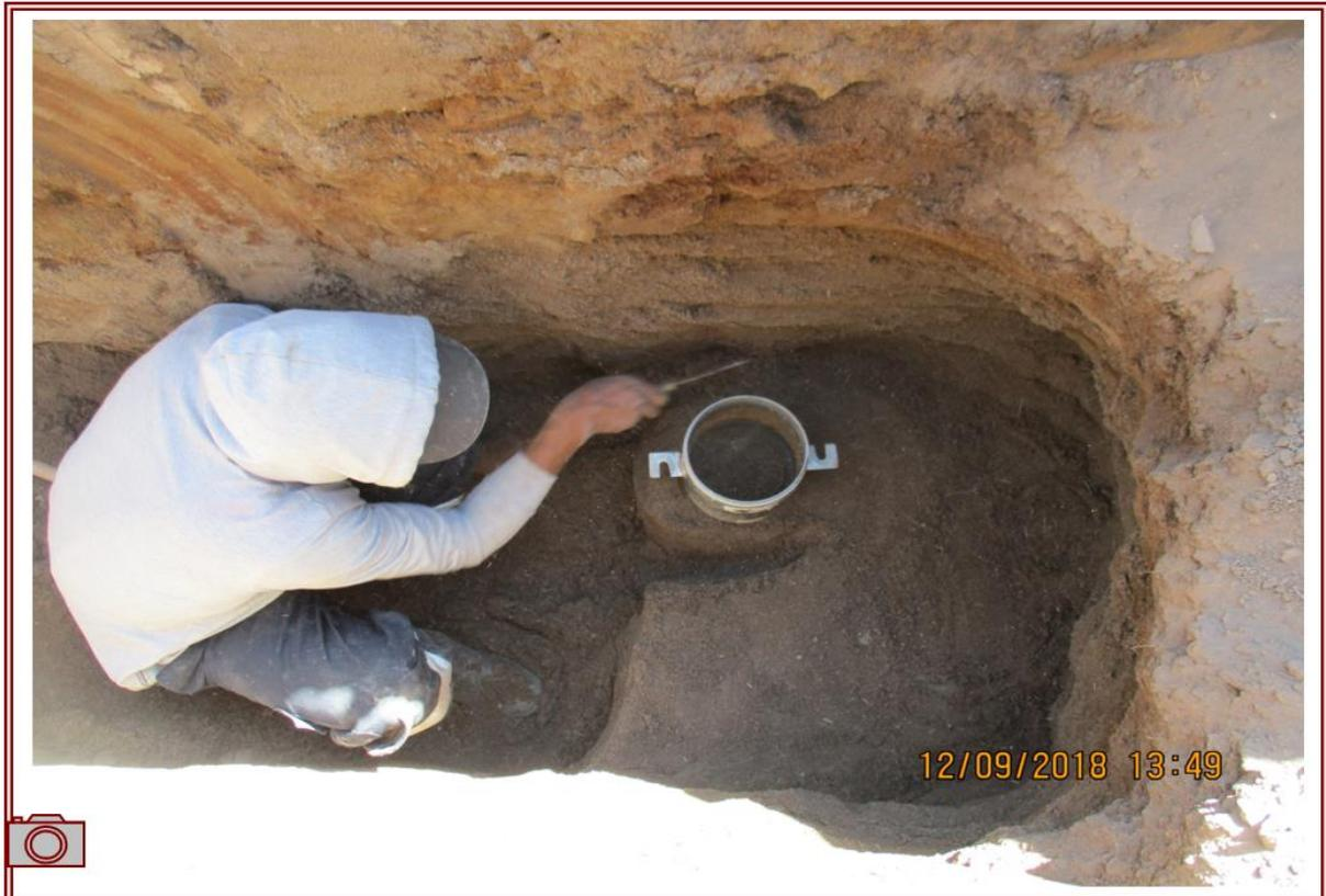
**Fotografía 6.** Extracción de muestras inalteradas en moldes de CBR sin presencia del N.F.
