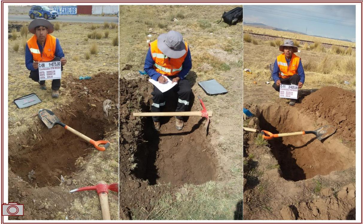
Fotografía 1. Trazo y excavación en las calicatas a  $0.50 \pm 0.10\text{m}$  de profundidad.
