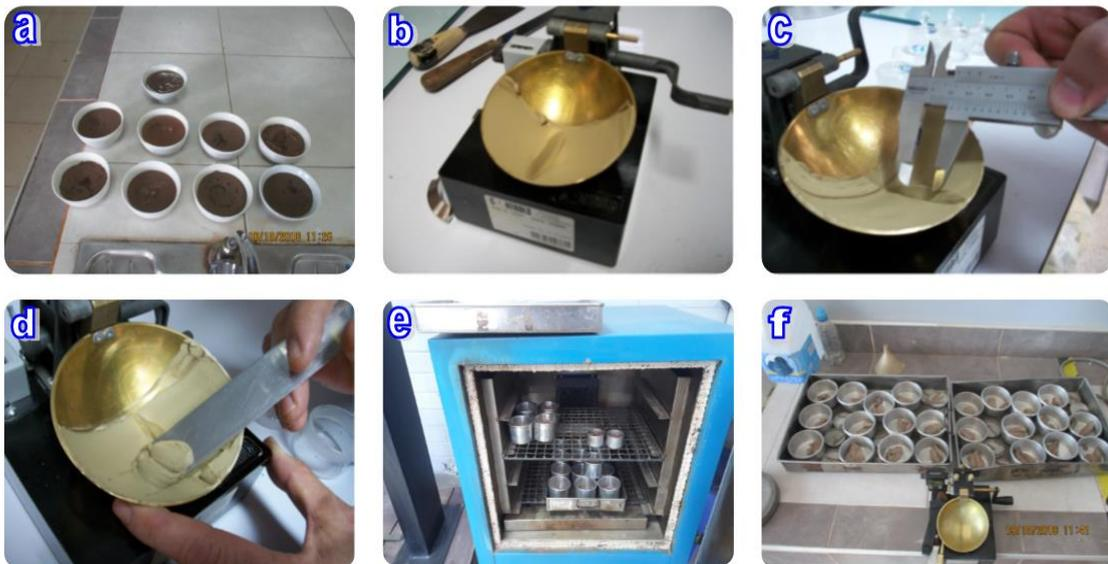
**(a):** Muestras saturadas tamizadas por la malla #40. / **(b):** colocación de la muestra en la cuchara de Casagrande. / **(c):** determinando la cerradura a un determinado cantidad de golpes. / **(d):** extracción de una porción de la muestra para contenido de humedad. / **(e):** secado de las muestras en horno a 120°C. / **(f):** determinación del peso seco de las muestras.
