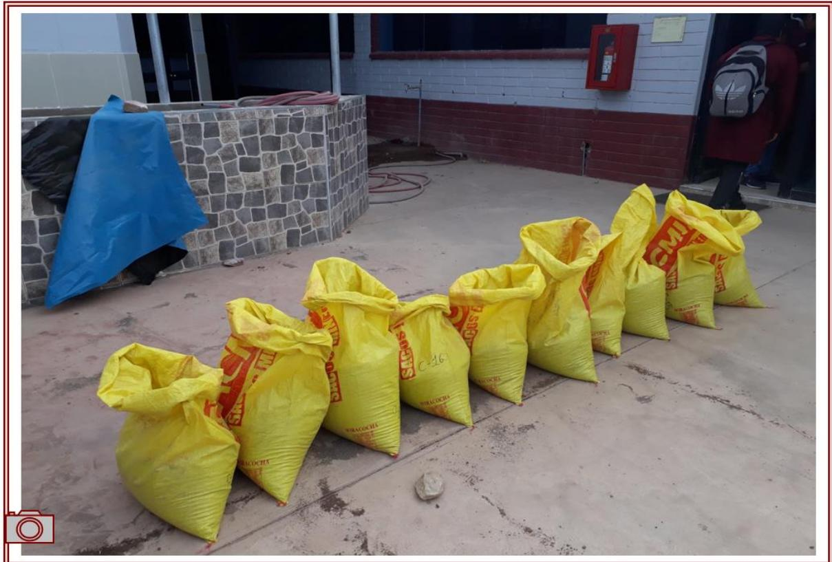
**Fotografía 8.** Muestras alteradas para el ensayo de CBR remoldeado en laboratorio.
