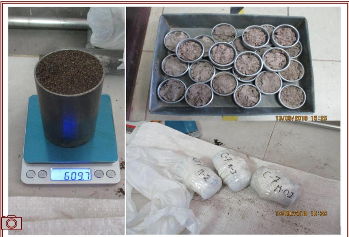
**Fotografía 12.** Estimación del peso y volumen de las muestras extraídos en campo para su respectiva densidad.
