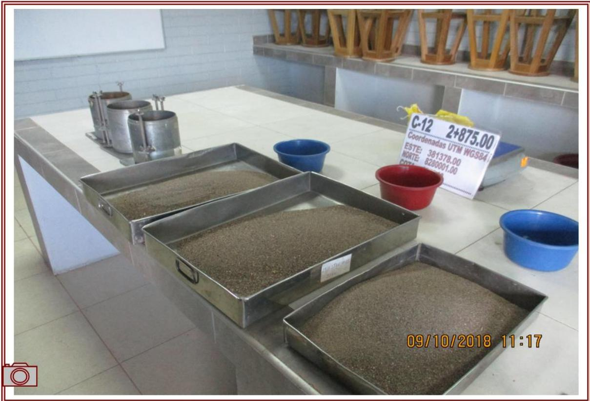
**Fotografía 13.** Preparación de muestras en suelos arenosos para el ensayo de Proctor a humedad y densidad de campo.
