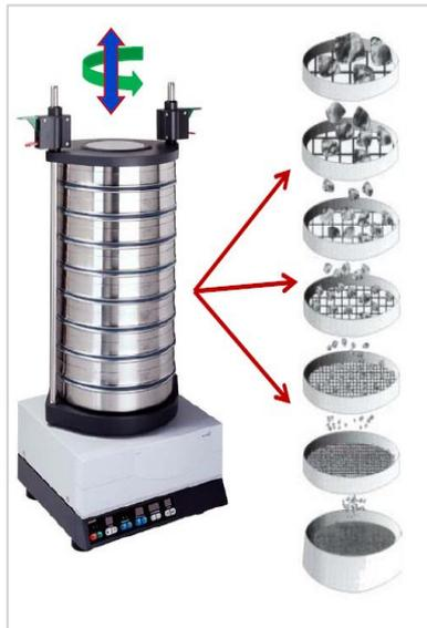
**Figura 25.** Distribución granulométrica de suelos por tamizado.
