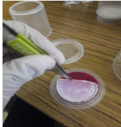
Fotografía 24. Proceso de colocación de filtro, al caldo de cultivo.
