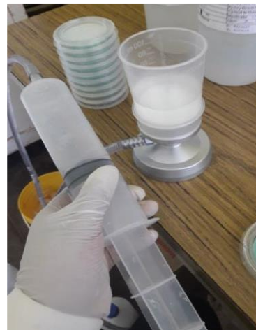
Fotografía 22. Proceso de Filtración, para coliformes Totales y E.coli
