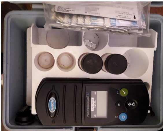
Fotografía 9. Equipo medidor de cloro residual
