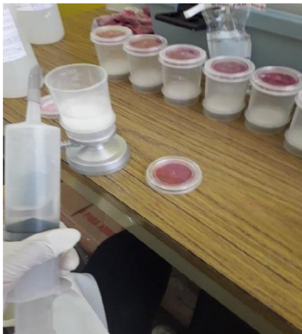
Fotografía 21. Proceso de filtración para coliformes Termotolerantes
