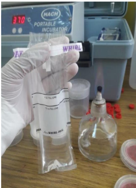
Fotografía 20. Proceso de desestabilización de Cloro Residual del agua
