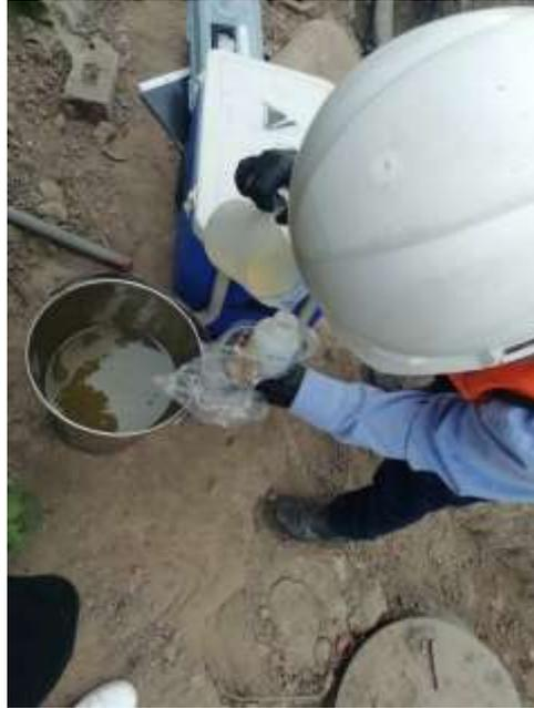
Figura 59. Colocación de ácido sulfúrico.
