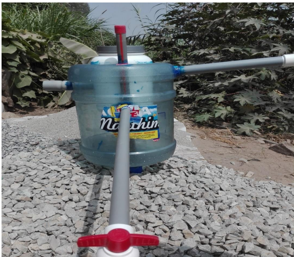
Figura 73. Construcción del biodigestor
