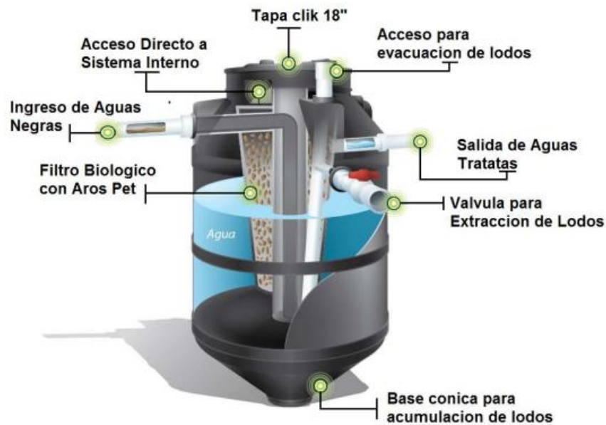
Figura 2. Componentes del biodigestor (Rotoplas, 2018)
