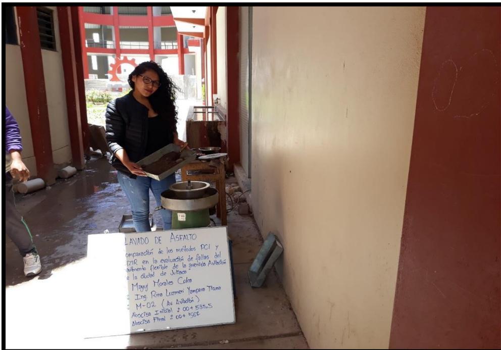
Fotografía 12. Ensayo de lavado de asfalto de la muestra M-02.
