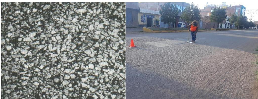
Figura 14. Pulimiento de agregados. Fuente: Vásquez (2002)
