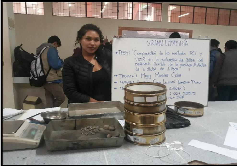
Fotografía 13. Ensayo de granulometría post ensayo de lavado de asfalto de la muestra M-01.
