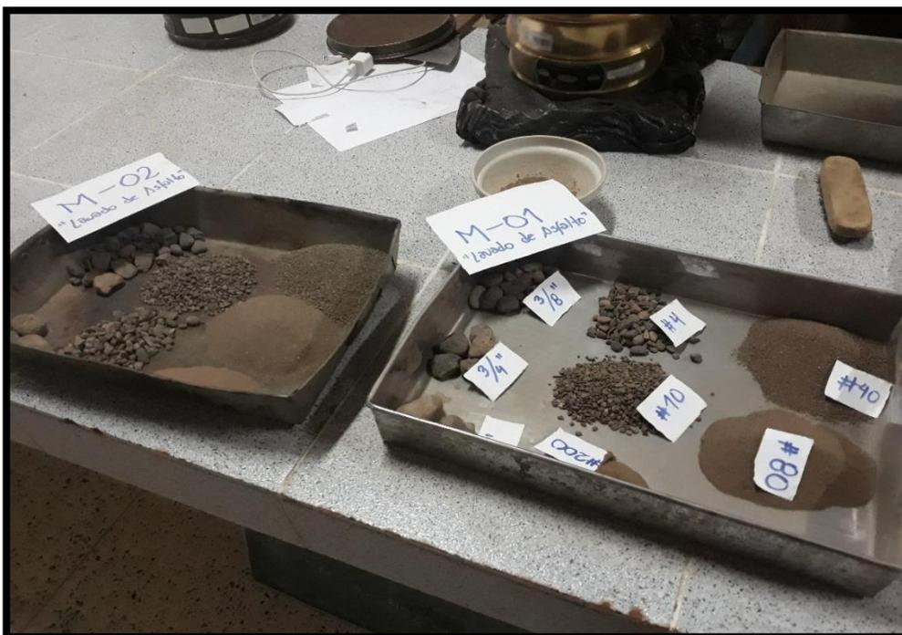
Fotografía 14. Muestra granulométrica de las unidades de muestra M-01 y M-02.
