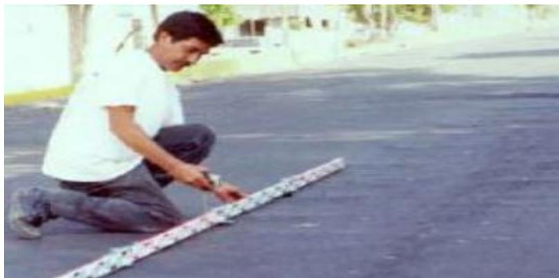
Figura 7. Corrugación de baja severidad. Fuente: Vásquez (2002)
