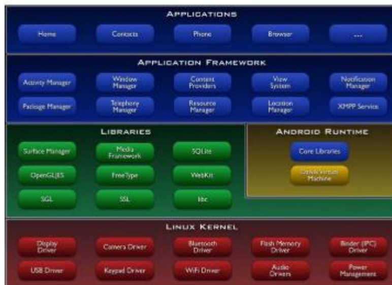
Figura 3. Arquitectura Android según (Android, 2018).
