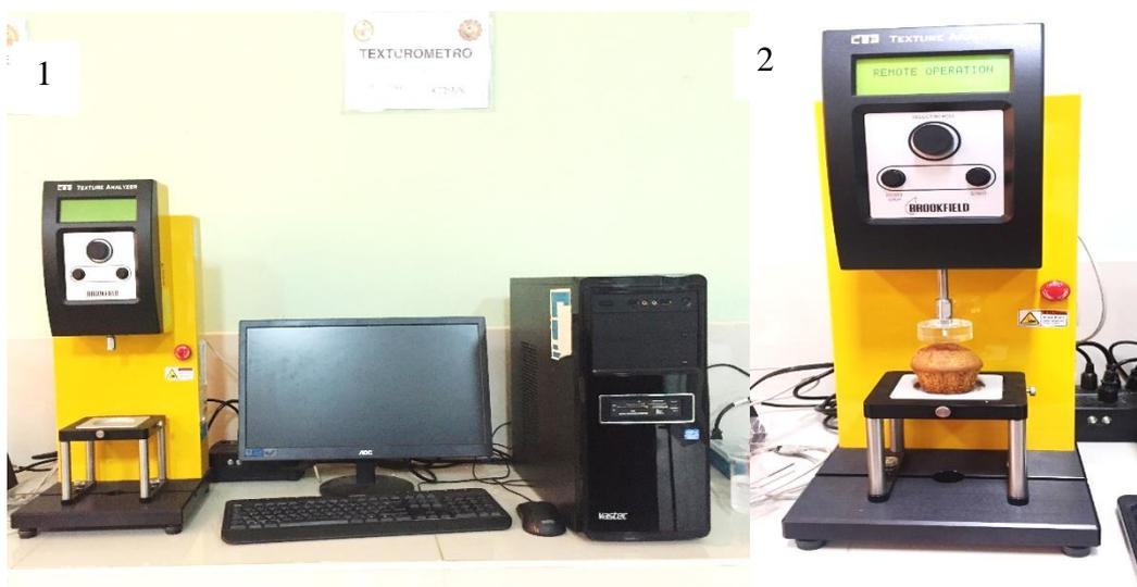
**Figura 15.** <sup>1</sup>Texturómetro Brokfield. <sup>2</sup>Análisis de textura en muestra de cupcake
