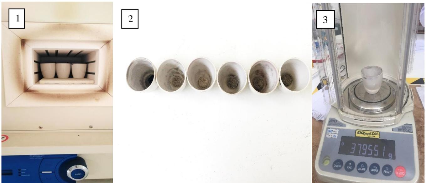
**Figura 60.** <sup>1</sup>Icineración de muestras en mufla. <sup>2</sup>Cenizas de muestras. <sup>3</sup>Peso de crisol con cenizas
