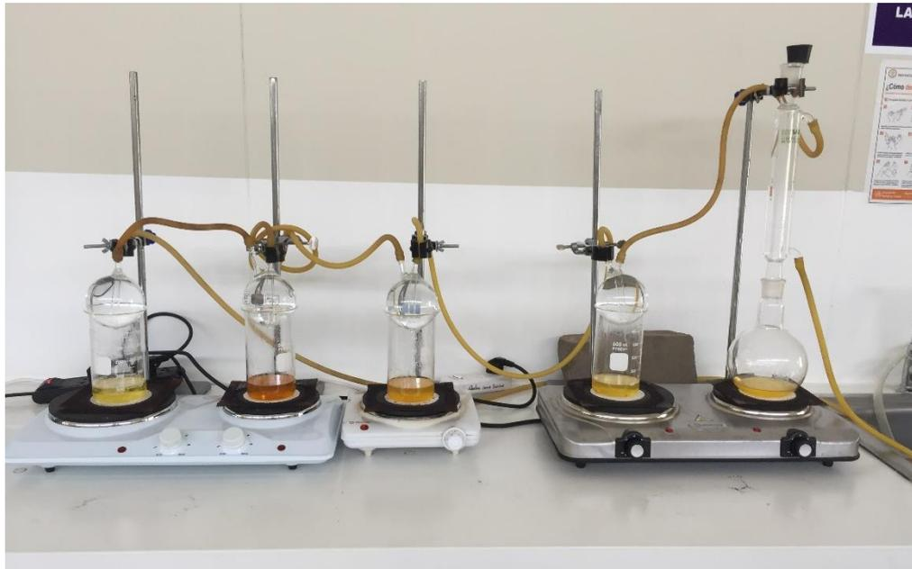
**Figura 58.**Equipo para determinación de fibra
