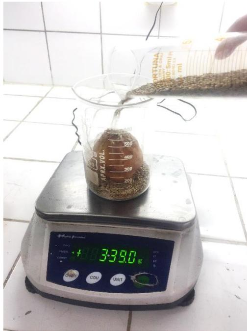
**Figura 13.** Determinación de densidad del cupcake por el método de desplazamiento de semillas
