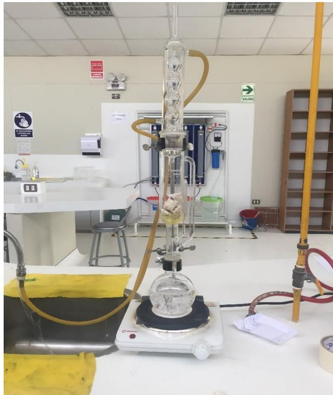
**Figura 57.** Desgrasado de muestras en equipo soxhlet
