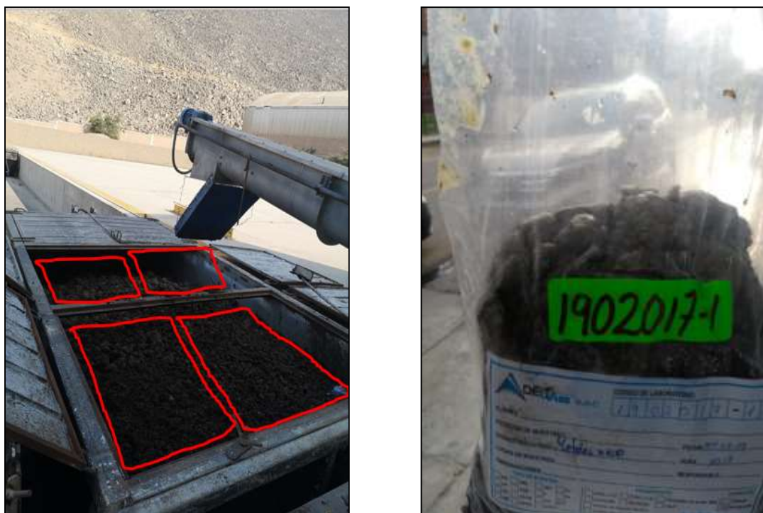
Figura 9. Muestreo de lodos orgánicos residuales de la PTAR Manchay, Pachacamac, Lima.
