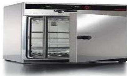
Figura 4. Determinación de humedad
