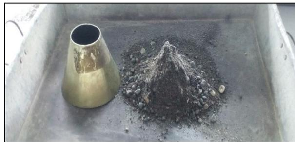
*Figura 19.* Ensayo de peso específico del agregado
