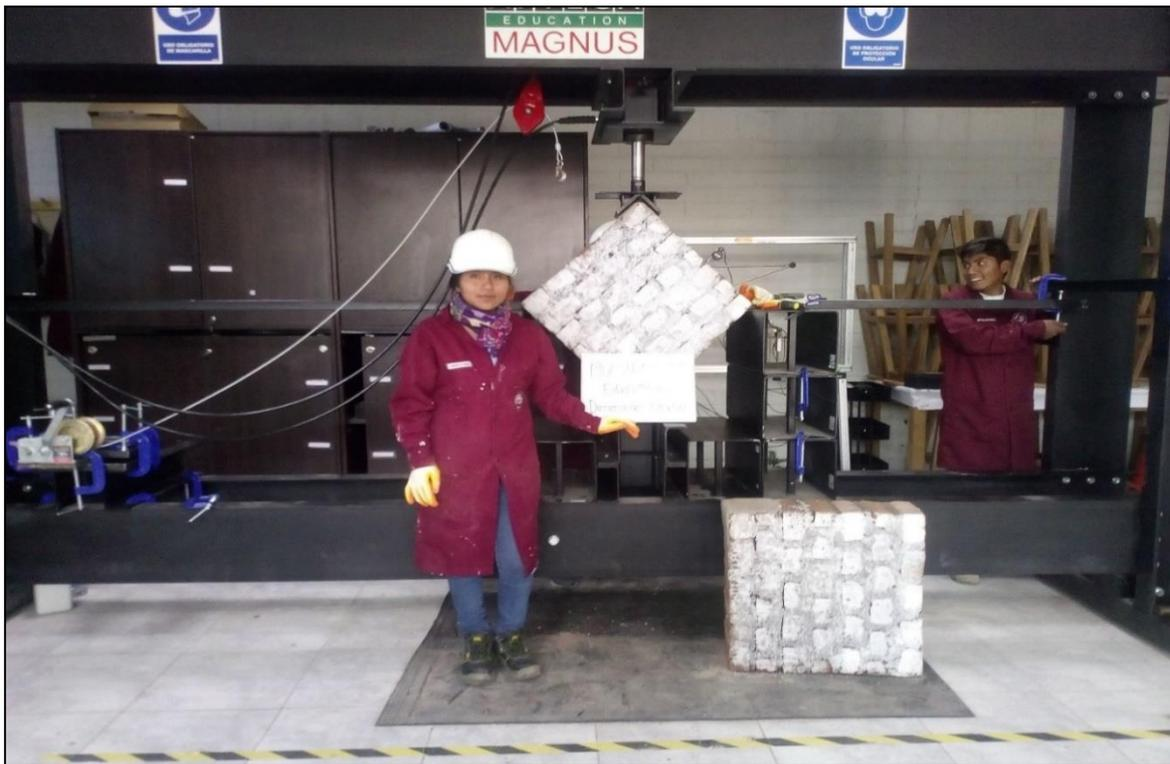
Fotografía 13. Ensayo de resistencia a compresión diagonal de muretes de albañilería artesanal
