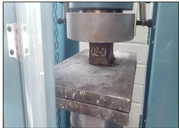
Fotografía 9. Ensayo de resistencia a compresión de dados de mortero
