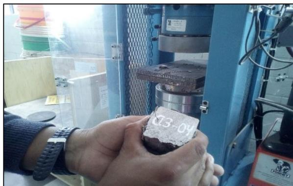
*Figura 20.* Muestra de dados de mortero de Cabanillas
