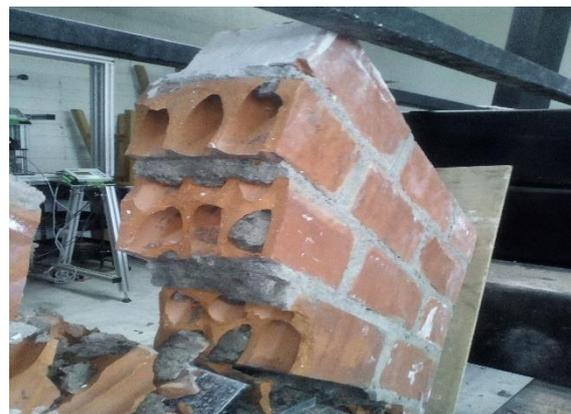
*Figura 48.* Falla mixta de muretes industriales Maxx
