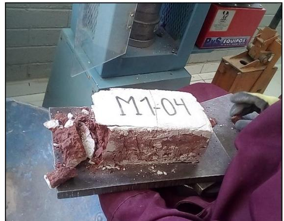
Fotografía 6. Ensayo de resistencia a compresión de unidades de albañilería industrial (izquierda) y artesanal (derecha)
