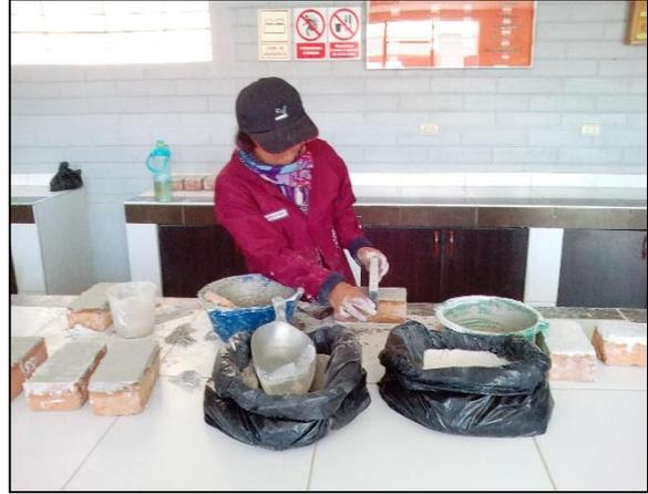
Fotografía 4. Aplicación de capping de yeso, para ensayo de resistencia a compresión de unidad
