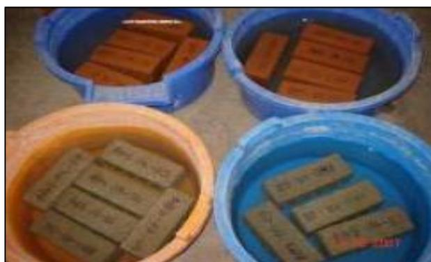
*Figura 7.* Medición de la absorción de la unidad de albañilería
