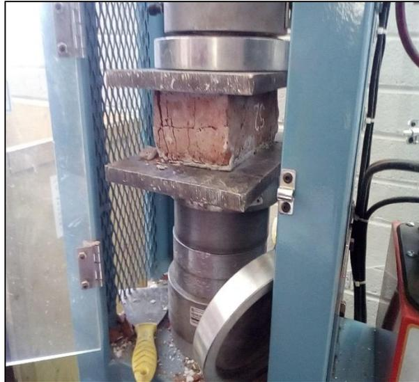
*Figura 14.* Unidad de albañilería en la máquina de ensayo.
