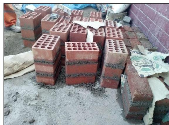
Fotografía 11. Elaboración de pilas de albañilería industrial y artesanal.
