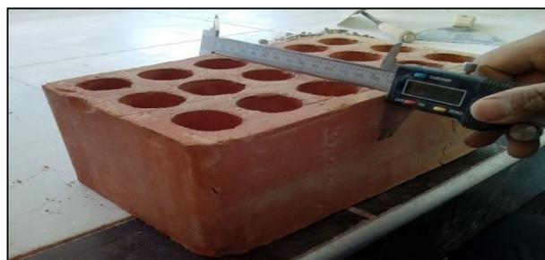
Figura 12. Determinación del ancho de la unidad
