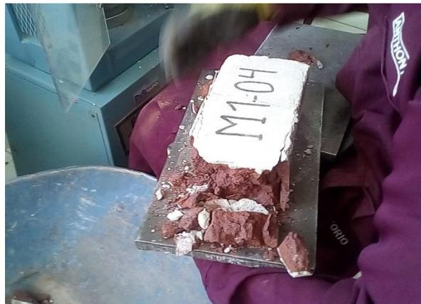
Figura 30. Resistencia a la compresión de unidades de albañilería artesanal
