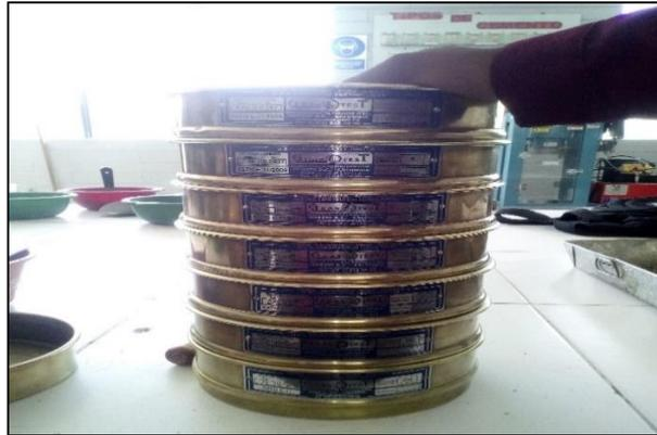
*Figura 18.* Tamices utilizados para el ensayo de análisis granulométrico
