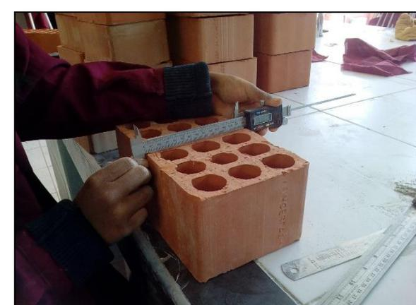
Fotografía 3. Ensayo de variación dimensional de unidades de albañilería artesanal (izquierda) e industrial (derecha)
