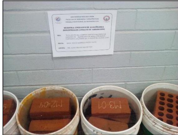
Fotografía 7. Ensayo de absorción de unidades de albañilería industrial y artesanal
