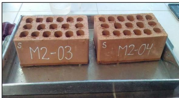
Figura 16. Ensayo de succión de unidades de albañilería
