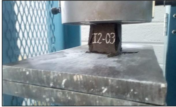
*Figura 21.* Ensayo de resistencia a compresión de dados de mortero
