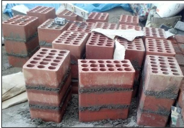
*Figura 22.* Pilas de albañilería industrial
