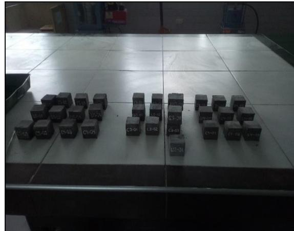
Fotografía 8. Elaboración de los dados de mortero de la Cantera Cabanillas, Unocolla e Isla
