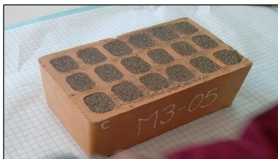
*Figura 15.* Llenado de arena en los alvéolos de unidades de albañilería
