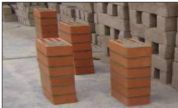
Figura 8. Pilas de albañilería.
