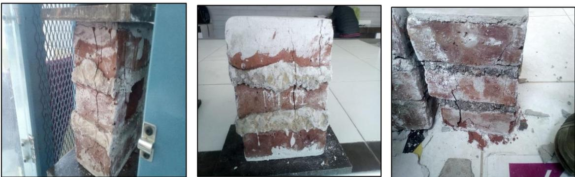
Figura 42. Falla a compresión axial de pilas
