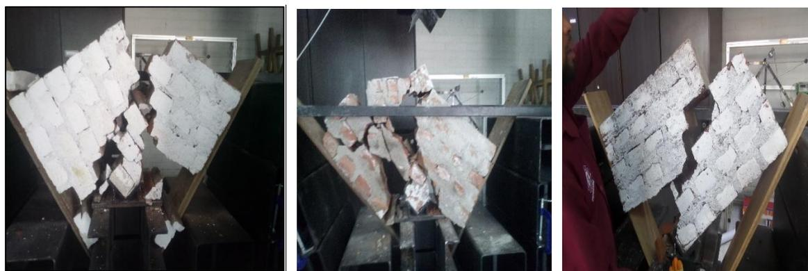
*Figura 50.* Falla por cizalle, mixta y escalonada de muretes artesanal
