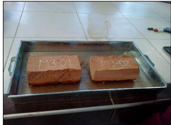
Fotografía 5. Ensayo de succión de unidades de albañilería industrial (izquierda) y artesanal (derecha)
