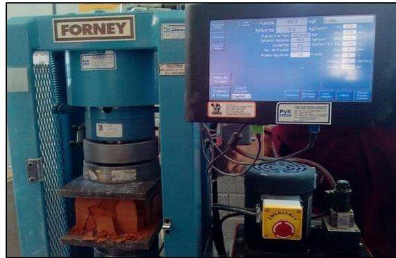
Figura 29. Resistencia a la compresión de unidades de albañilería industrial
