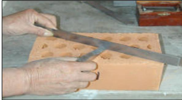
*Figura 5.* Medición del alabeo de la unidad de albañilería
