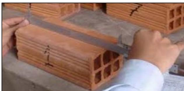
*Figura 3.* Unidad de albañilería tubular.
