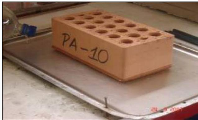
Figura 6. Medición de la succión de la unidad de albañilería.
