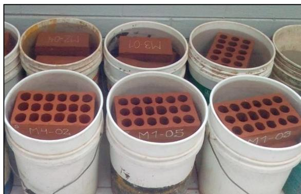
Figura 17. Unidades de albañilería sumergidas en agua
