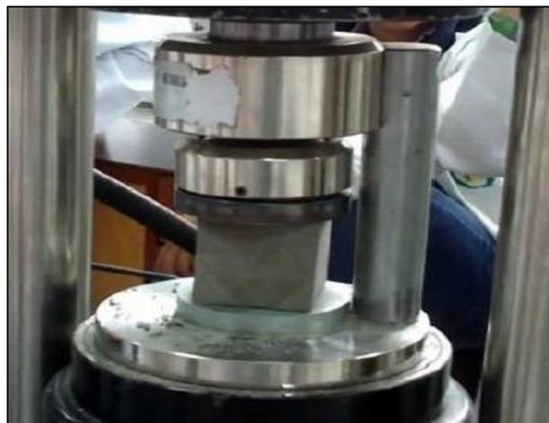
Figura 11. Ensayo a compresión del mortero.
