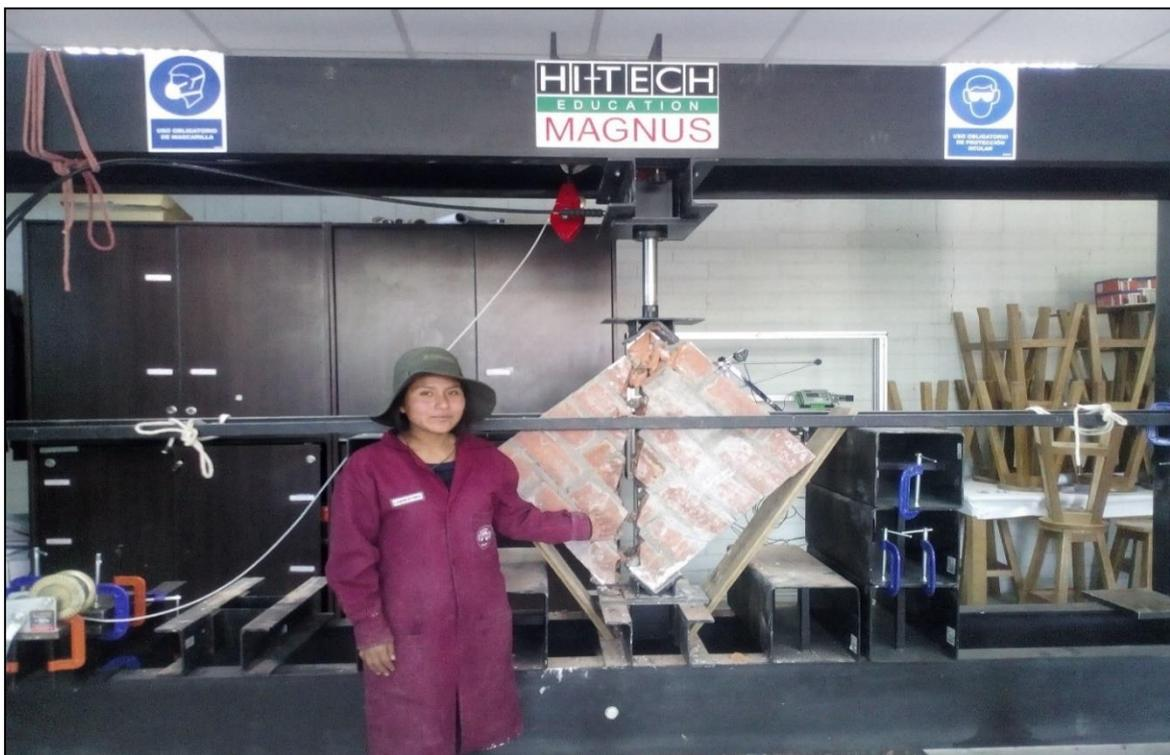
Fotografía 14. Ensayo de resistencia a compresión diagonal de muretes de albañilería industrial
