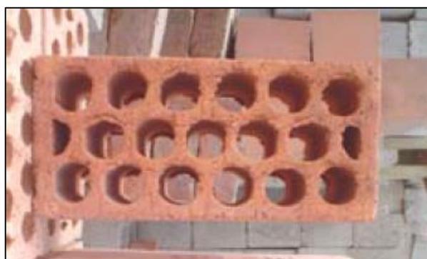
*Figura 2.* Unidad de albañilería hueca
