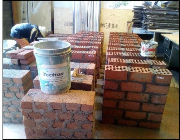
Fotografía 10. Elaboración de muretes de albañilería artesanal (izquierda) e industrial (derecha)
