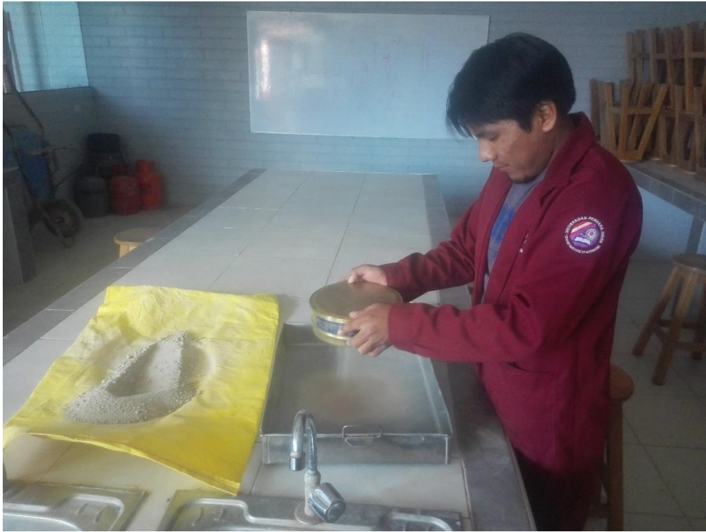
Figura 32: Tamizado por el tamiz N° 200, para realizar el ensayo para límites de atterberg
