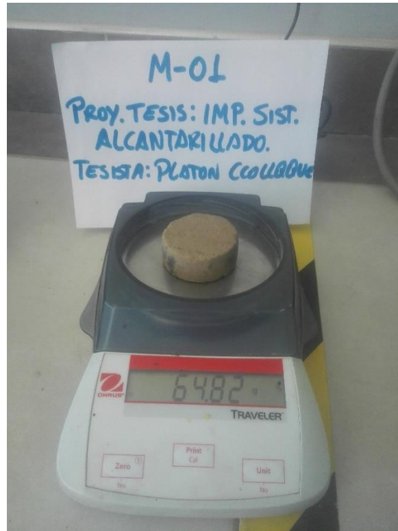
Figura 30: Pesando el molde
