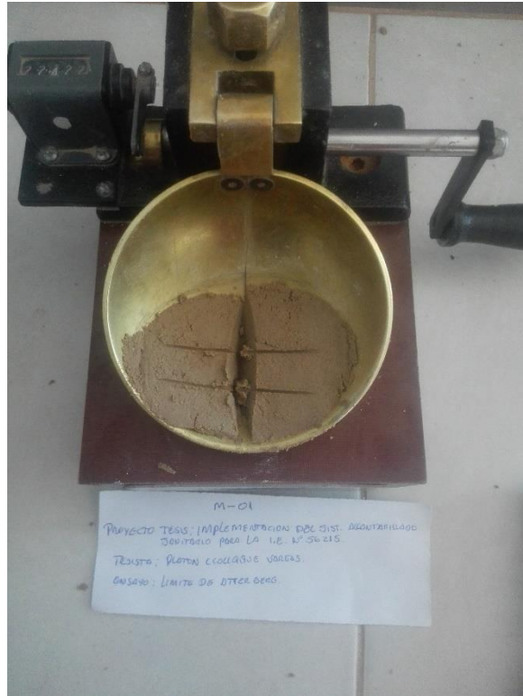
Figura 36: Ensayo en la cuchara de Casagrande
