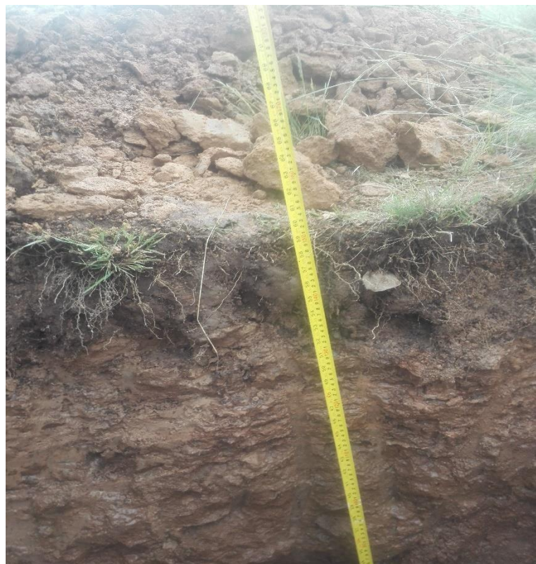
Figura 47: Realizando la medición de la altura de la calicata
