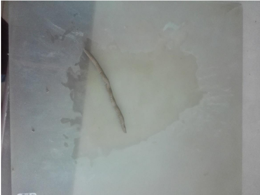
Figura 38: Tiras para obtener el límite plástico
