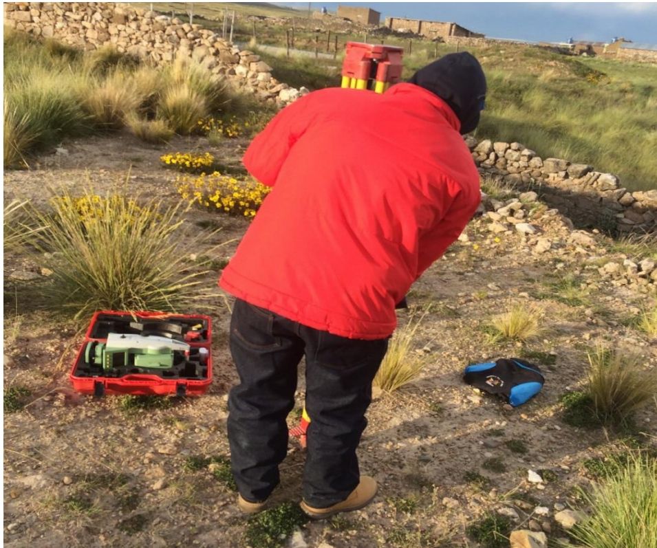
Figura 54: Preparando los accesorios para estación la estación total.
