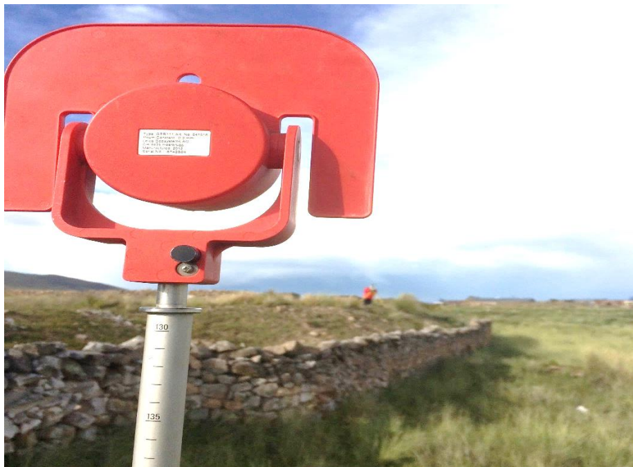
Figura 59: Ubicando el prisma con la estación total
