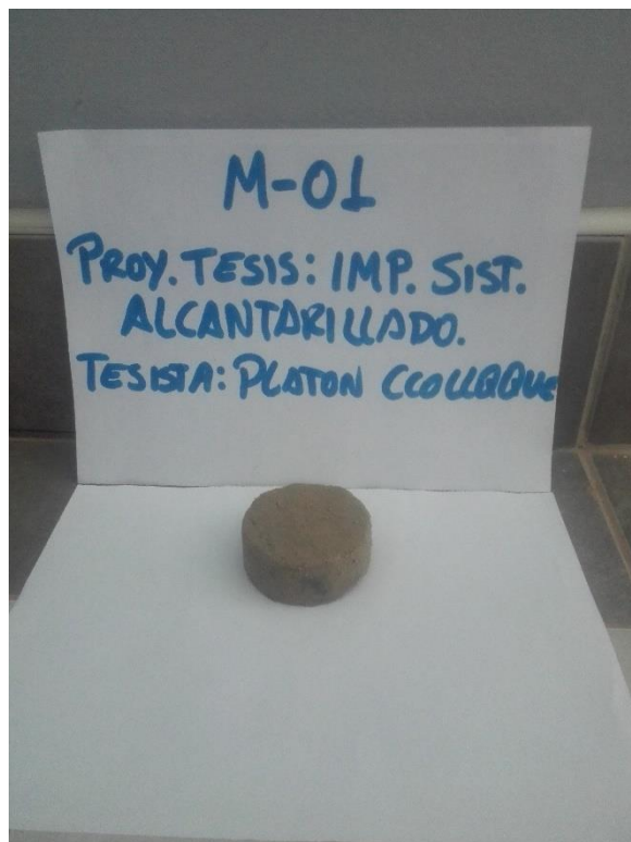
Figura 29: Molde listo para realizar el ensayo de corte directo
