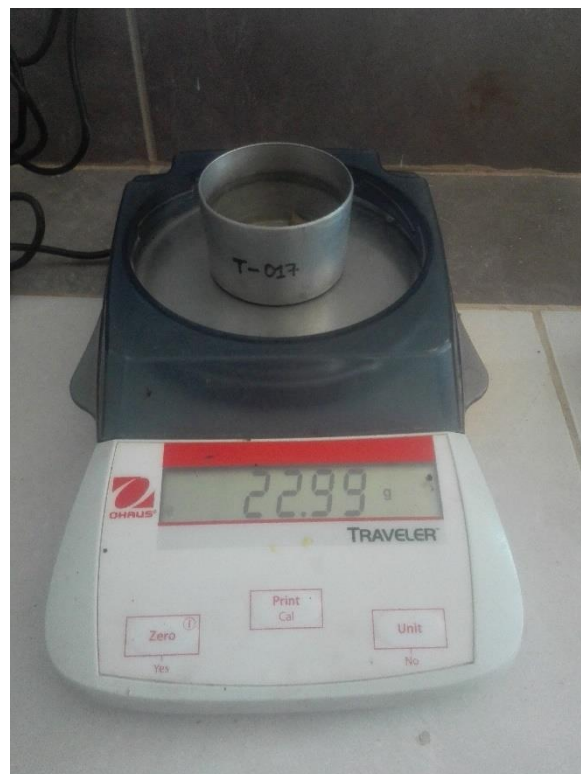
Figura 39: Pesando para el contenido de humedad, para luego introducirlas al horno por 24 horas
