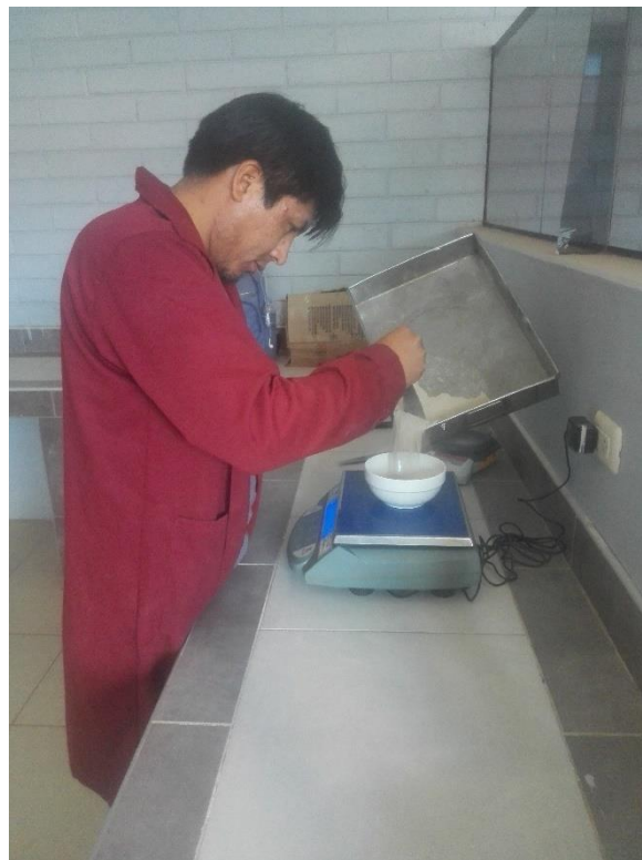
Figura 33: Pesando lo tamizado para un peso de 200 gr.
