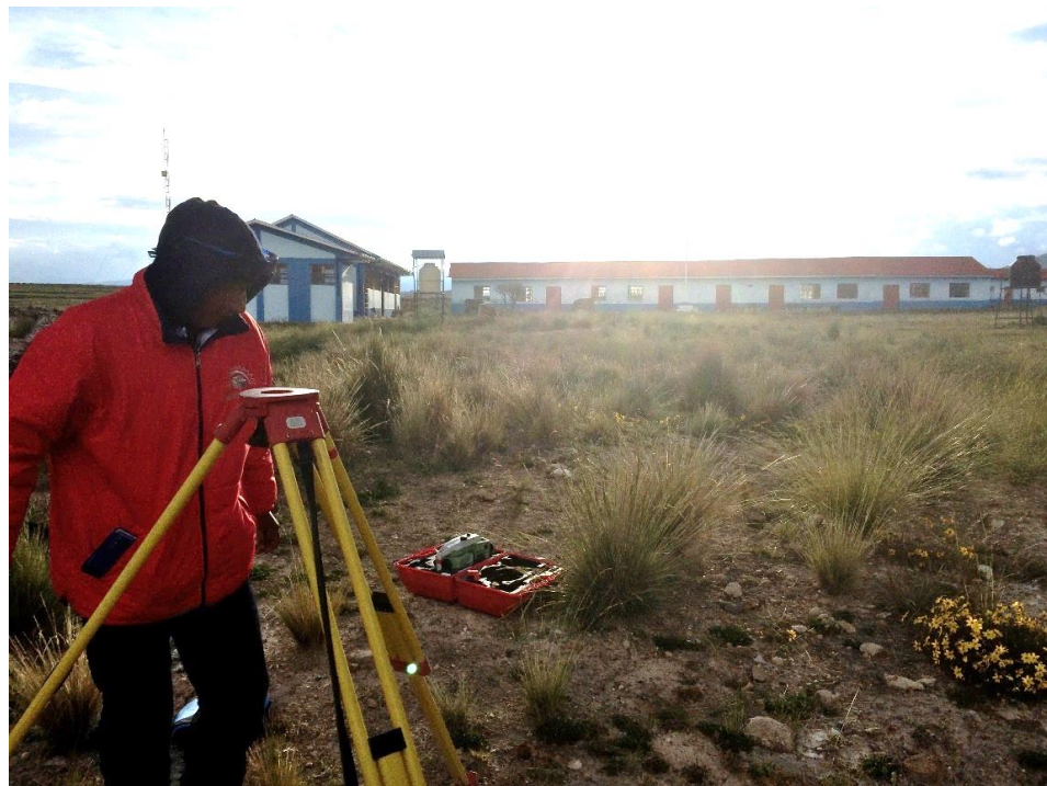
Figura 55: Estacionando la estación total
