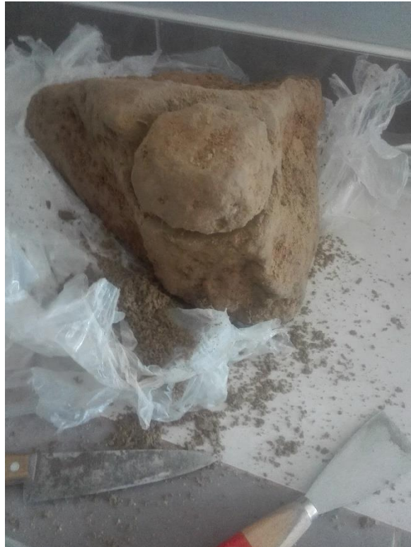
Figura 28: Tallado para obtener moldes para el ensayo de corte directo
