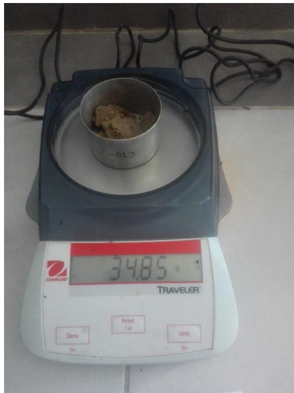
Figura 37: Pesando para el contenido de humedad, para luego introducirlas al horno por 24 horas
