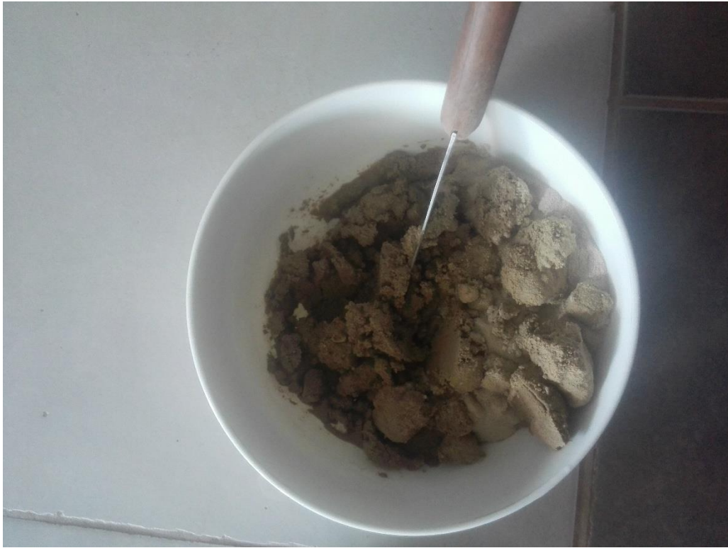
Figura 34: Mezclado del suelo tamizado con agua, hasta obtener una mezcla pastosa
