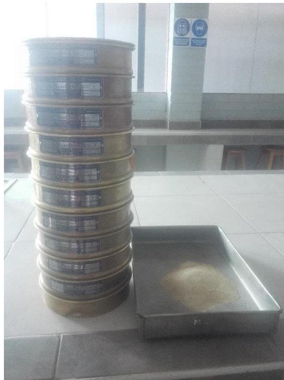
Figura 41: Tamizado para realizar la granulometría del suelo
