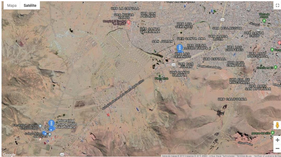
Figura 3. Distancia del Nodo Lora al Gateway (3.5km).
