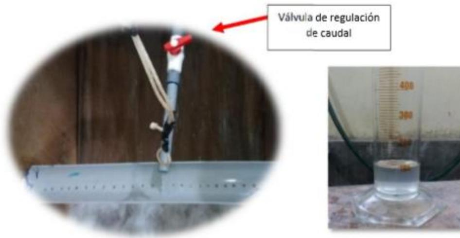
*Nota:* Izquierda. Válvula de regulación de caudal para dosificación, derecha probeta utilizada para la regulación de caudal de dosificación.
