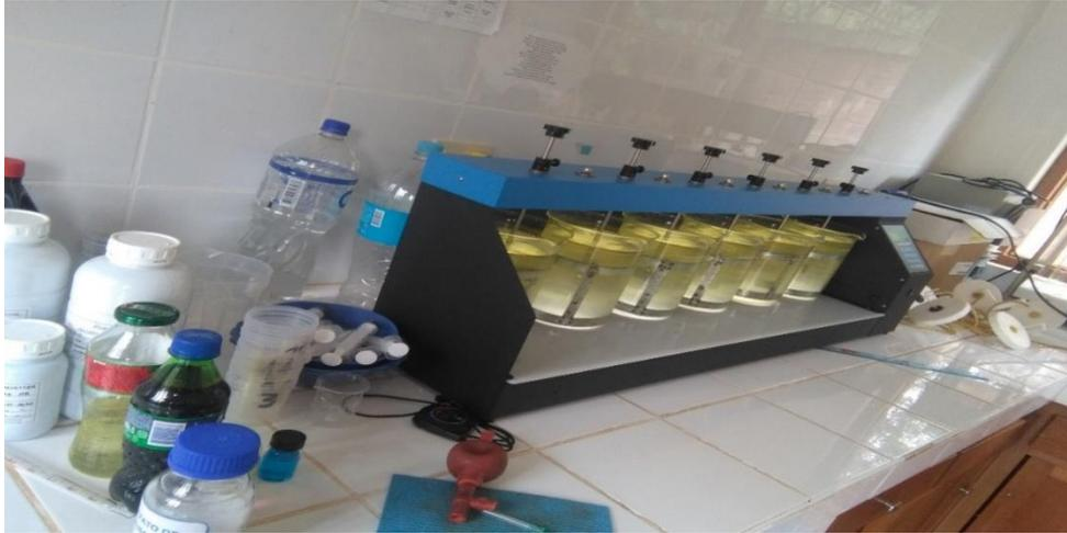
En la Figura 29 se observan los insumos químicos empleados en las pruebas de tratabilidad y en la Figura 30 se aprecia el equipo de prueba de jarras con el que cuenta el laboratorio de la PTAP de Villa Rica.
