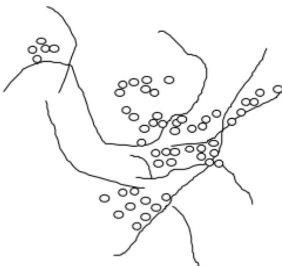
El floculante tiene una capacidad de formar puentes entre las partículas aglomeradas para la formación de flocs de mayor tamaño y su posterior decantación
