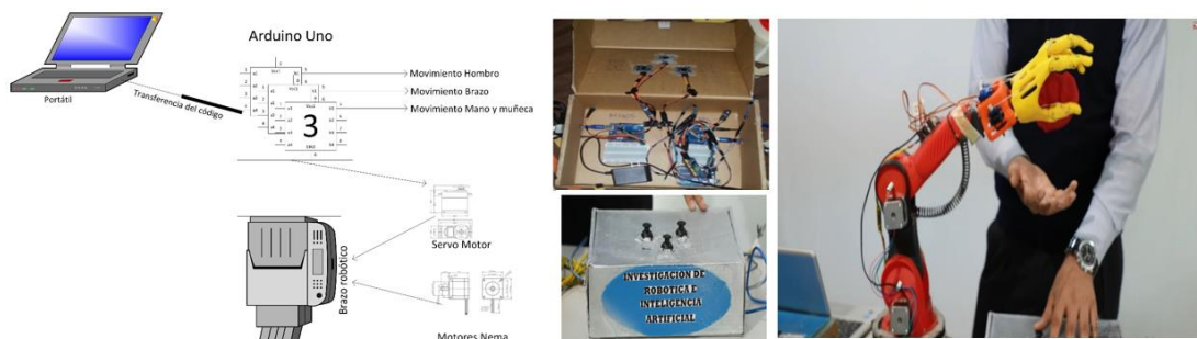
Figura 38: Conexión de motores con Arduino y joystick
