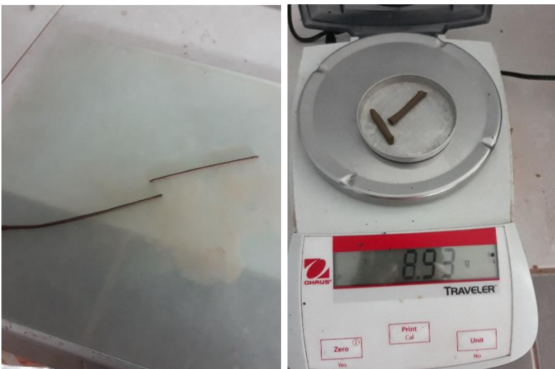
Ensayo de límite plástico y pesado de la muestra.
