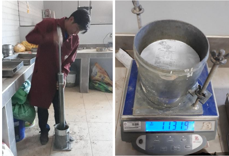
Figura 28. Compactación y pesado del molde de CBR (Elaboración propia)
