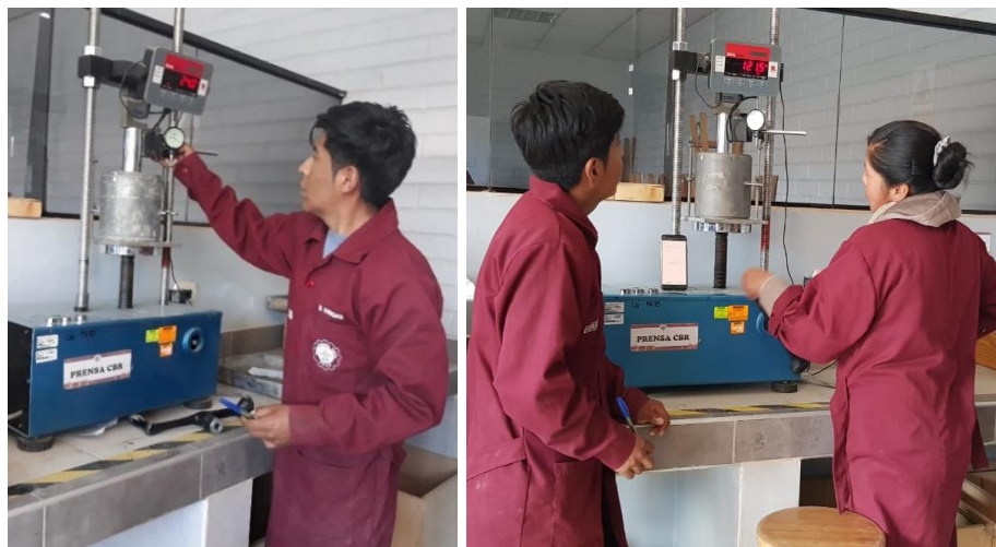
Figura 30. Penetración en la prensa de CBR (Elaboración propia)
