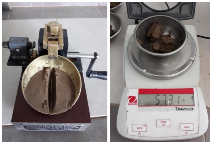
Figura 24. Realización del ensayo de limite líquido (Elaboración propia)
