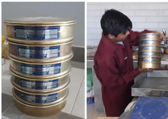
Figura 22. Realización de análisis granulométrico de suelos (Elaboración propia)
