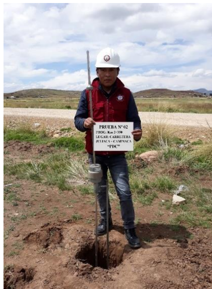
Figura 18. Ensayo N°02 de PDC in – situ en el tramo de estudio (Elaboración propia)
