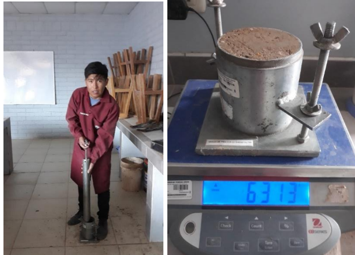
Figura 27. Compactación por capas y pesado de la muestra (Elaboración propia)
