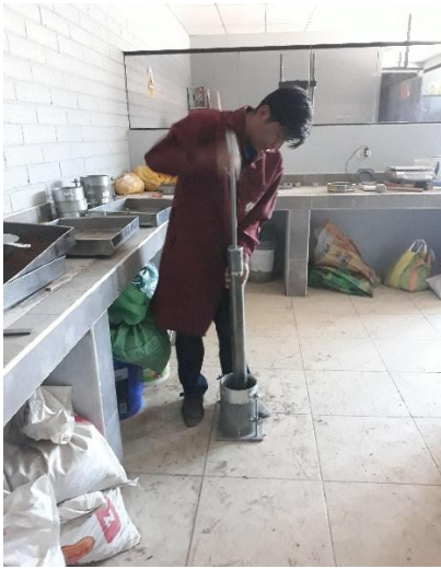
Compactación y pesado de la muestra para el ensayo de CBR.
