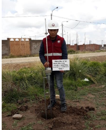
Figura 17. Ensayo N°01 de PDC in – situ en el tramo de estudio (Elaboración propia)
