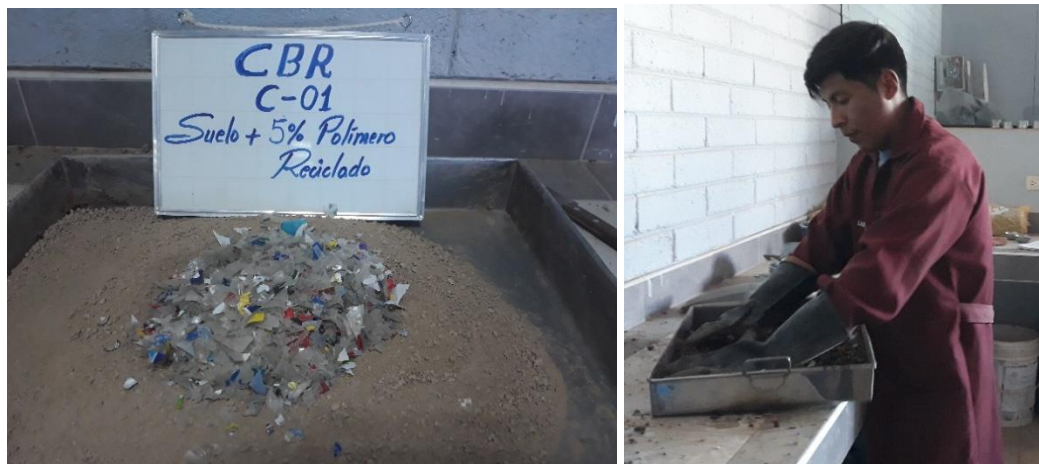
Figura 33. Preparación de la muestra con polímeros reciclados PET
