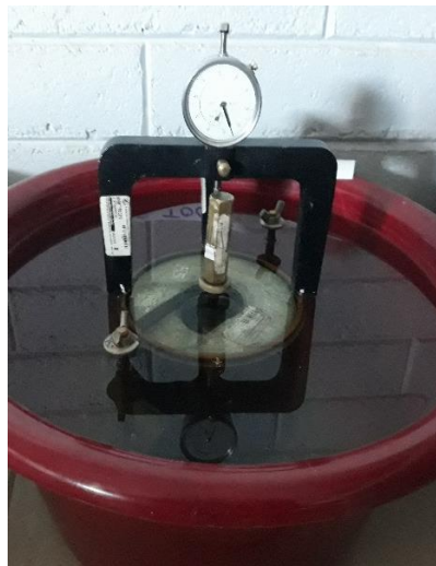
Medición de la expansión y penetración en la prensa de CBR.
