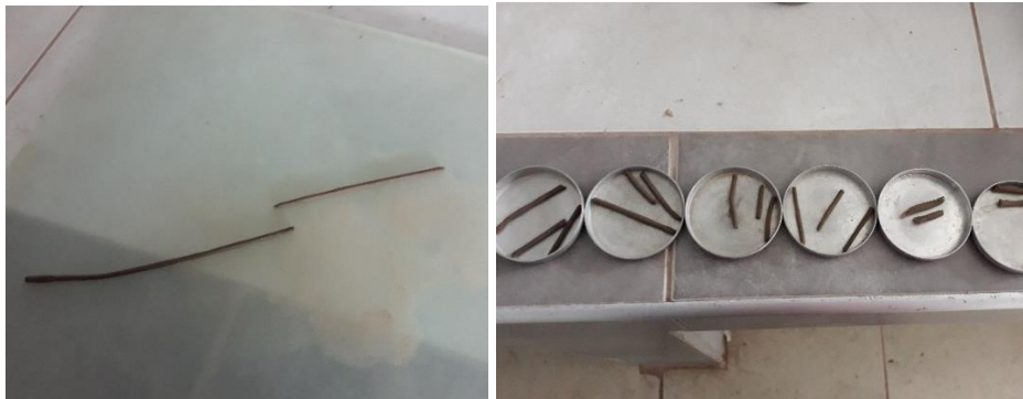
Figura 25. Realización del ensayo de límite plástico (Elaboración propia)
