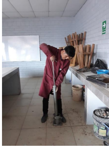
Muestra compactada en 5 capas para el ensayo de proctor modificado.
