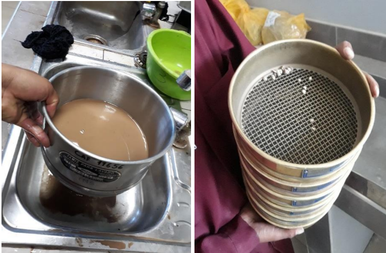
Lavado y tamizado de la muestra para el ensayo de análisis granulométrico.
