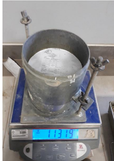
Compactación y pesado de la muestra para el ensayo de CBR.
