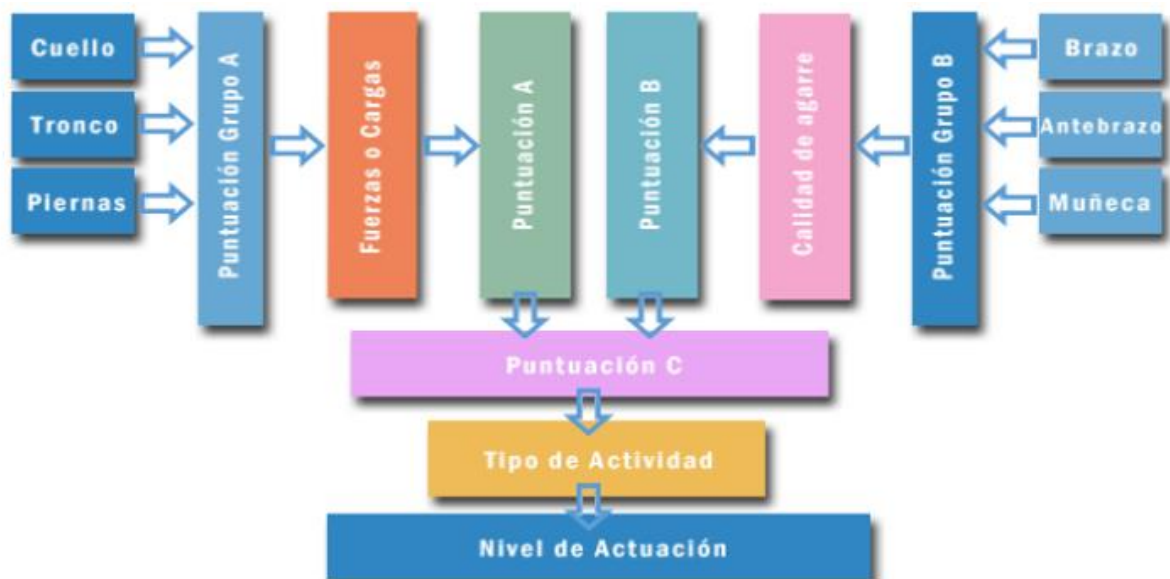
Figura 18. Resumen del proceso de obtención del nivel de actuación en el método REBA
