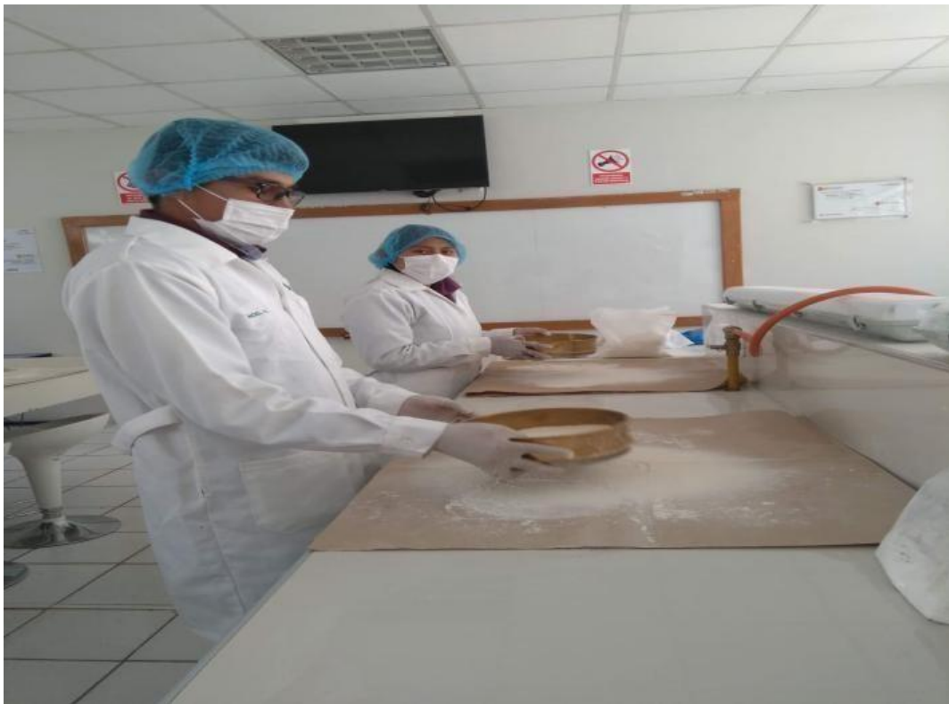
Figura 3. Selección y tamizaje de la cal artesanal
