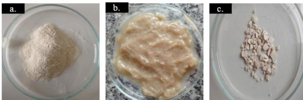
*Figura 2.* Apariencia de la nanocelulosa (a) celulosa (b) celulosa hidrolizada con ácido, es decir, nanocelulosa; (c) nanocelulosa seca.
