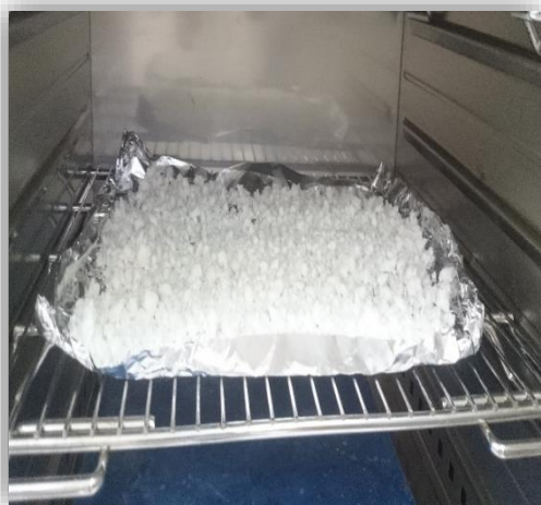
Secado de la celulosa de tallos de quinua
