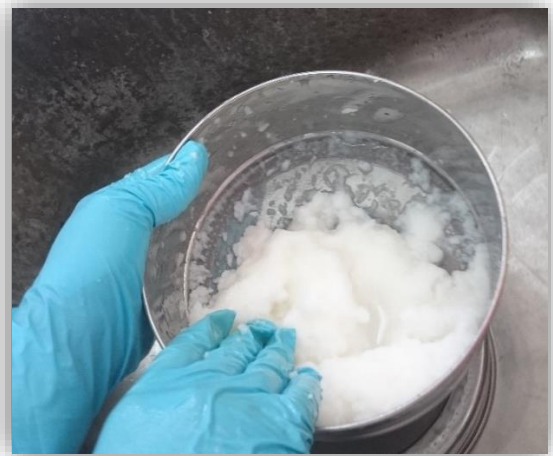
Lavado de la celulosa de tallos de quinua llevando a pH neutro
