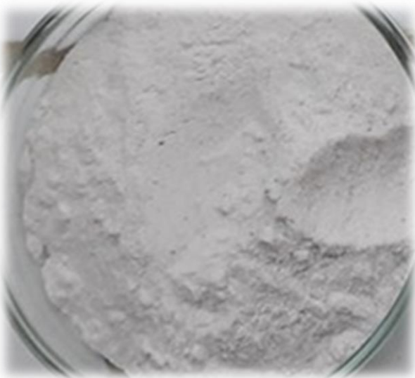
Tamizado el almidón de tunta en una malla de 100 micras
