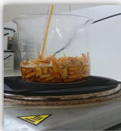
Preparación para la extracción de la celulosa
