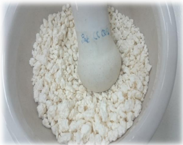
Lavado de la celulosa de tallos de quinua llevando a pH neutro
