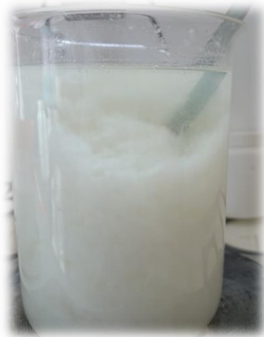
Blanqueado de la celulosa de tallos de quinua
