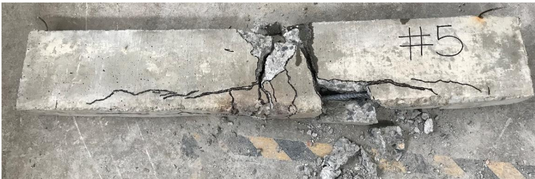
Imagen 54 Falla de la muestra # 5.
