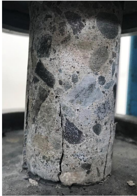
Imagen 33 Falla por compresión de vástago de concreto.
