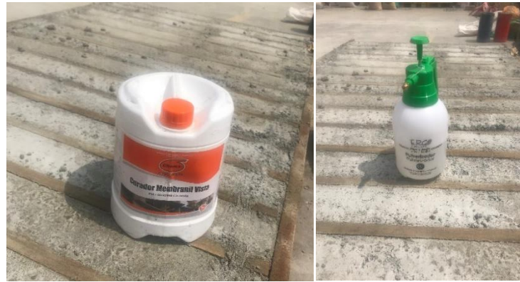
Imagen 14 Curador de concreto Membranil y equipo de pulverización manual.
