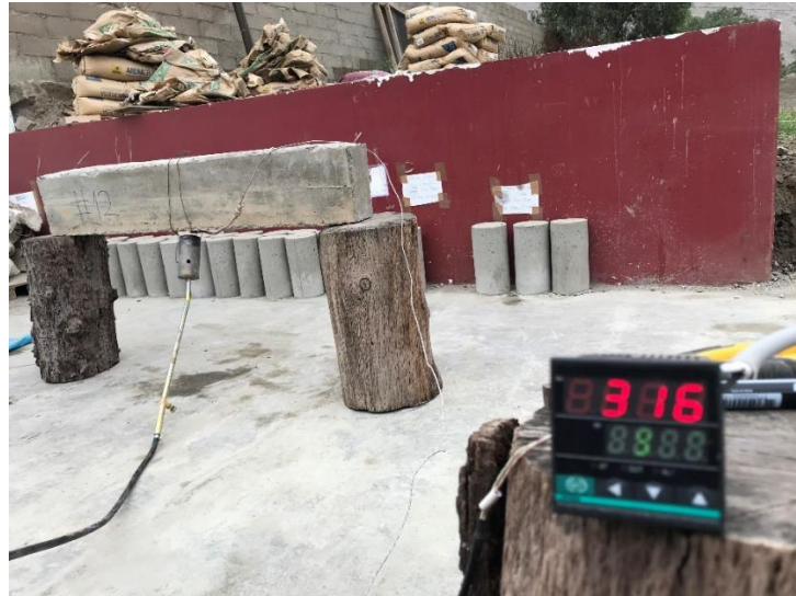
Imagen 18 Quemado a 300 °C de viga #12.
