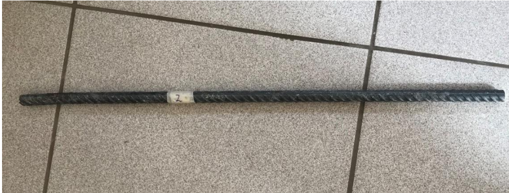
Imagen 39 Varilla # 2 diámetro nominal \frac{1}{2} " de 50 cm de largo.
