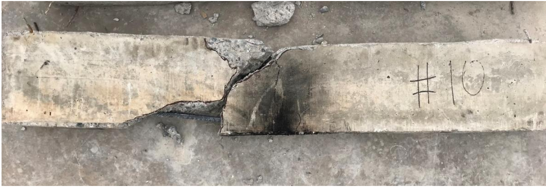
Imagen 49 Falla de la muestra # 10.
