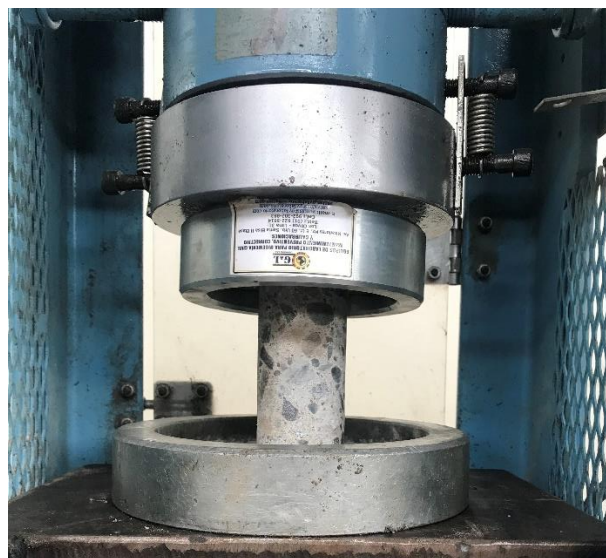
Imagen 38 Vástago de concreto sometido a ensayo de compresión ASTM C-39.
