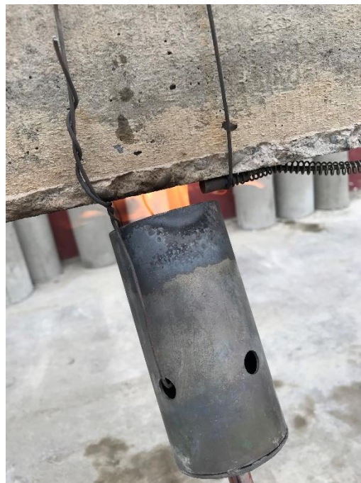
Imagen 19 soplete del GLP y termocupla tipo J.
