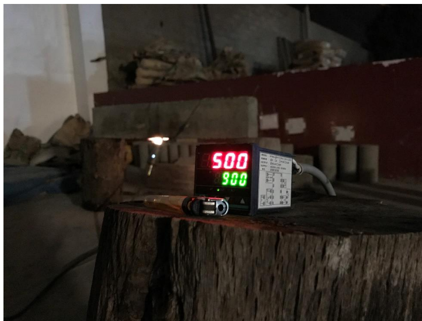
Imagen 20 Quemado a 500 °C de la viga #8.
