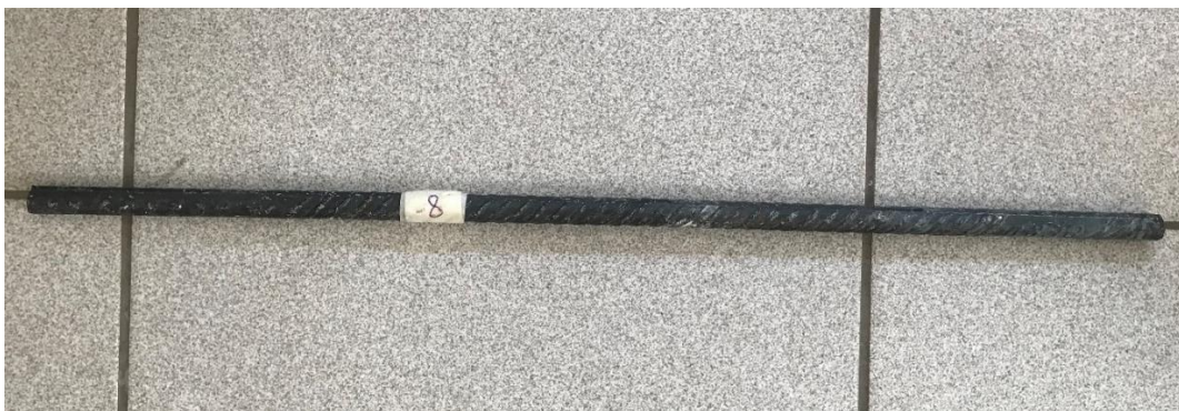
Imagen 41 Varilla # 8 de \frac{1}{2} " diámetro nominal, 50 cm de largo y 500^{\circ}\text{C} de exposición de recubrimiento.
