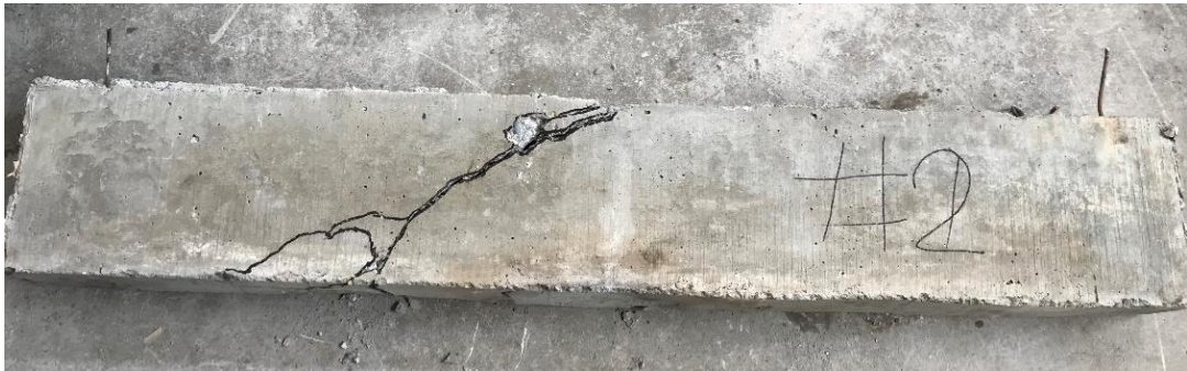
Imagen 57 Falla de la muestra # 2.
