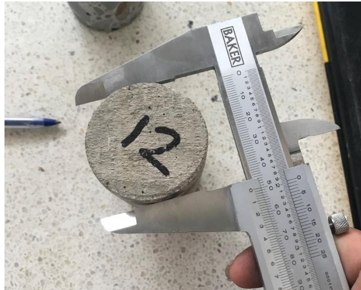
Imagen 31 Toma de medidas de vástago de concreto.
