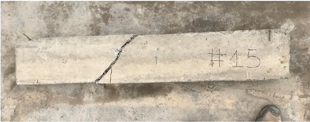
Imagen 47 Falla de la muestra # 15.
