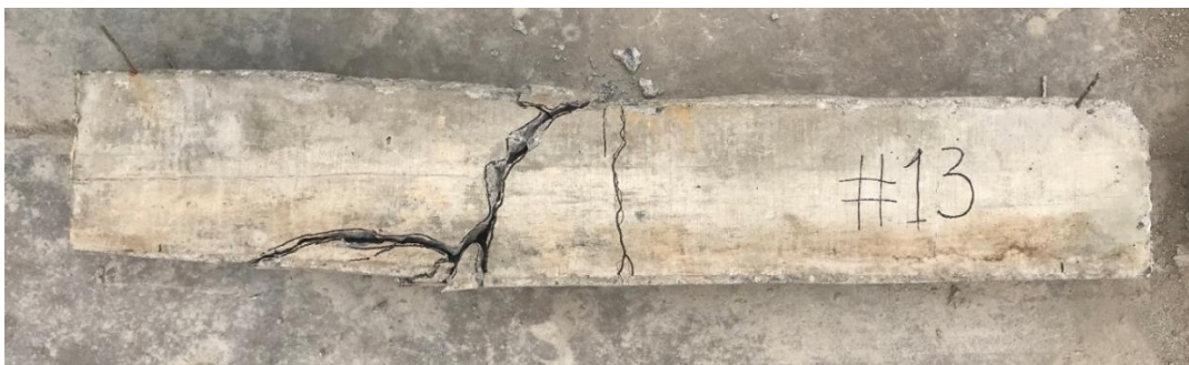
Imagen 45 Falla de la muestra #13.
