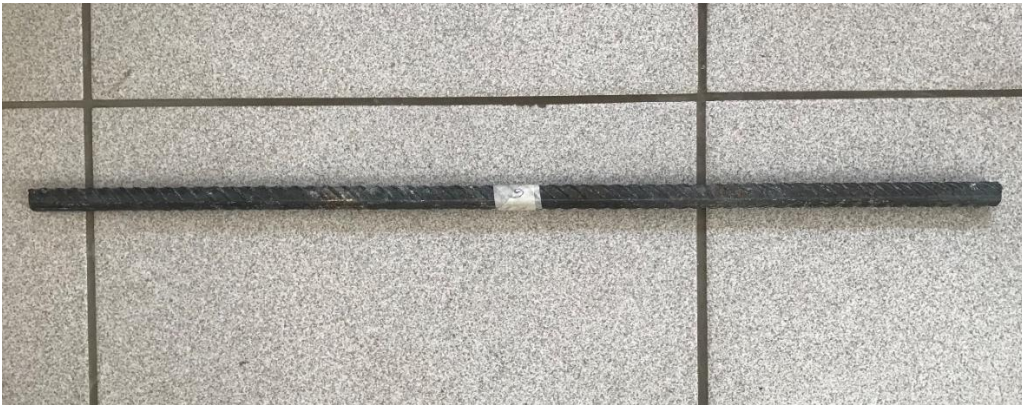
Imagen 40 Varilla # 6 de \frac{1}{2} " diámetro nominal, 50 cm de largo y 700^{\circ}\text{C} de exposición de recubrimiento.
