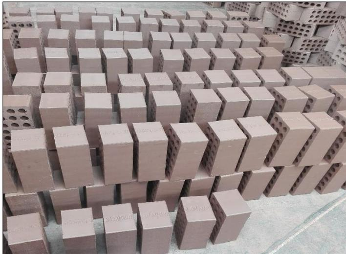
Figura 17. Rumado de ladrillos para su secado.
