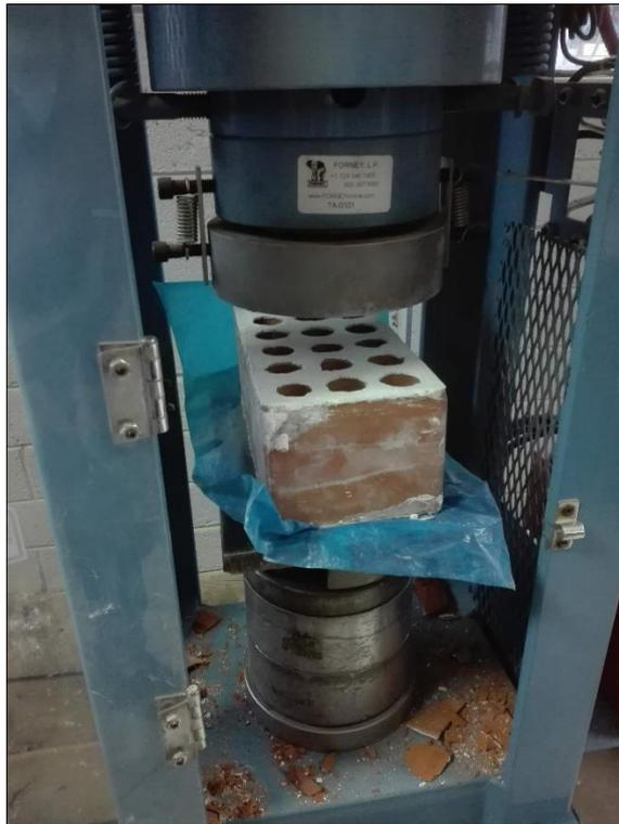
Figura 28. Colocación del espécimen en la máquina de compresión
