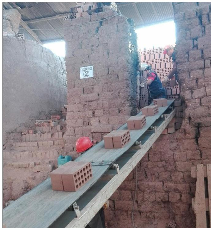
Figura 20. Ladrillos entrando al horno de quemado.
