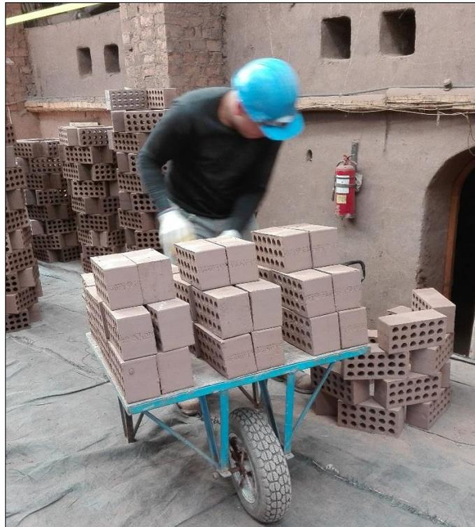
Figura 19. Ladrillo crudo extruido ya seco
