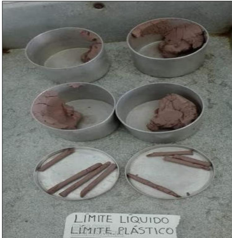
Figura 14. Muestras de suelo para ensayos de límites de consistencia.
