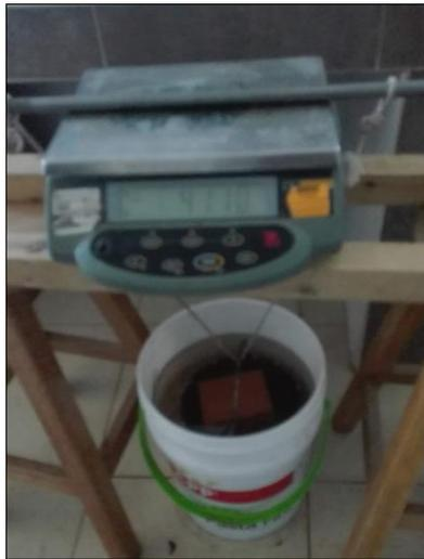
Figura 37. Cálculo del peso sumergido de la muestra
