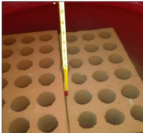
Figura 36. Control de temperatura. (entre los 15 y 30 °C)
