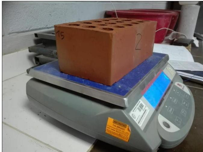
Figura 33. Control del peso del ladrillo saturado.
