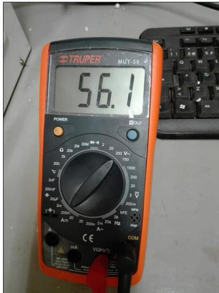
Figura 45. Multímetro midiendo el voltaje a suministrar del regulador a la placa caliente
