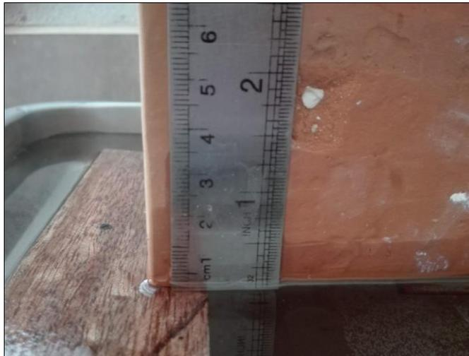
Figura 32. Control del nivel del agua
