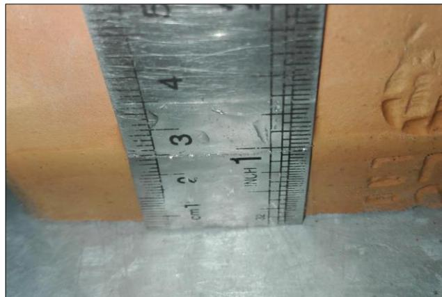
Figura 38. Espécimen sumergido a 25 mm.
