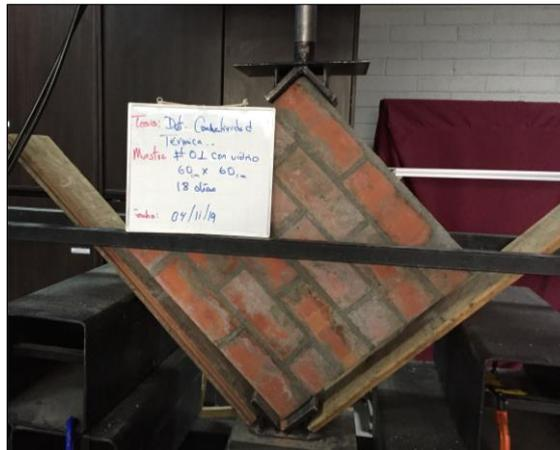
Figura 42. Murete para ser ensayado.
