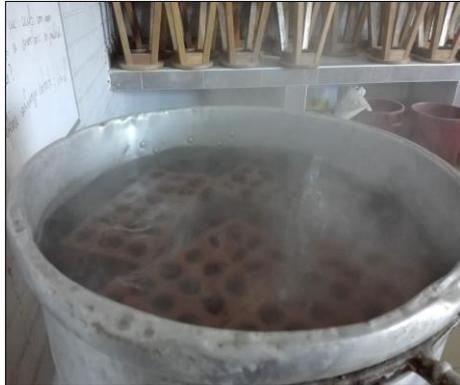
Figura 35. Ensayo de absorción máxima
