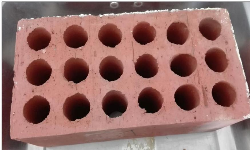
Figura 39. Espécimen DM30 con eflorescencia en los bordes.
