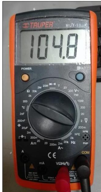
Figura 44. Multímetro midiendo la resistencia de la placa caliente
