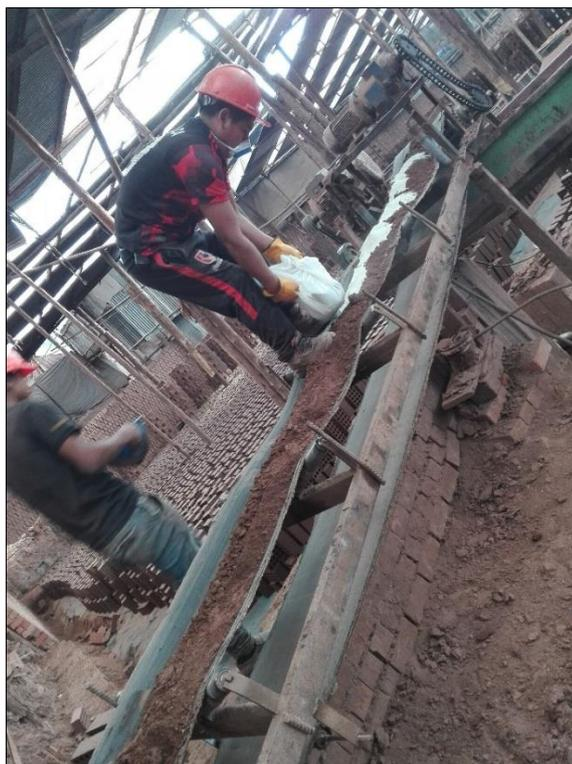
Figura 23. Distribución del polvo de vidrio en la faja transportadora
