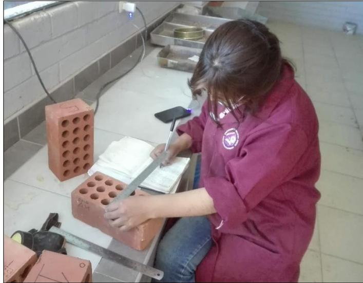
Figura 24. Medición de las dimensiones del ladrillo
