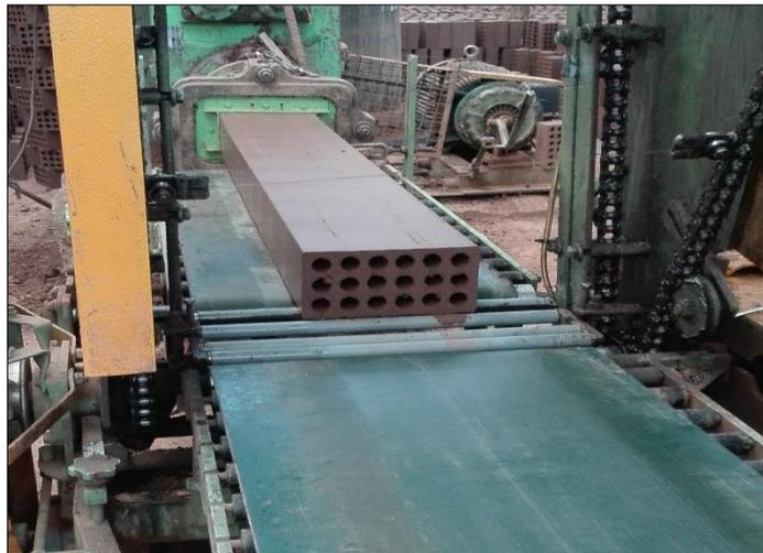
Figura 16. Bloque de ladrillos saliendo de la maquina extrusora
