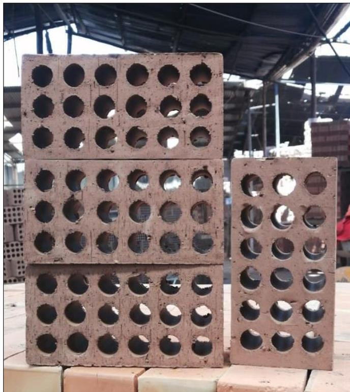
Figura 18. Muestra seca de cada diseño de mezcla
