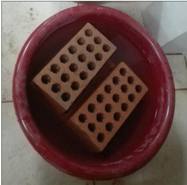
Figura 34. Especímenes sumergidos por 24 horas.
