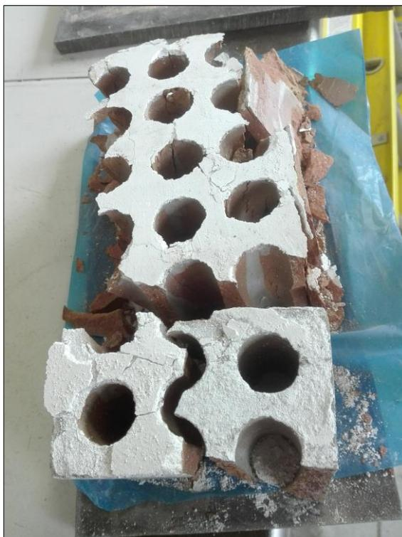
Figura 29. Espécimen ensayado por la máquina de compresión
