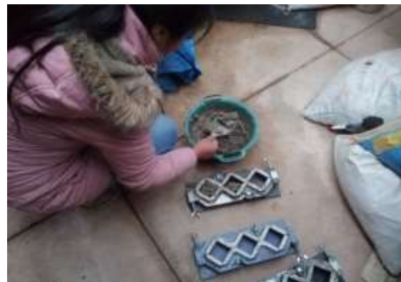
Fotografía 4 Colado de mezcla en moldes
