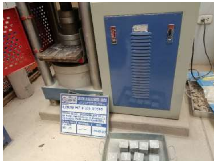
Fotografía 6 Ensayo de Resistencia a la Compresión – Laboratorio Geo Control Total.
