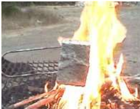
Figura 5. Bloque de papercrete a prueba de fuego.
