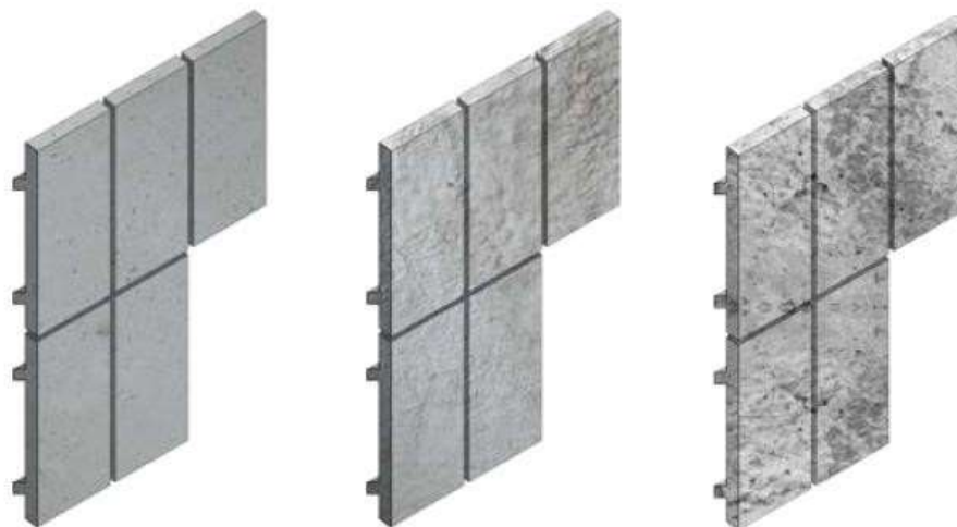
Figura 10. Paredes de papercrete.
