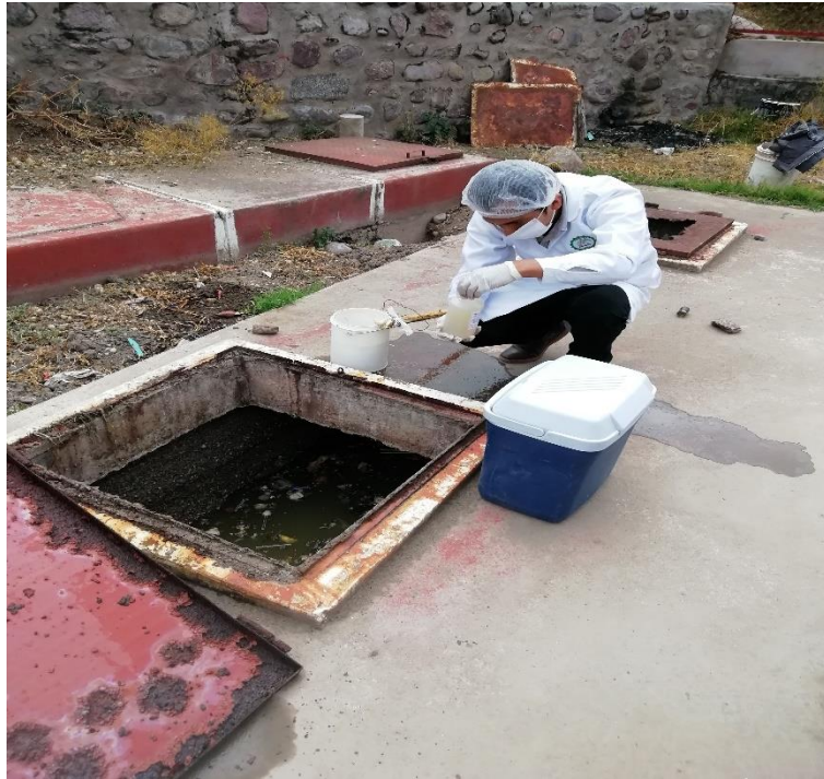
Figura 16. Toma de muestra del agua residual doméstica
