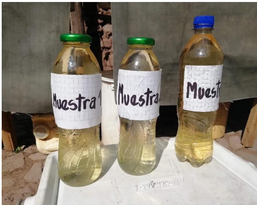
Figura 25. Coloración del agua residual después del tratamiento en el lombrifiltro
