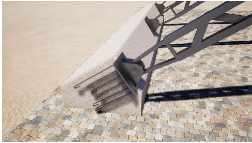
Figura 142. Base de hormigón armado que asegura el anclaje de los arcos de segundo tipo. Fuente propia.
