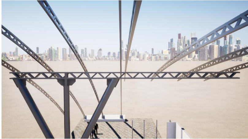
Figura 139. Cercha longitudinal, asegura los arcos que sostienen la cobertura. Fuente propia.
