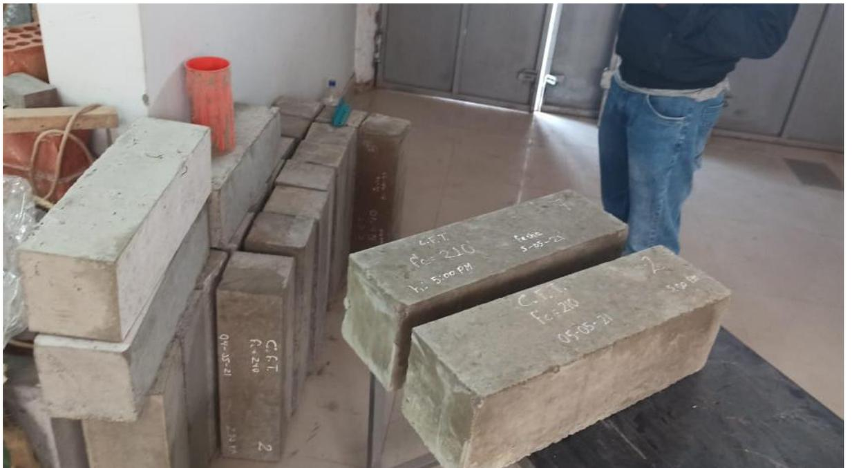
**Fotografía 26.** Se observan las vigas elaboradas y ensayadas a flexion en el laboratorio Geocontrol Total.
