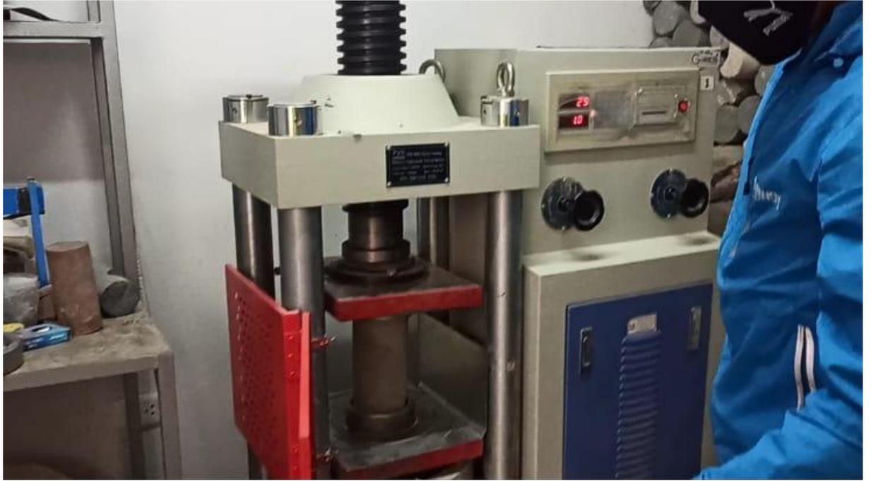
**Fotografía 25.** Ensayo a compresion de briquetas, resistencia a compresion  $F'_c=280\text{kg/cm}^2$ , ensayo a 24 horas de fraguado.
