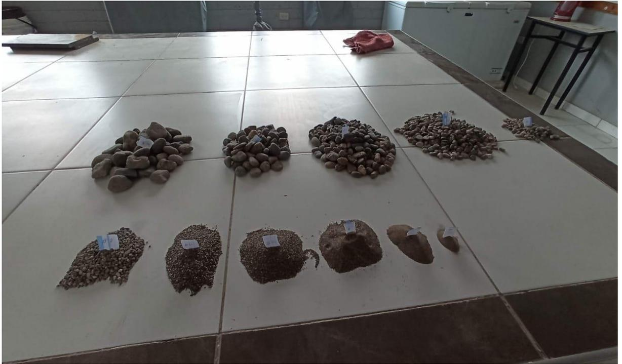
**Fotografía 03.** Ensayo de granulometría.
