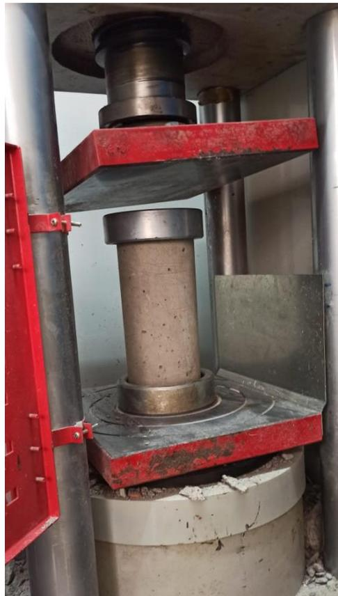
**Fotografia 24.** Ensayo a compresion de briquetas, resistencia a compresion  $F'c=240\text{kg/cm}^2$ , ensayo a 24 horas de fraguado.
