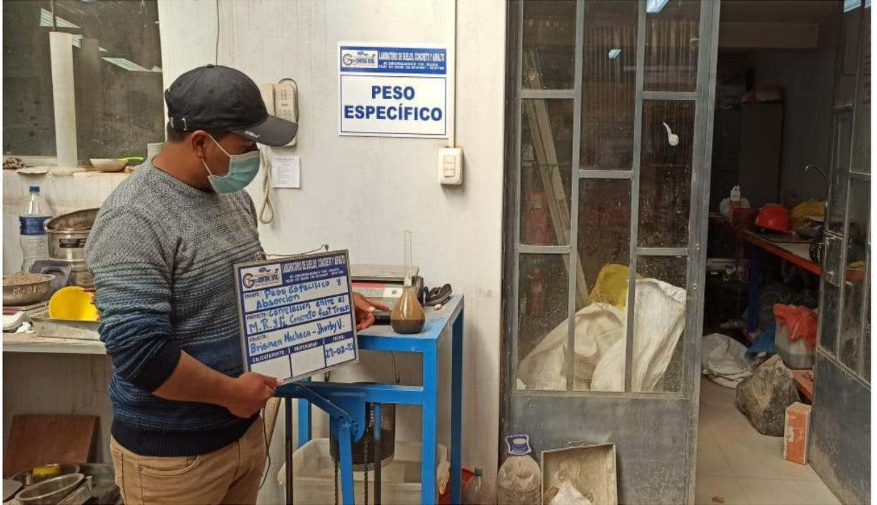
**Fotografía 05.** Ensayo de peso específico y absorción.
