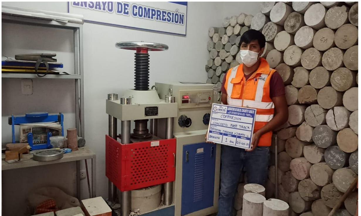
**Fotografia 23.** Ensayo a compresion de briquetas, resistencia a compresion  $F'c=210\text{kg/cm}^2$ , ensayo a 24 horas de fraguado.
