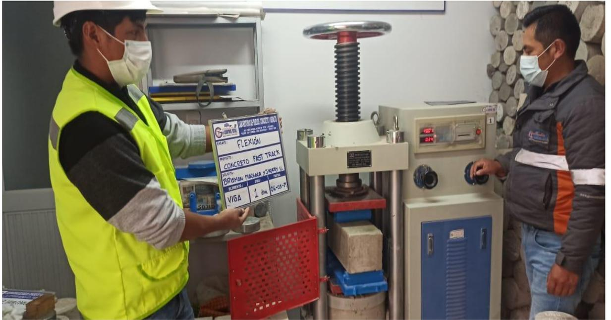
**Fotografía 19.** Ensayo a flexion de la viga resistencia de diseño del concreto  $f'_c=280$  kg/cm<sup>2</sup>.
