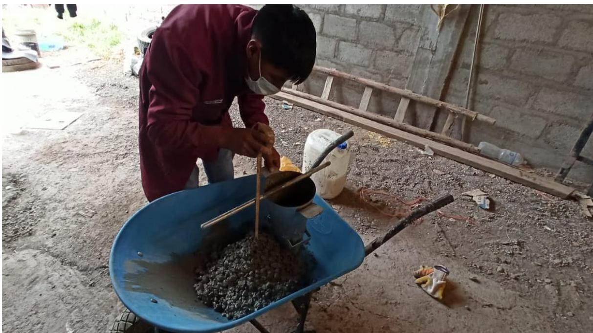
**Fotografía 11.** Ensayo de asentamiento slump.
