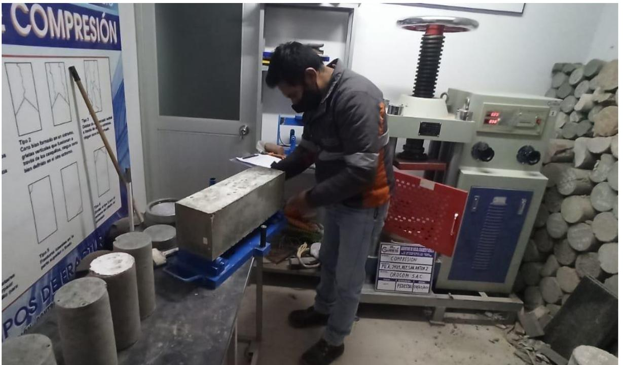
**Fotografía 16.** Control de medidas de la viga a ensayar.
