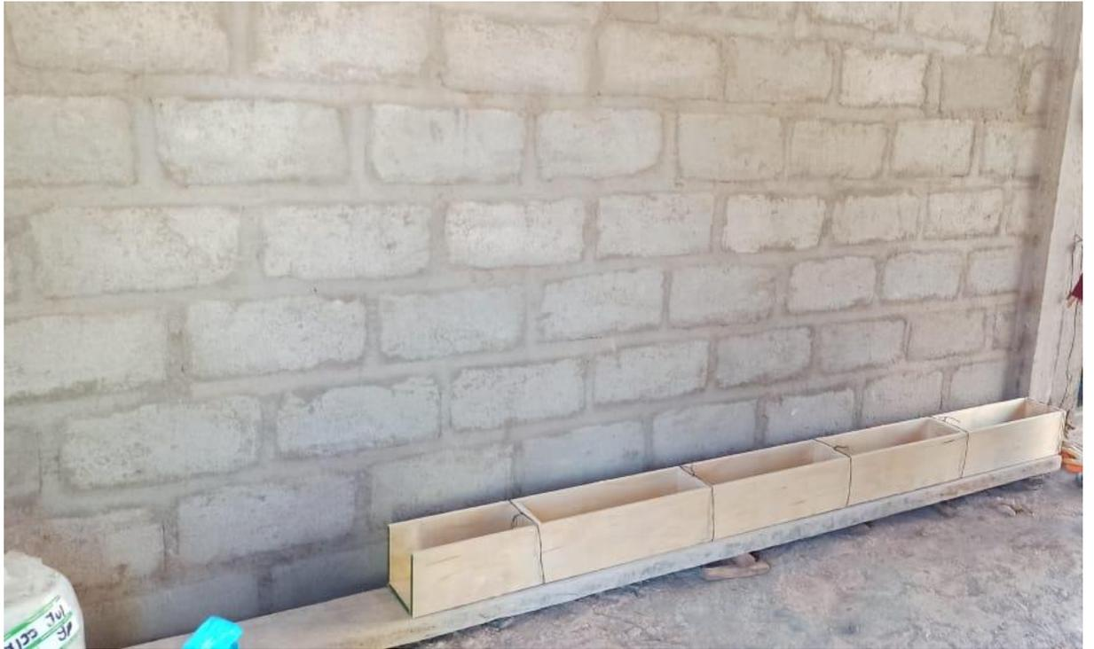
**Fotografía 09.** Encofrado para vigas de dimensiones 15cm X 15cm X 51cm.
