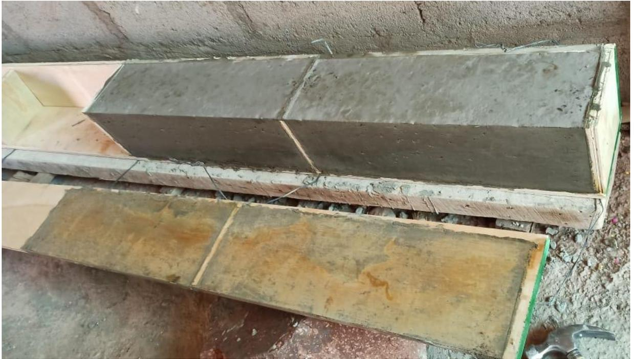
**Fotografía 15.** Desencofrado de los moldes de vigas 15cmX15cmX51cm.
