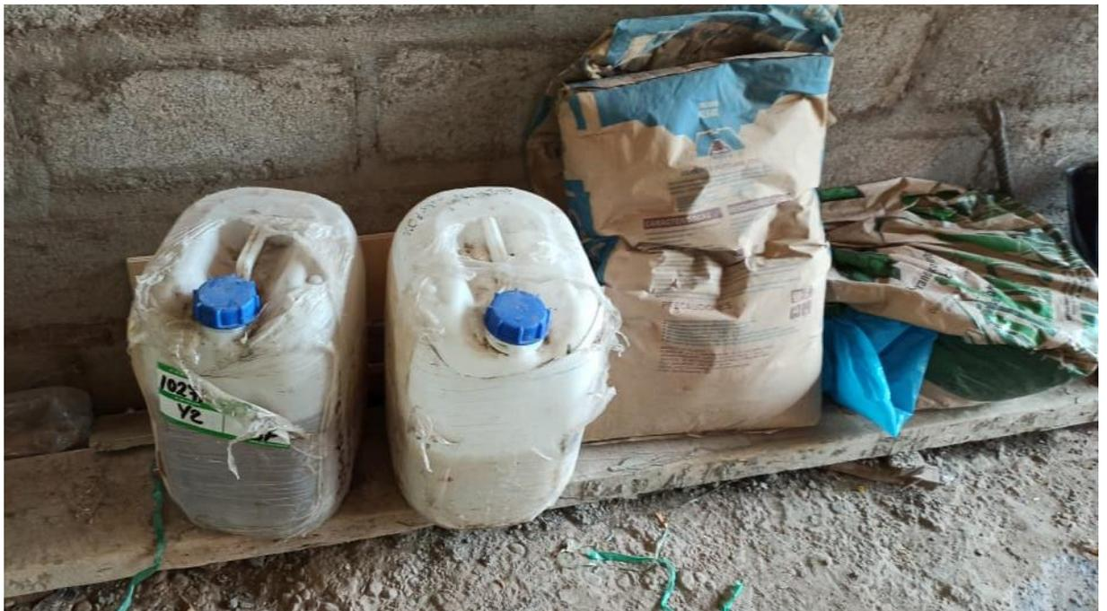
**Fotografía 27.** Se observan los aditivos empleados en la investigacion, MasterGleium (aditivo reductor de agua de alto rango para concreto) y MasterSeed (aditivo acelenrante de fragua para concreto).
