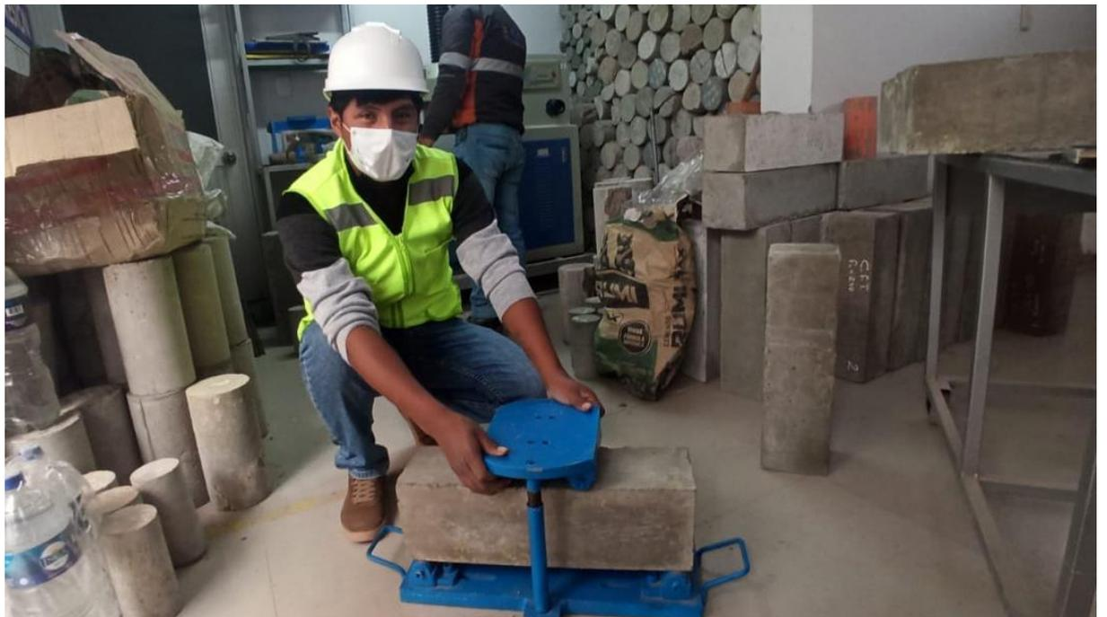
**Fotografía 20.** Se aprecia en la imagen el equipo que se usó para realizar el ensayo a flexión en vigas.
