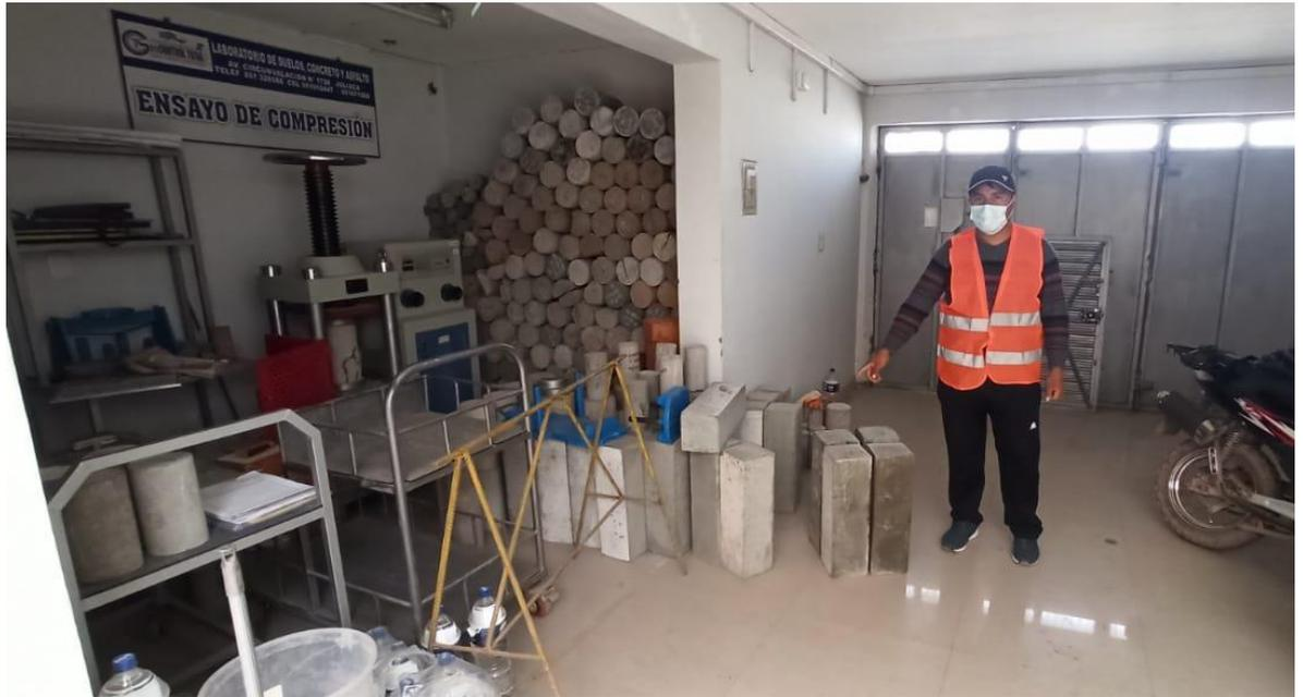
**Fotografía 27.** Se observan las briquetas y vigas, que se ensayaron a compresion y flexion en el laboratorio Geocontrol Total.
