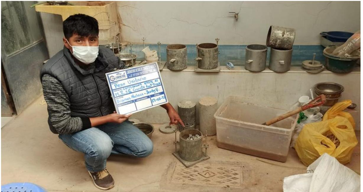
**Fotografía 04.** Ensayo de peso unitario.
