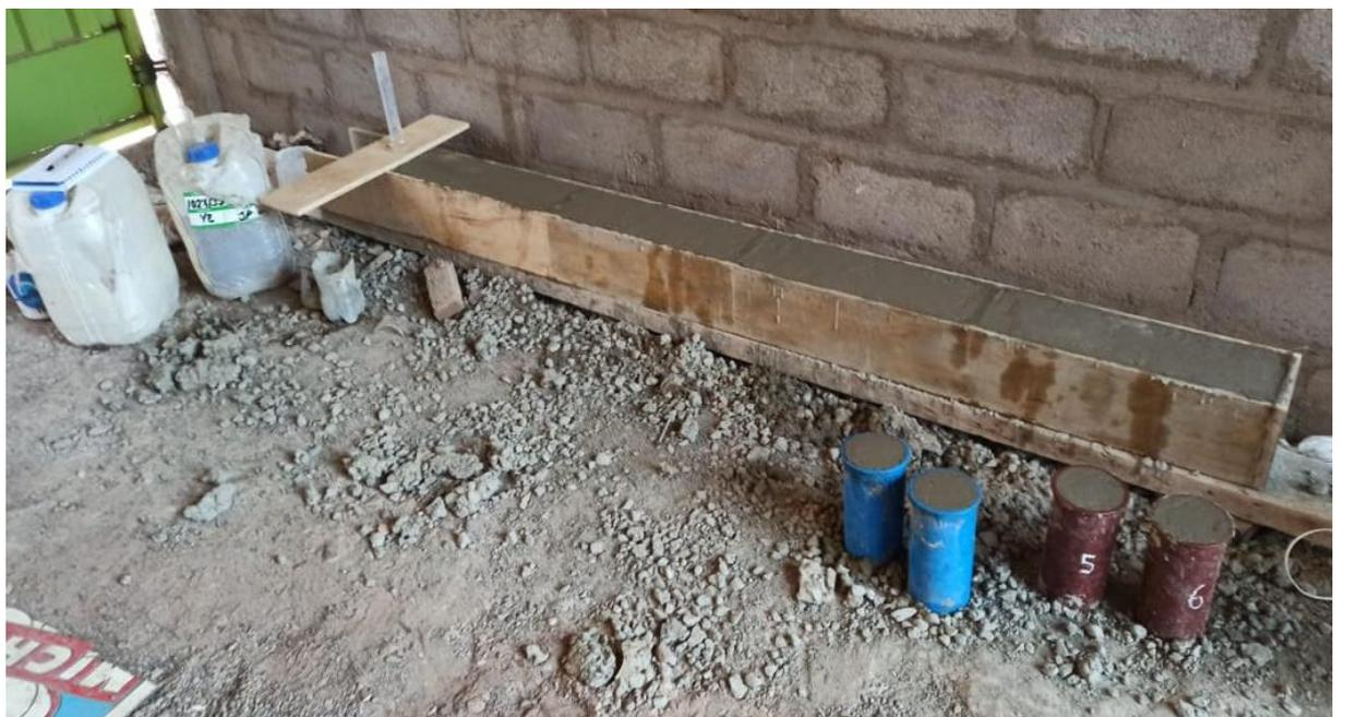
**Fotografía 14.** Se observa las vigas y briquetas en sus respectivos moldes.
