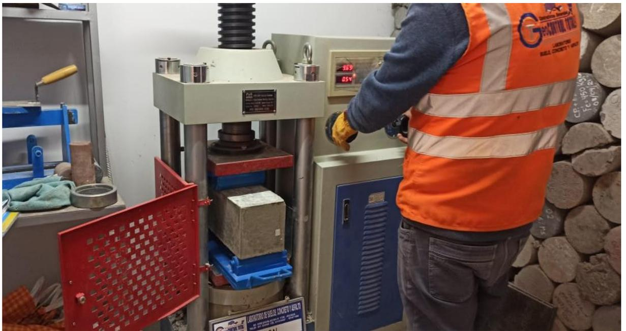
**Fotografía 18.** Ensayo a flexion de la viga resistencia de diseño del concreto  $f'_c=240$  kg/cm<sup>2</sup>.
