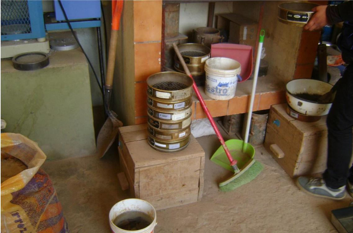
*Figura 11: Tamizado de la selección de dos cuartas de muestra desintegrada de la primera sección de muestra (progresiva 00+000m a 00+200m). Fuente: Elaboración propia*
