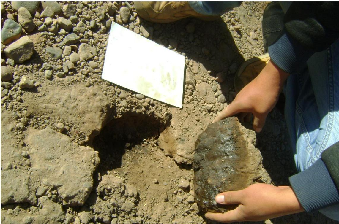
*Figura 8: Extracción manual de muestra de la primera sección de muestra (progresiva 00+000m a 00+200m). Fuente: Elaboración propia*
