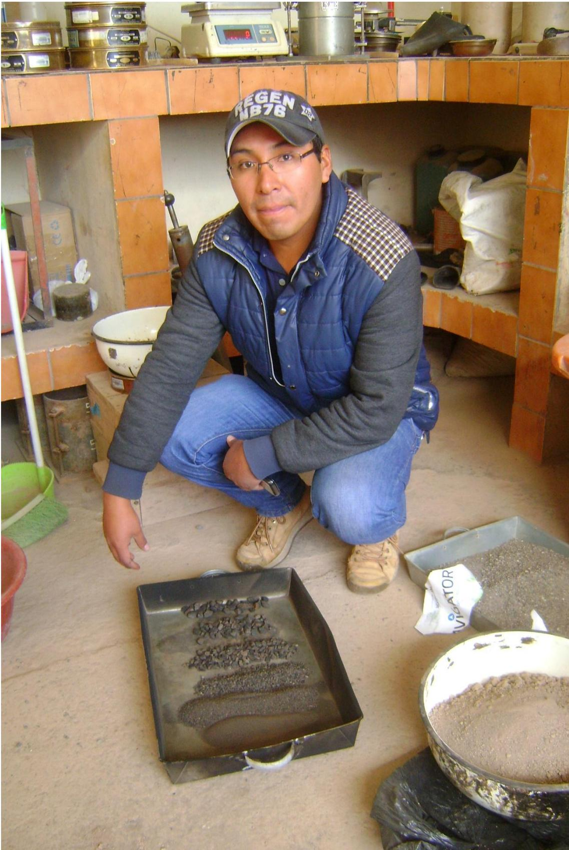
*Figura 14: Composición de agregados de la muestra de asfalto de la primera sección de muestra (progresiva 00+000m a 00+200m). Fuente: Elaboración propia*
