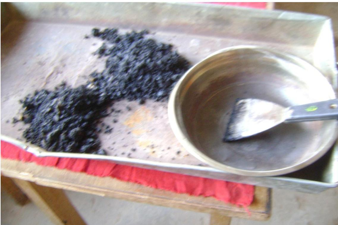
*Figura 9: Selección de dos cuartas de muestra desintegrada de la primera sección de muestra (progresiva 00+000m a 00+200m). Fuente: Elaboración propia*
