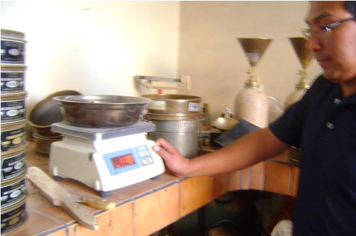
*Figura 9: Pesado de la selección de dos cuartas de muestra desintegrada de la primera sección de muestra (progresiva 00+000m a 00+200m). Fuente: Elaboración propia*
