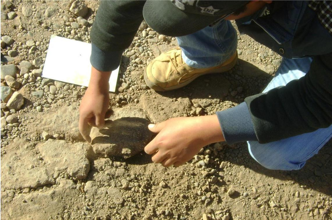
*Figura 7: Extracción manual de muestra de la primera sección de muestra (progresiva 00+000m a 00+200m). Fuente: Elaboración propia*
