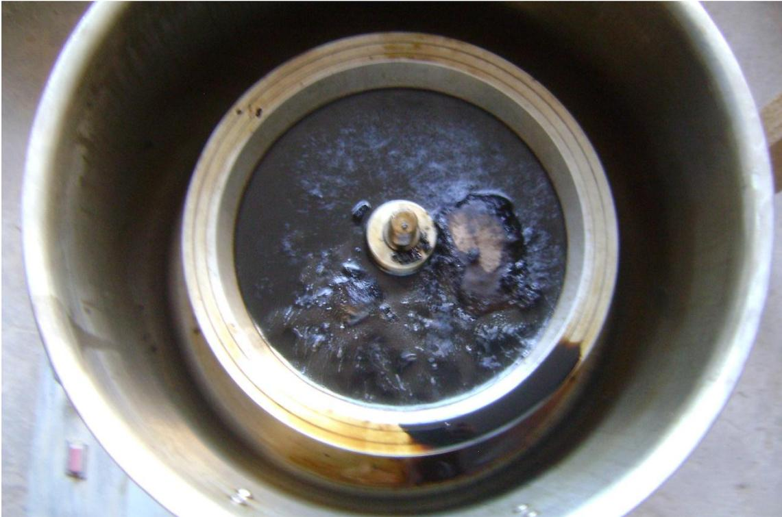
*Figura 13: Lavado asfáltico de la selección de dos cuartas de muestra desintegrada de la primera sección de muestra (progresiva 00+000m a 00+200m). Fuente: Elaboración propia*
