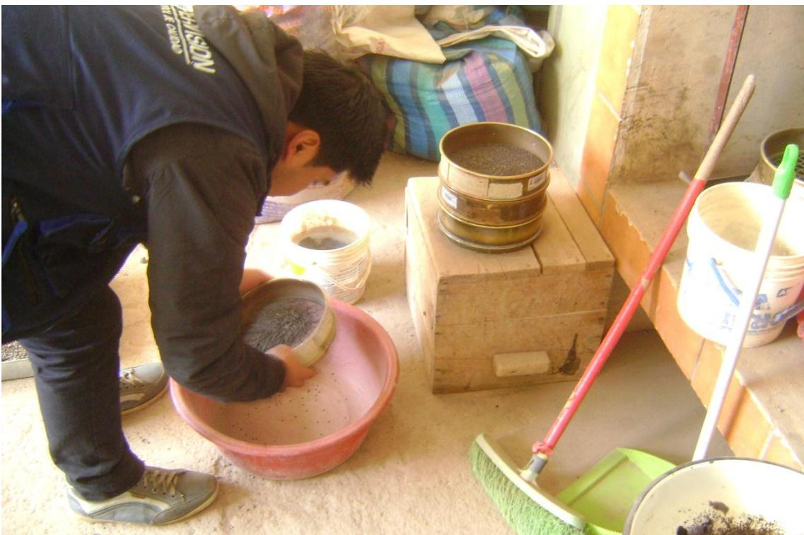
*Figura 10: Tamizado de la selección de dos cuartas de muestra desintegrada de la primera sección de muestra (progresiva 00+000m a 00+200m). Fuente: Elaboración propia*
