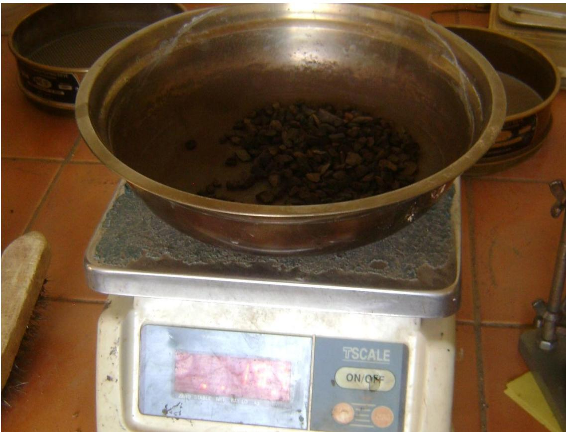
*Figura 12: Pesado por tamiz de la selección de dos cuartas de muestra desintegrada de la primera sección de muestra (progresiva 00+000m a 00+200m). Fuente: Elaboración propia*
