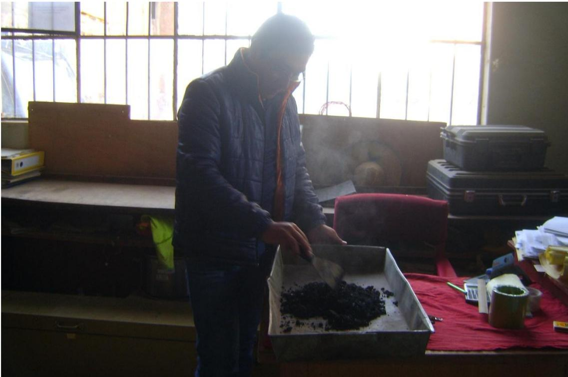
*Figura 9: Cuarteo de muestra desintegrada de la primera sección de muestra (progresiva 00+000m a 00+200m). Fuente: Elaboración propia*
