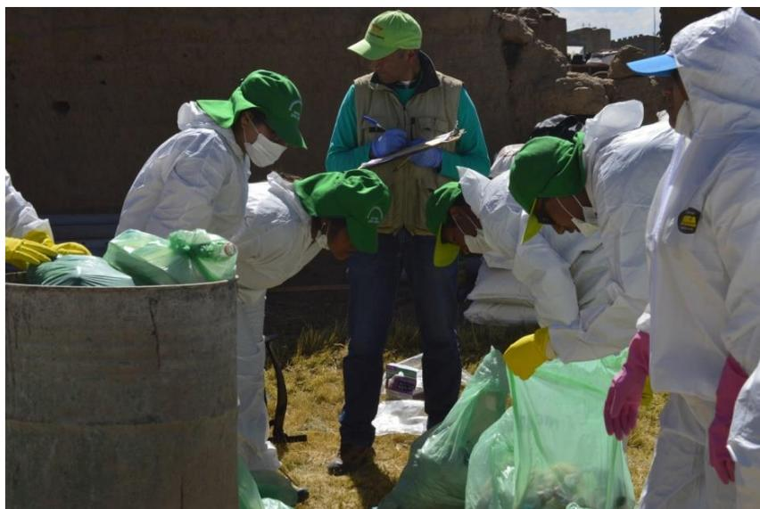
**3.3.3.1. Determinación de la densidad:** Para la determinación de la densidad de los residuos sólidos domiciliarios, se acondicionó un cilindro metálico de volumen definido, en el cual, se colocó la muestra, hasta llenar el cilindro o tener una altura libre. Una vez llenado el cilindro, se levantó unos 10 cm. sobre el suelo y se dejó caer tres veces, para uniformizar la muestra. Se calculó la densidad de los residuos sueltos con la siguiente ecuación.
