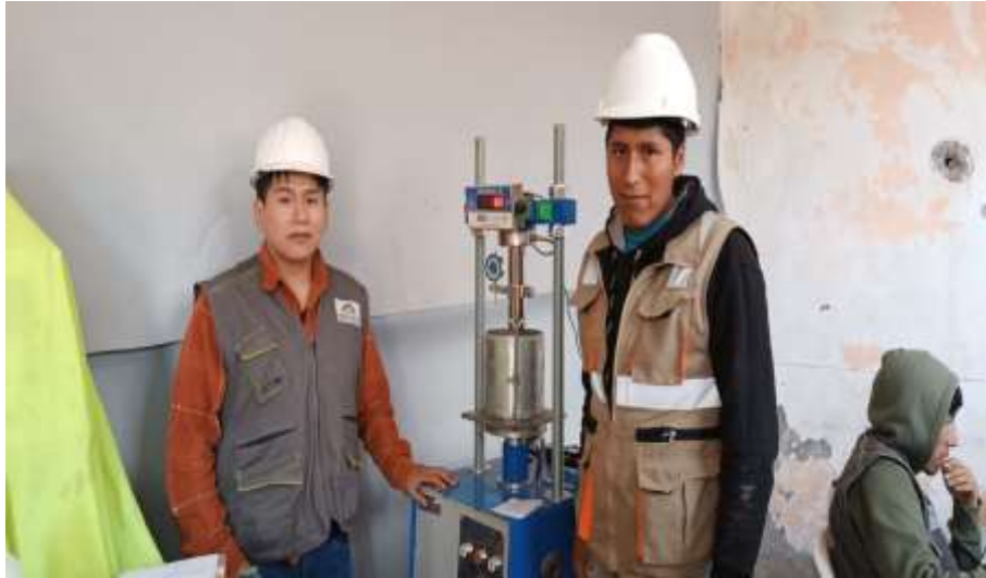
Figura 16. Se visualiza la lectura de expansiones en las muestras.
