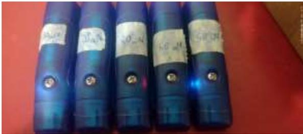
**Figura 3.** Acelerómetros X16 - 1D.
