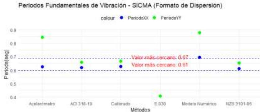
Fig. 6. Valores de T(s) para diferentes metodologías de análisis sísmico en edificio SICMA.
