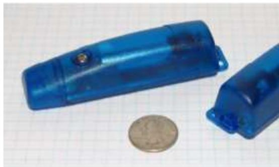
Fig. 2. Acelerómetro X 16-1D
