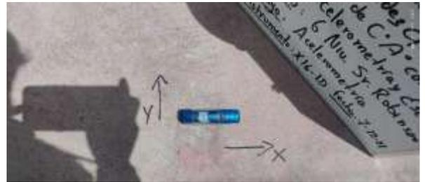
**Figura 4.** Dirección local de acelerómetros.
