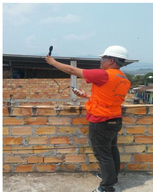
Figura 20. Monitoreo de parámetros meteorológicos de dirección y velocidad del viento
