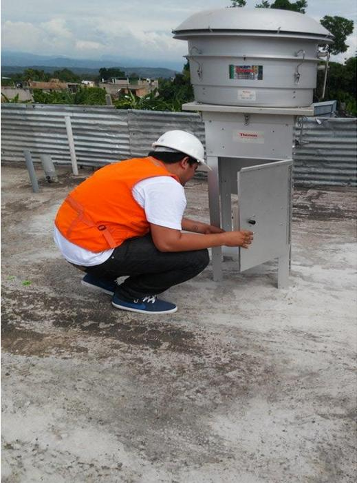
Figura 19. Monitoreo de calidad de aire con el Hivol PM 2.5
