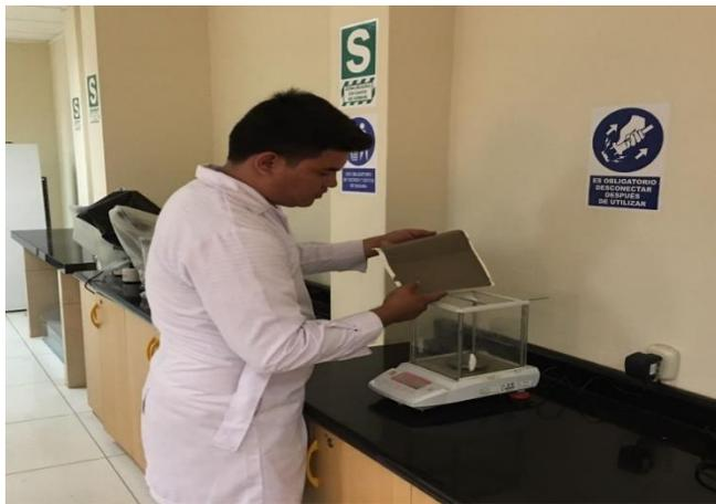
Figura 25. Pesado del filtro en la balanza analítica
