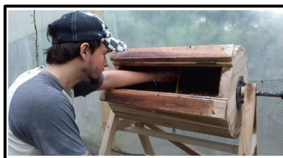
Figura 2- Fermentador Madera Tambor Giratorio.
