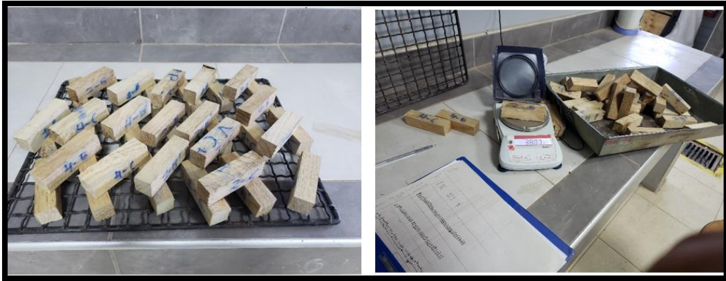
Figura 18. Probetas secas después de haber obtenido un peso constante para el respectivo pesado en la balanza.
