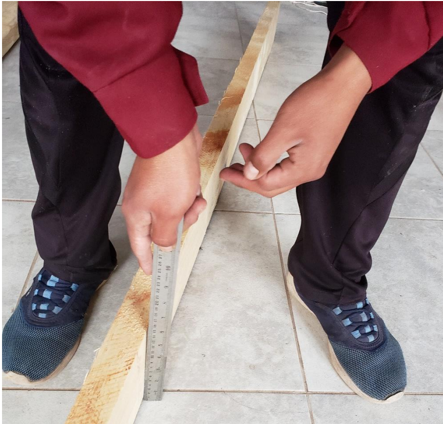
Fotografía 7. Replanteo de la medición de las secciones de las muestras a ensayar.
