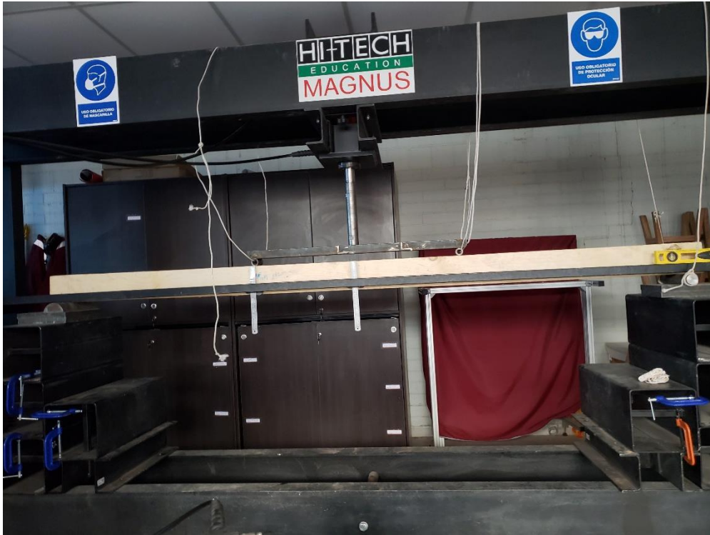
Fotografía 9. Viga listo para el sometido de las cargas.
