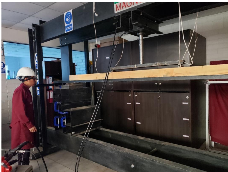
Fotografía 8. Verificación de la viga a ensayar.
