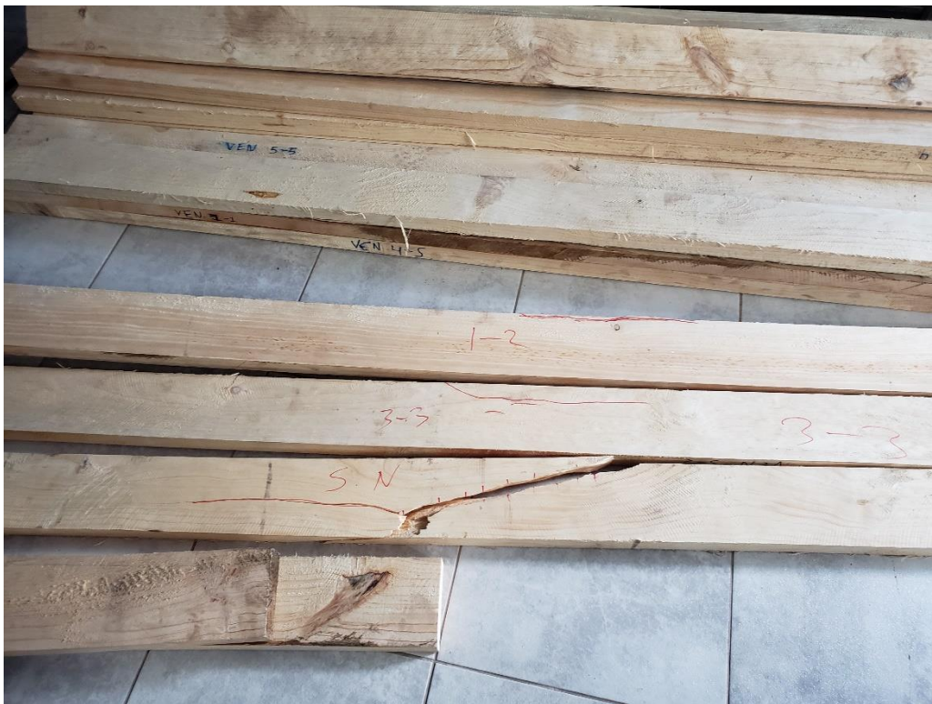
Fotografía 10. Las fallas de las vigas ensayadas a flexión
