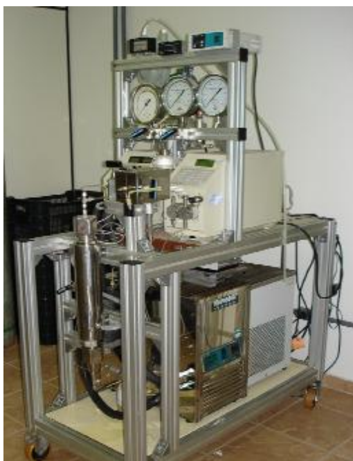
Figura 6 Unidad de extracción supercrítica SFE_I
