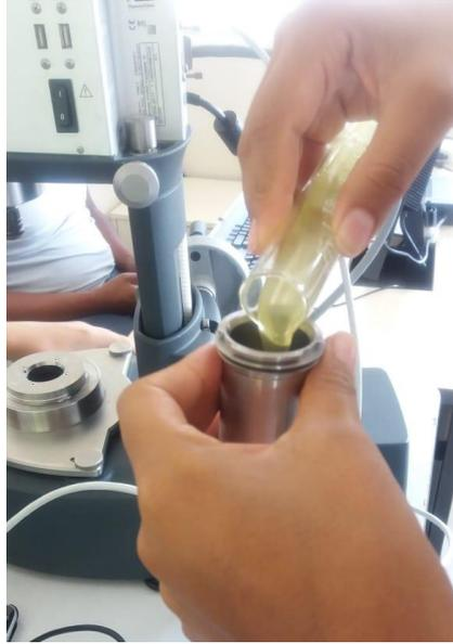
Figura 35. Adición de la muestra de pulpa de sanky en el cilindro del reómetro.
