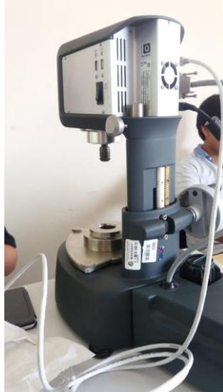
Figura 33. Reómetro rotacional empleado en el análisis de los parámetros reológicos de la pulpa de sanky y aguaymanto.
