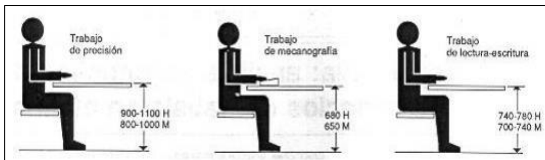
Figura 9. Altura del plano de trabajo para puestos de trabajo sentado.
