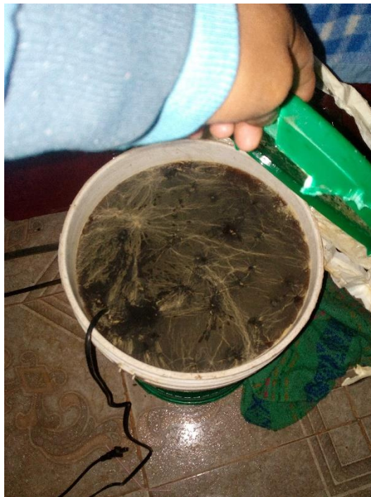
Figura 8. Activación de EM con termostato a 30 °C
