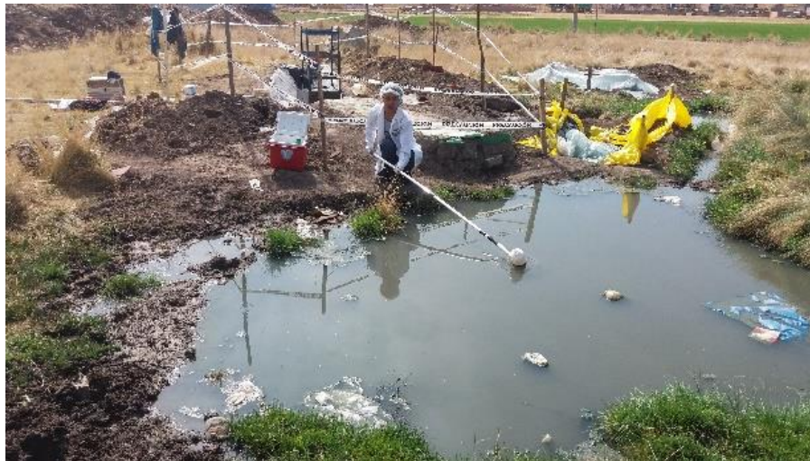
Figura 12. Toma de muestra de la laguna de oxidación
