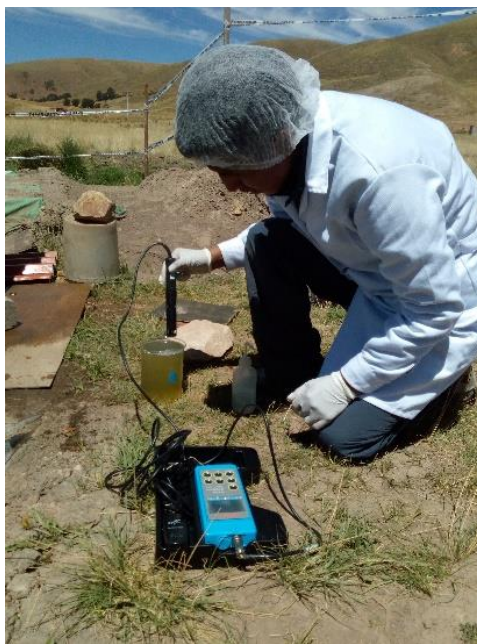
Figura 20. Medición de oxígeno disuelto en sistema de aireación in-situ
