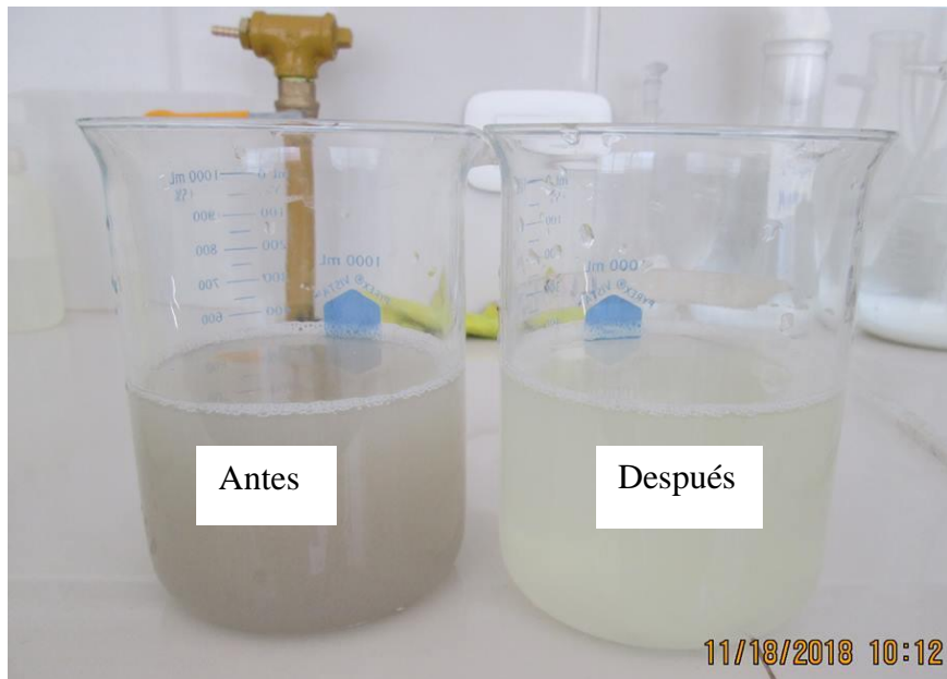
Comparación del agua de curtiembre antes y después del tratamiento (1 hora de sedimentación)
