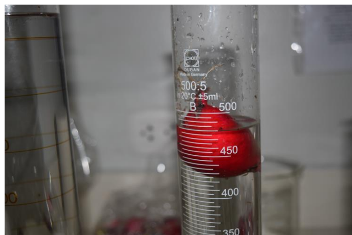
Figura 55. Determinación del volumen de la raíz
