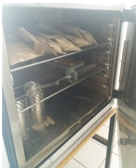
Fotografía 6. Colocación el a estufa a 110 °C por 24 horas.
