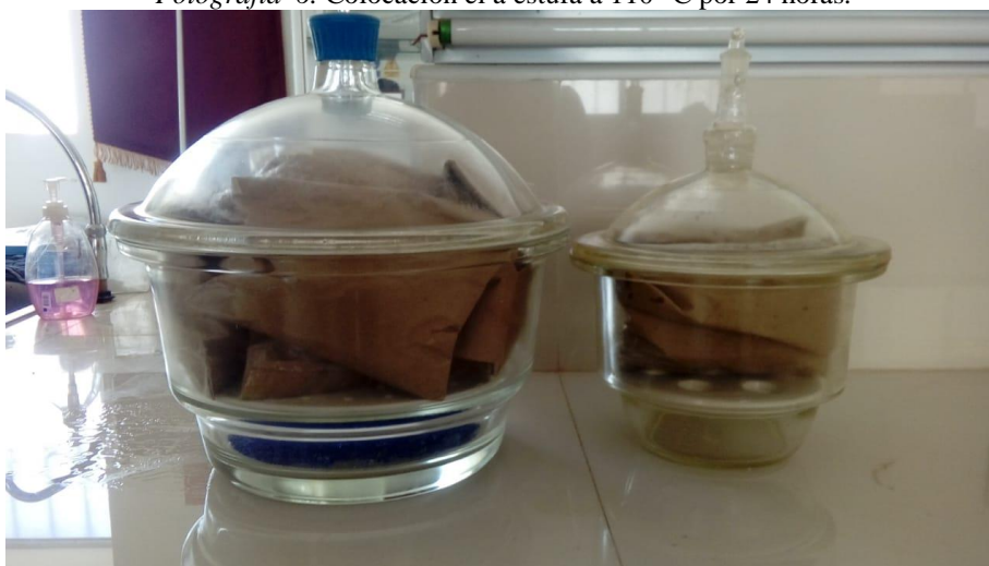
Fotografía 7. Colocación de las muestras de suelo en el desecador
