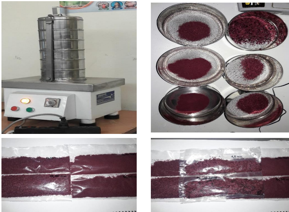
Figura 26 – Tamizado de harina de cáscara de uva.
