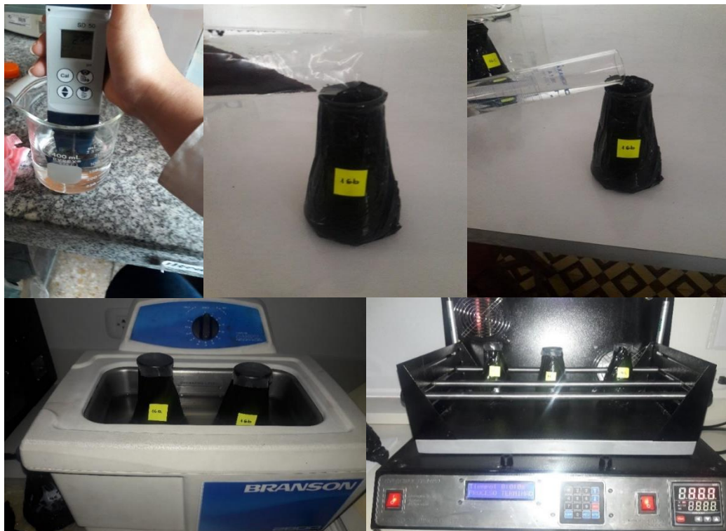
Figura 27 – Extracción de antocianina a partir de harina de cáscara de uva.
