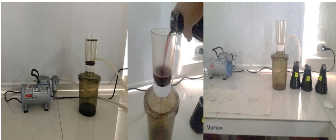
Figura 28 – Filtrado del extracto antociánico a partir de harina de cáscara de uva
