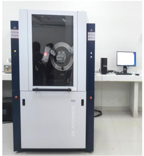
Difracción de rayos X para el análisis de la organoarcilla
