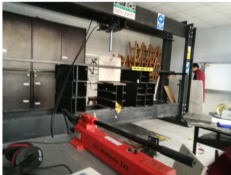
Figura 55. Ensayo de compresión vertical.
