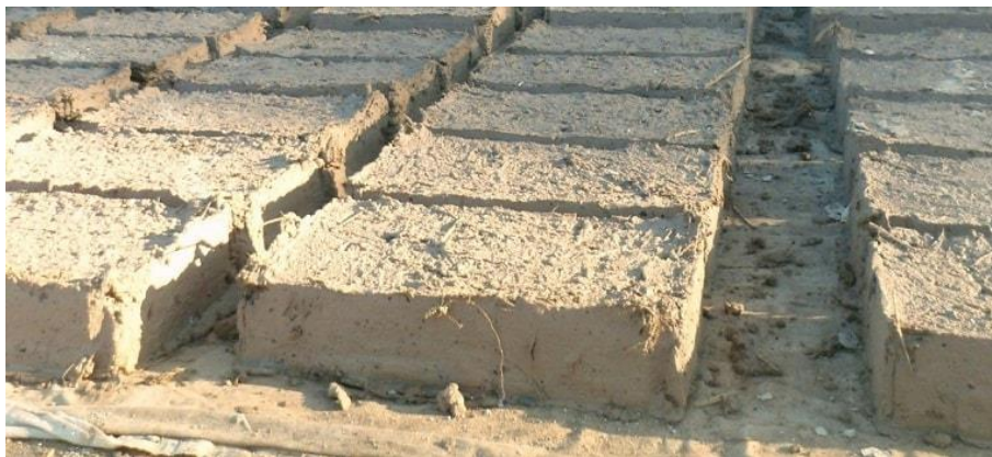
Figura 19. Elaboración de adobes con inclusión de paja.
