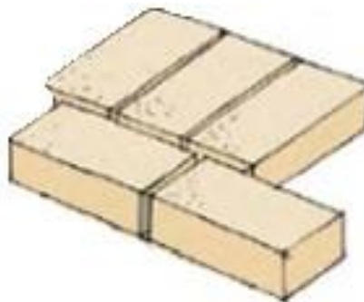
Figura 23. Asentado típico de muros con adobe.
