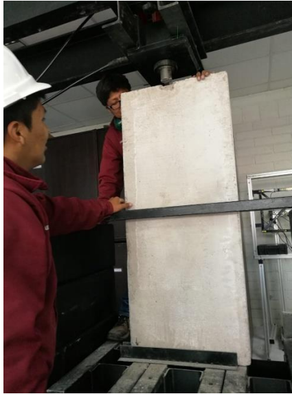
Figura 56. Ensayo del panel de 1.20 m de altura.
