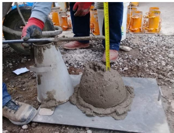
Figura 44. Medida del slump en la mezcla.
