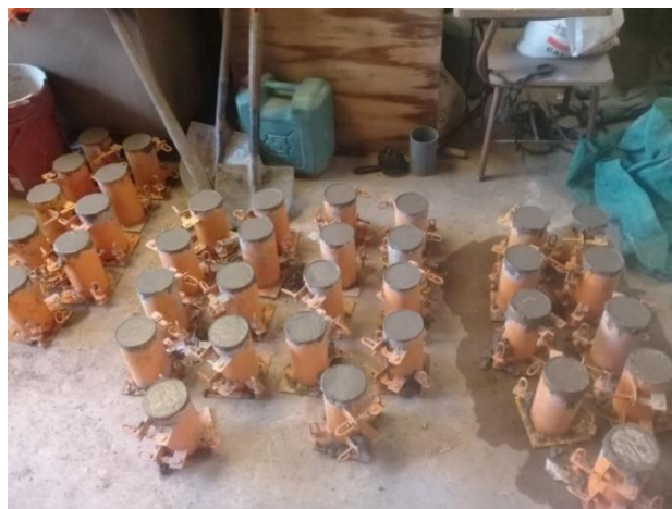
Figura 45. Elaboración de briquetas de concreto.
