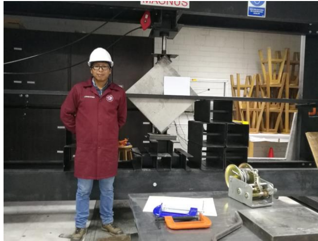
Figura 52. Ensayo de compresión diagonal.
