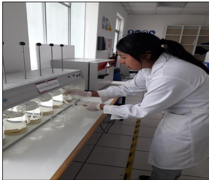
Figura 11. Sacando agua del tratamiento para su análisis.
