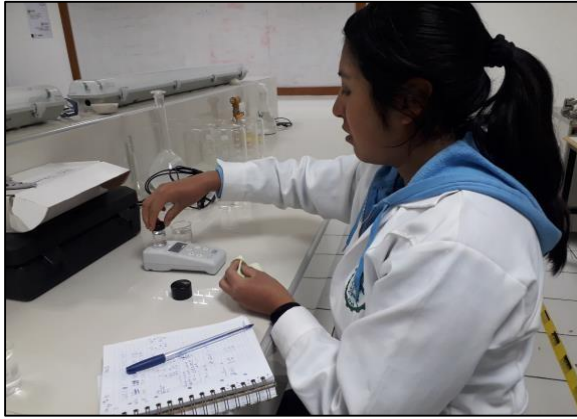
Figura 12. Midiendo la turbiedad del agua tratada.
