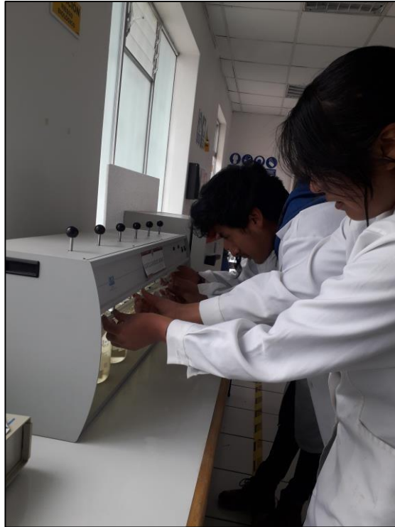
Figura 7. Adicionando la solución de goma de tara al agua a tratar.
