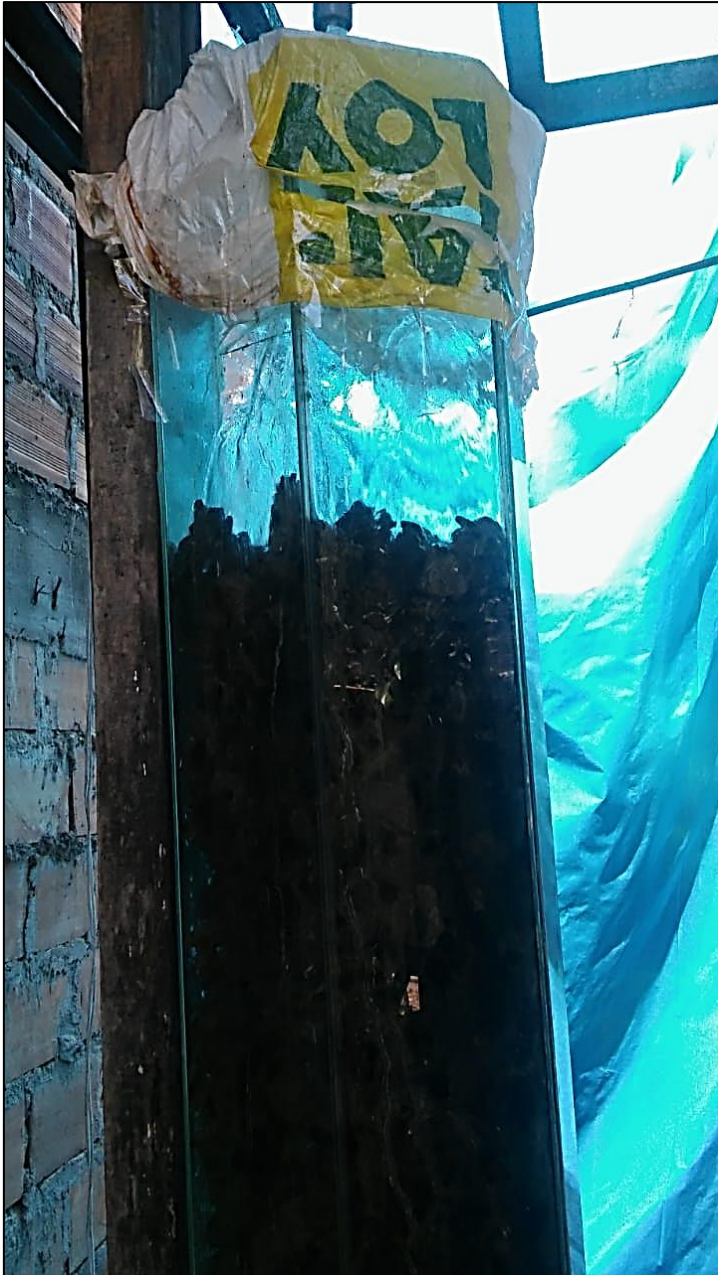
Figura 9. Adición de piedra pómez al filtro
