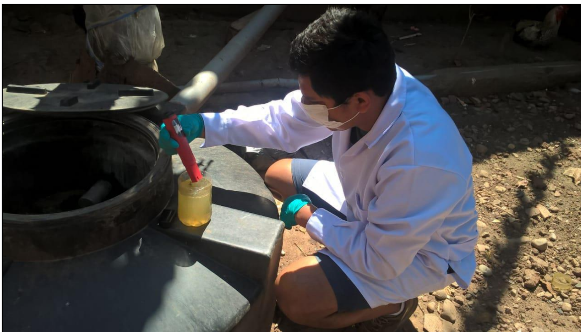
Anexo 7.4 Medición de pH y temperatura del agua residual del biodigester
