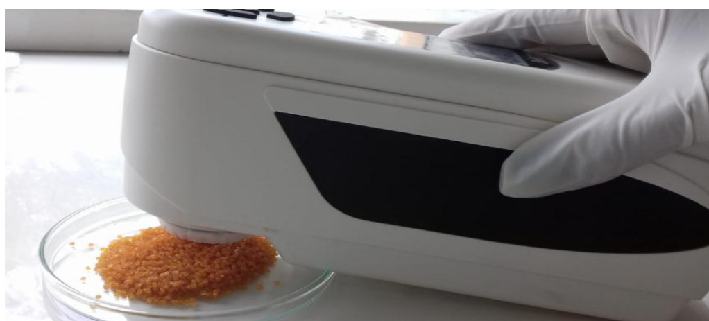
Ilustración 5. Medición de color de cápsulas con colorímetro.
