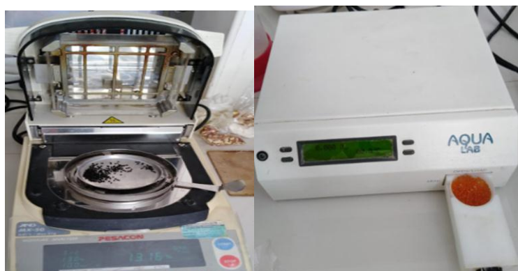
Ilustración 4. Equipos para determinar humedad y Aw.
