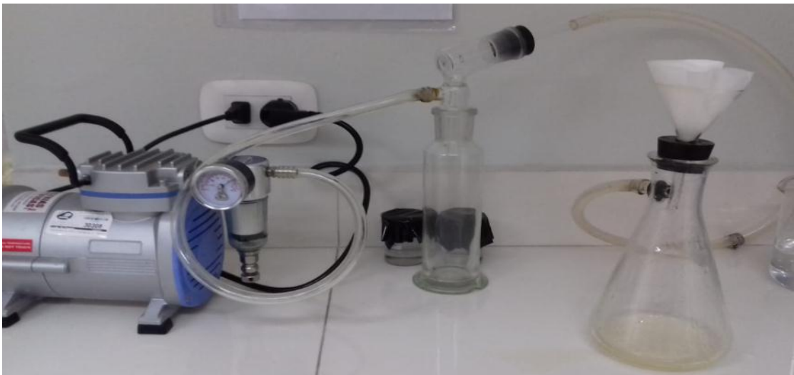
Ilustración 2. Equipo para filtrar el extracto fenólico
